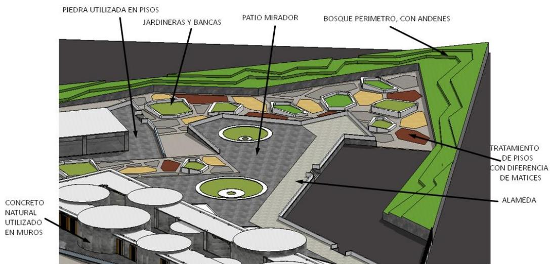
**Figura 42.** Aplicación de diferentes materiales, color y niveles para la integración con el paisaje.
