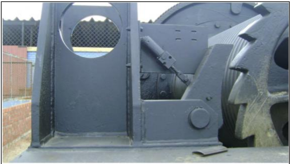
Figura 7. Trinquete y tope trasero en el tambor del winche
