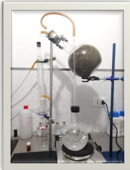
**Figura 6: Equipo para destilación por arrastre de vapor necesario para realizar nuestra investigación**
