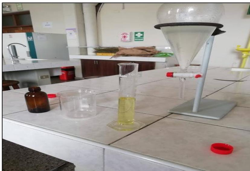
**Foto 4:** Aceite esencial de *Eucalyptus globulus* “Eucalipto”, obtenido mediante método de arrastre de vapor, fue separado en la pera de decantación en sus dos fases inmiscibles (acuosa, oleosa) para luego ser envasado en un frasco ámbar y conservado a temperatura de 4 – 8 °C.
