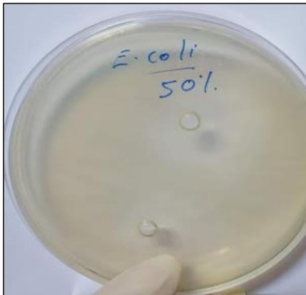
**Foto 14:** Placa Petri que contiene *E. coli* y aceite esencial de *Eucalyptus globulus* “Eucalipto” al 50% como resultado el halo de inhibición midió 27.5mm
