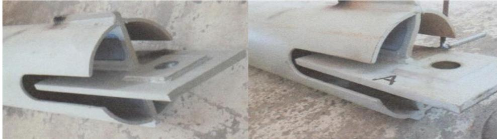
**Figura 9.** Disipador SLB embebido en barra de sección tubular.
