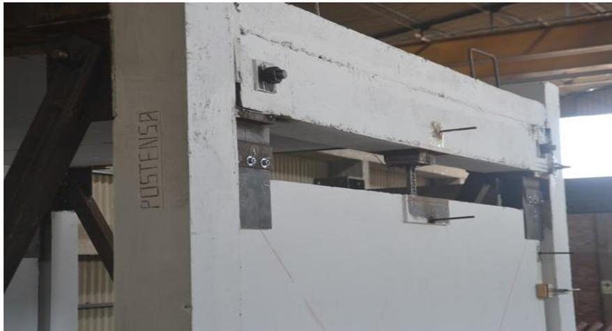
*Figura 14.* Vista en alzado del dispositivo sísmico ubicado encima del muro desacoplado.
