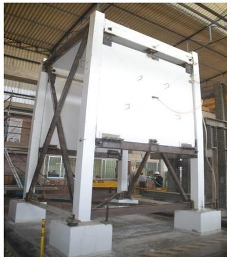
**Figura 13.** Estructura prefabricada con dispositivos sísmicos colocados en la coronación de los muros.
