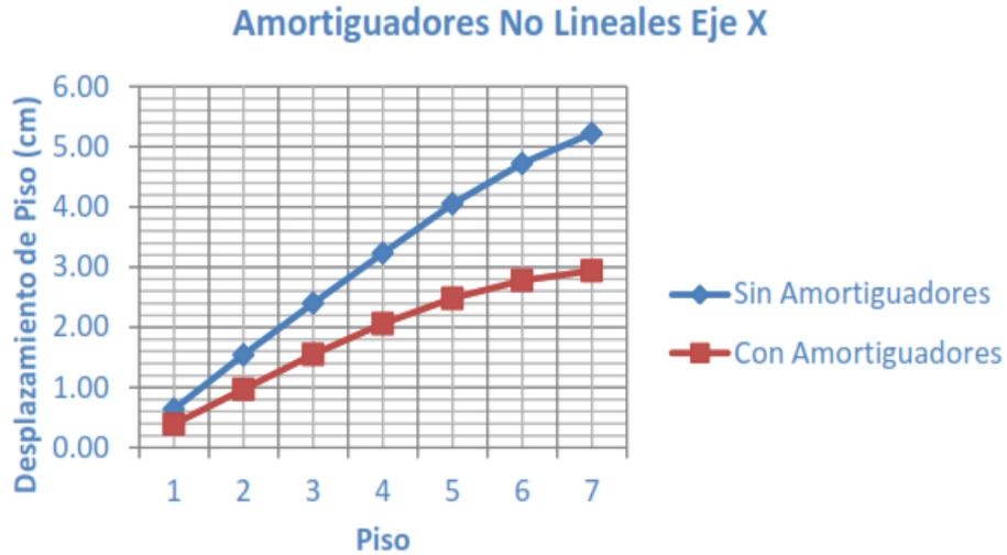
Figura 39. Amortiguadores no Lineales Eje X-X
