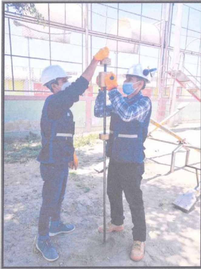
ENSAYO IN SITU DE DPL N°1
