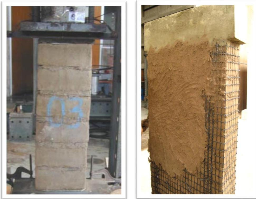
**Figura 19.** Pila de Albañilería patrón y con el reforzamiento con geomalla
