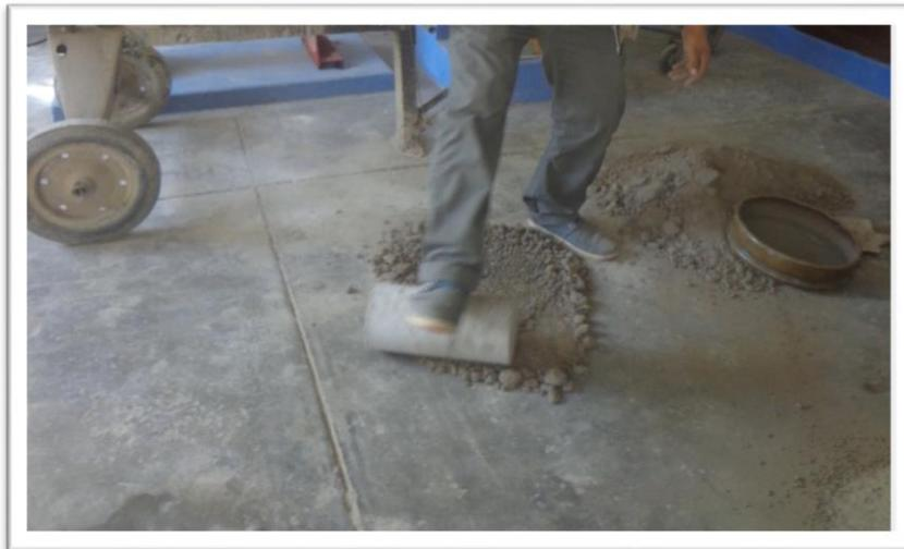
*Figura 31.* Antes de separar la muestra para los ensayos se trata de moler los brumos que tiene el suelo
