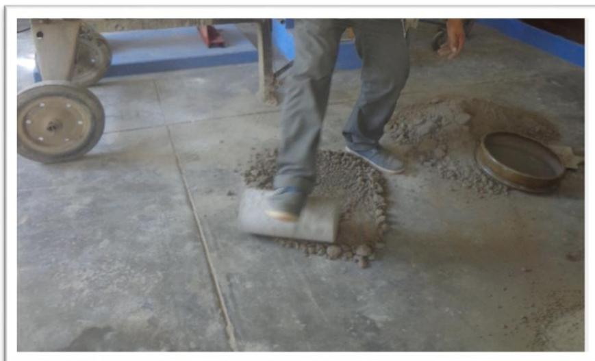
*Figura 13.* Antes de separar la muestra para los ensayos se trata de moler los brumos que tiene el suelo
