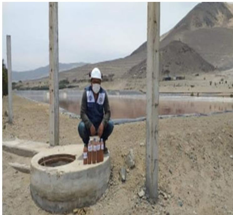
Figura N°20. Muestras de agua ya tomadas de la laguna de oxidación de Coishco antes de su tratamiento almacenadas en botellas plásticas de 500 ml
