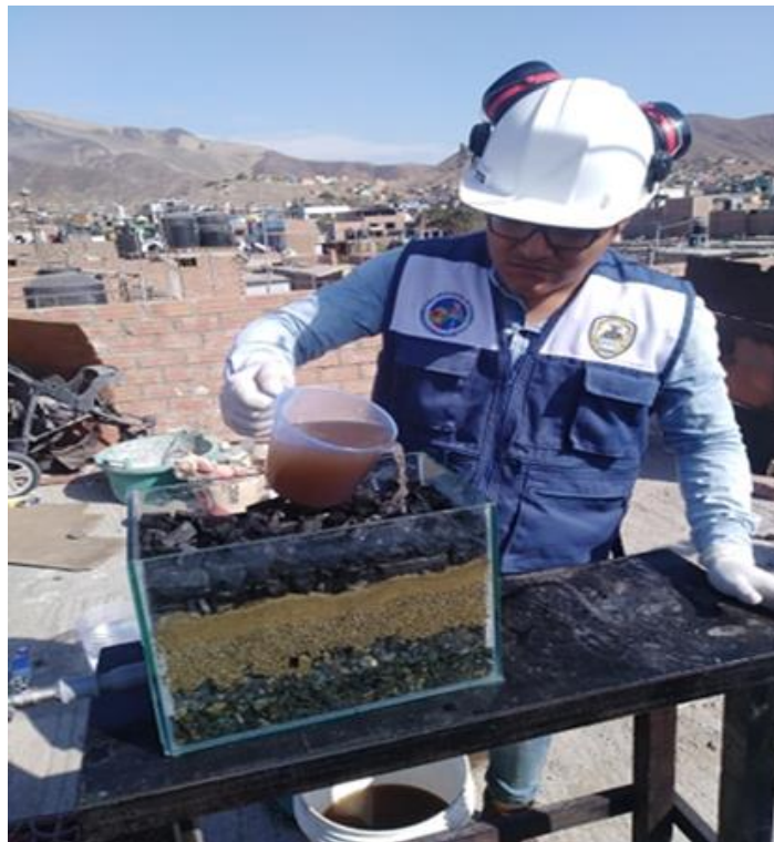
Figura N°26. Se filtró el agua en el biofiltro
