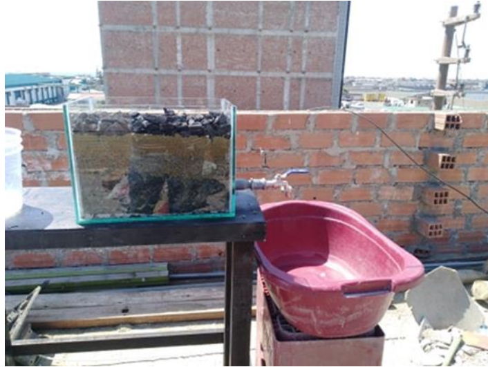
Figura N°25. Se colocó en sus capas respectivas (Arena, Grava y Carbón Vegetal)
