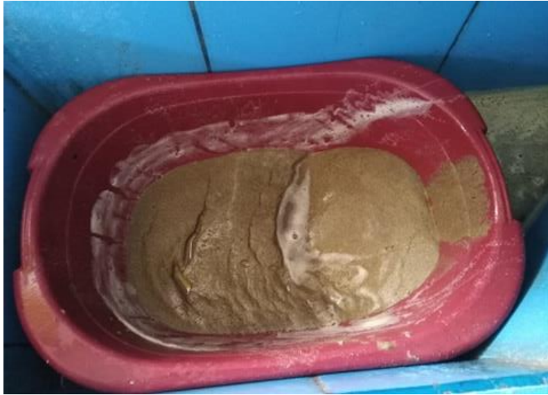
Figura N°23. Se lavó la arena previamente
