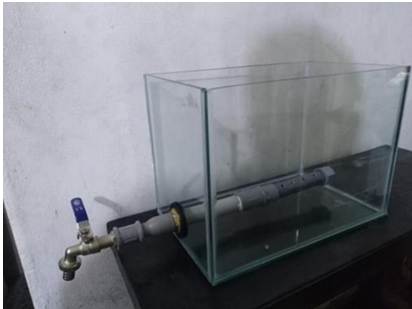
Figura N°22. Se realizó la colocación del caño a través de un adaptador de PVC DE 3/4 "a 1/2 "y una unión mixta
