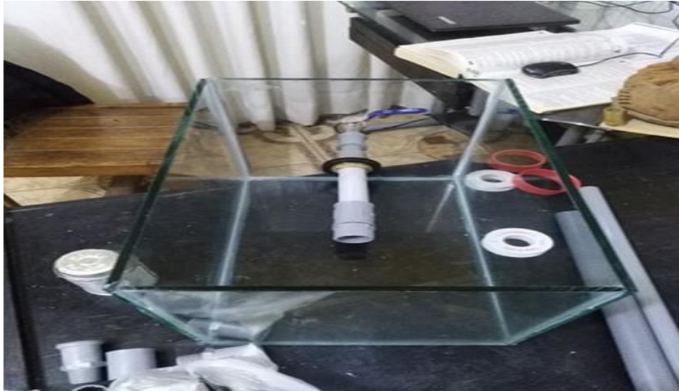
Figura N°21. Se realizó una perforación a la pecera para poder colocar el niple para evitar las fugas
