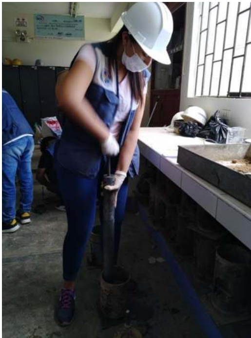
Figura 40. CBR (Experimental) con adición del 4%, 6% y 8% de conchas de coquina de la Calicata N°02, se observa la medición de la expansión con el dial.
