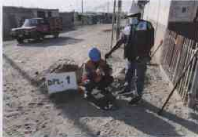
VISTA DEL ENSAYO DE PENETRACION LIGERA DPL - 1 EN LA ZONA EN ESTUDIO - A.H. NUEVA ESPERANZA
