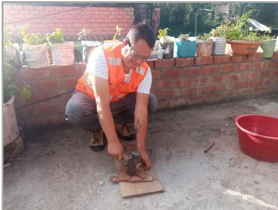
Figura N° 18: Material (cerámico reciclado) y su trituración.
