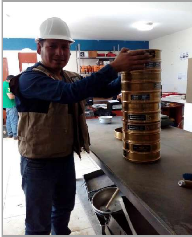
Figura N° 15: Se aprecia el uso de los tamices para la clasificación granulométrica
