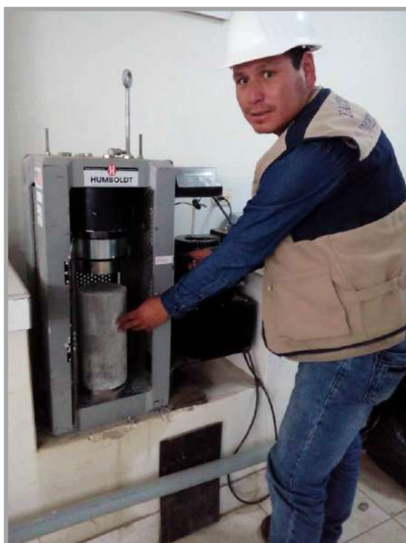
Figura N° 29: Prueba de resistencia a la compresión al concreto patrón y experimental
