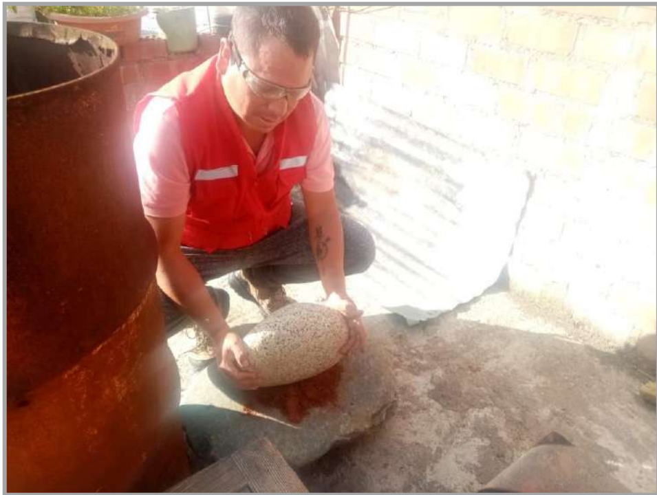
Figura N° 19: Molienda de material (cerámico reciclado).
