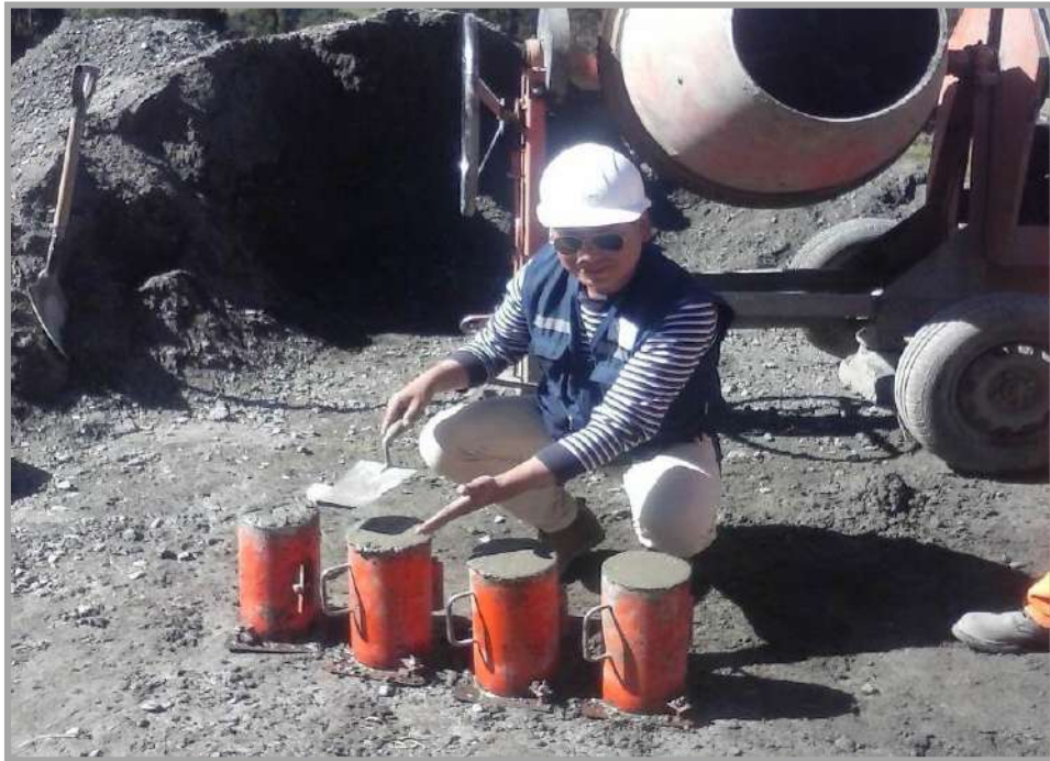
Figura N° 24: Elaboración de las probetas de concreto patrón.
