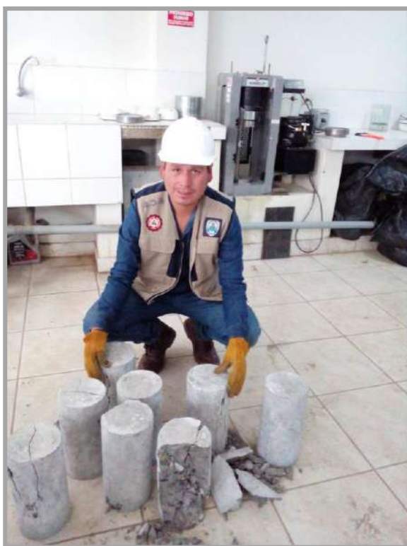
Figura N° 30: Resultados de las Pruebas de resistencia a la compresión
