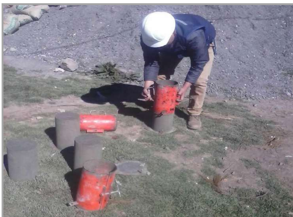
Figura N° 28: Retirando las probetas para el curado de ellas.
