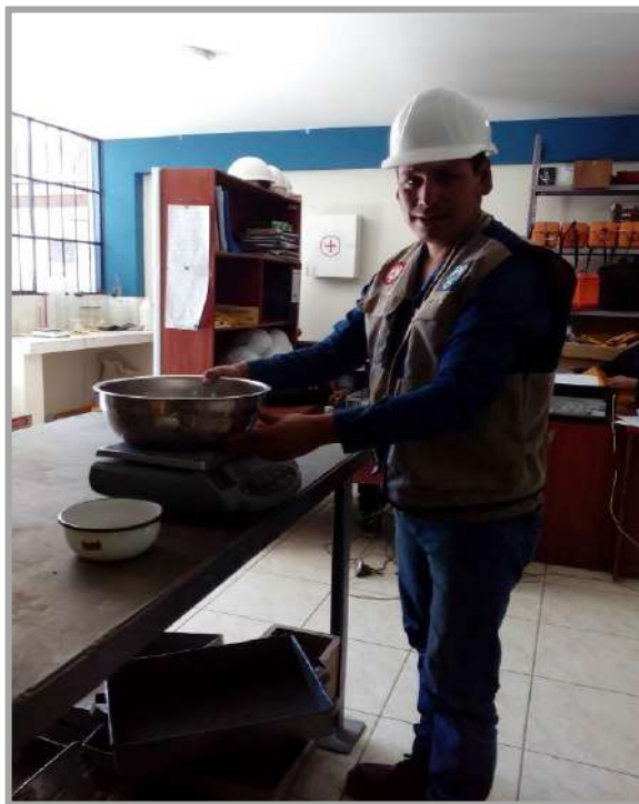
Figura N° 13: Se aprecia el pesado y el lavado del agregado.
