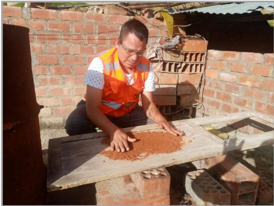
Figura N° 20: Secado de material (cerámico reciclado molido).
