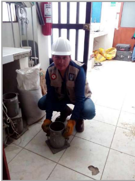
Figura N° 17: Se aprecia el uso del Cilindro para calcular el peso unitario
