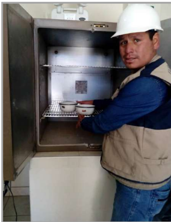
Figura N° 14: Se aprecia llevado de la muestra al horno para el secado.
