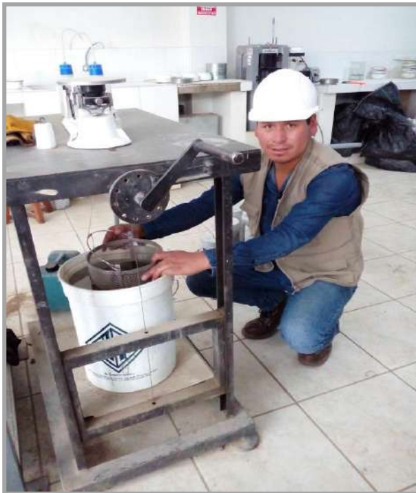
Figura N° 16: Se aprecia el uso de la canasta de malla para sacar el peso específico y la absorción
