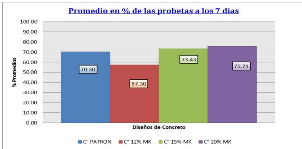
FIGURA N° 10.- Ensayos De Compresión según Promedio en % de las Probetas a los 7 días de curado, Fuente: Elaboración propia
