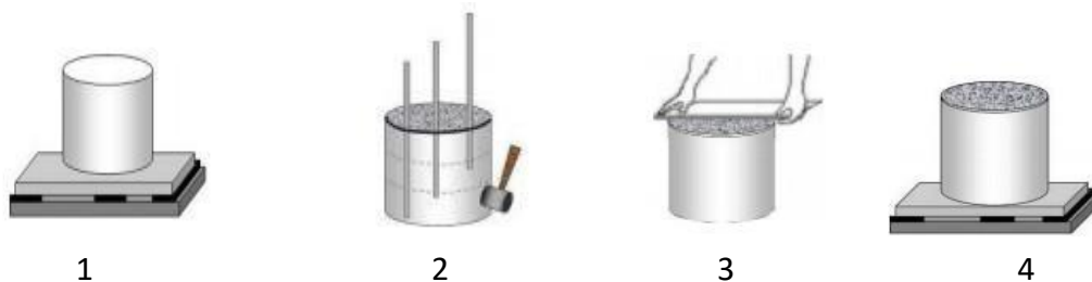
Fig. N° 04 Ensayo de Peso unitario
