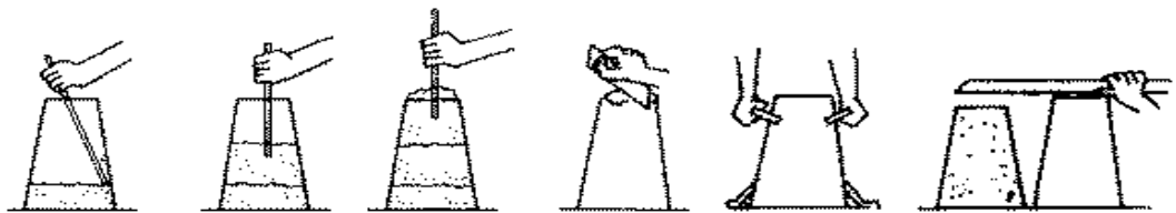
Fig. N° 01: La prueba del Slump mide el asentamiento del Concreto
