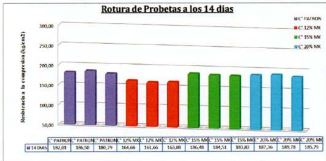
Figura N° 08.- Ensayo de Compresión - Rotura de Probetas a los 14 días
