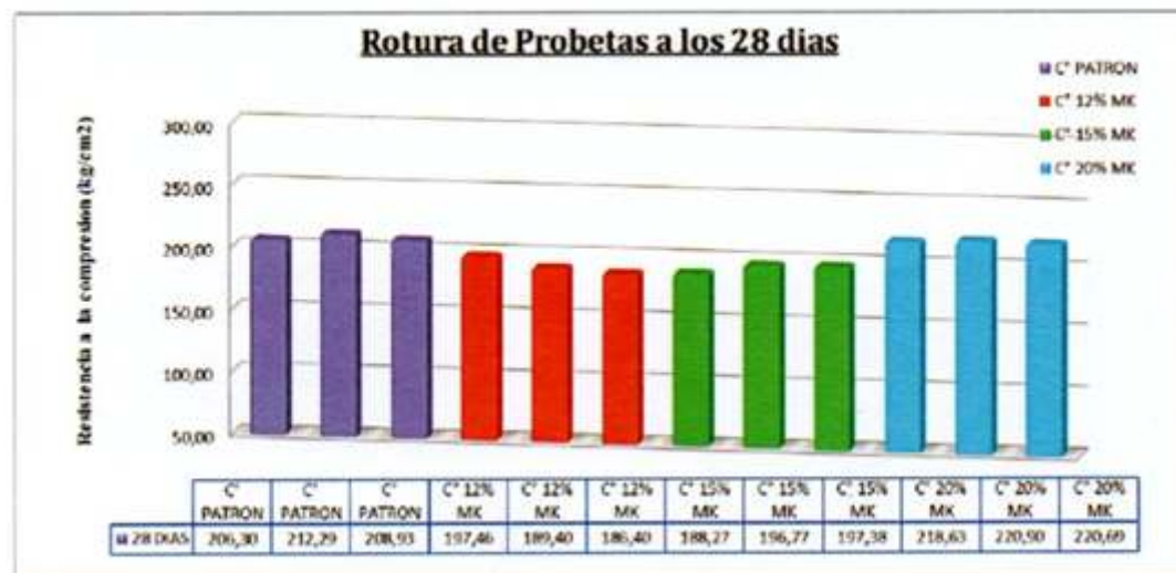
Figura N° 09.- Ensayo de Compresión - Rotura de Probetas a los 28 días
