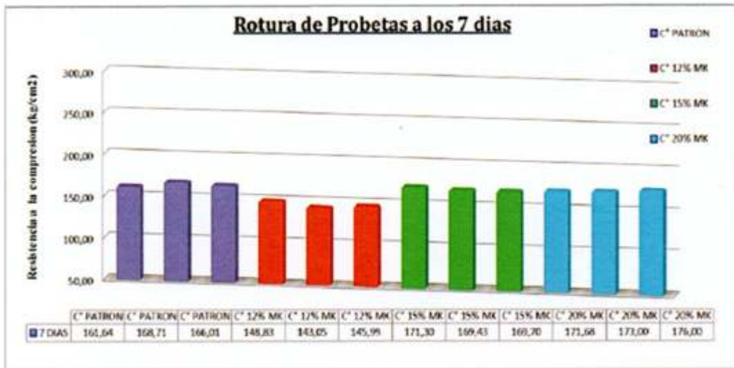
Figura N° 07.- Ensayo de Compresión - Rotura de Probetas a los 7 días
