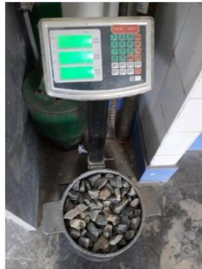
✓ **Peso unitario compactado:** en este ensayo realizaremos el cuarteo de los agregados fino y grueso para luego llenarlos en los moldes (Figura 37), se llena en 3 capas tanto para el agregado fino y grueso ya que cada capa se le chusea con una varilla (realizando 25 golpes) y se le pesa 3 veces.
