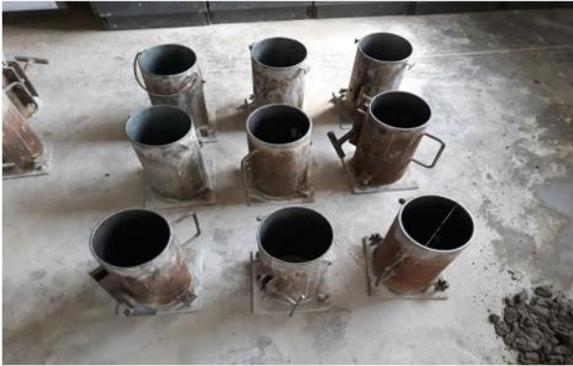
MOLDE PARA PROBETAS
