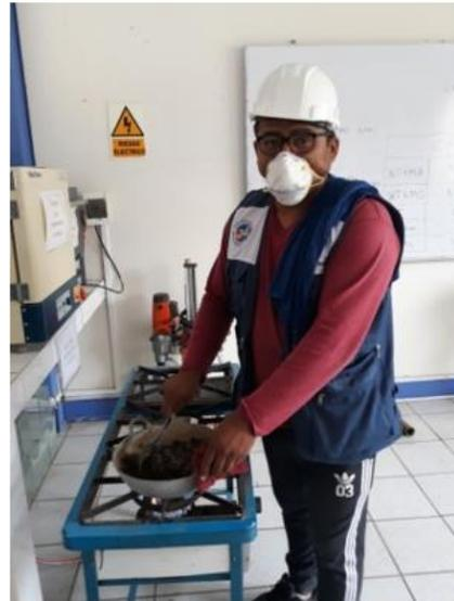
✓ Después de secar el agregado fino utilizaremos las herramientas del cono y procedemos a pisonar, luego pesamos la fiala para tomar sus medidas sin agua y con agua (la fiala se llenó hasta el nivel 0) y finalmente se comprime el aire para pesarlo. (Foto 39)
