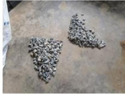
✓ Contenido de Humedad: en este proceso se prepara 3 taras de agregados fino y grueso para pesarlos (Foto 31a y 31b), solo se pesarán 2 taras de agregado fino y grueso y los cuales se colocarán en el horno (Foto 32), con los restantes se realiza la granulometría.
