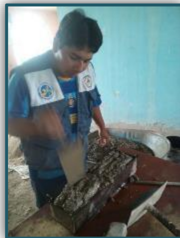
Figura 30. Moldeado del ladrillo Fuente: Elaboración Propia
