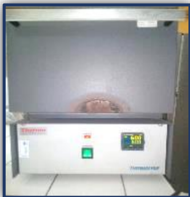
Figura 13. Calcinación de ceniza a 200°C
