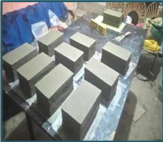
Figura 38. Unidades de ladrillos patrón en secado, después del capping Fuente: Elaboración Propia
