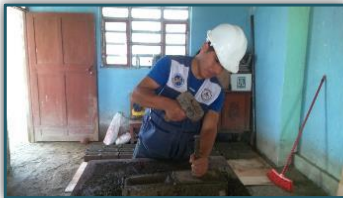
Figura 24. Compactado de la mezcla Fuente: Elaboración Propia
