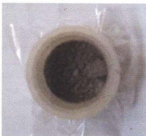
Figura 2. Muestra de Ceniza de Tusa de Maíz (Calcinada a 600°C por 2 horas), colocada en el portamuestras
