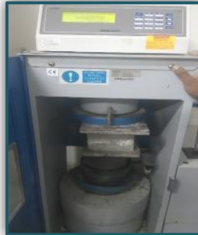
Figura 39 Unidades de ladrillos patrón sometidos a ensayo a la compresión Fuente: Elaboración Propia
