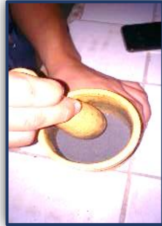
Figura 14. Pulverizado con mortero. Fuente: Elaboración Propia
