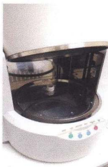
Figura 3. Muestra colocada en el Espectrómetro de Fluorescencia de Rayos X
