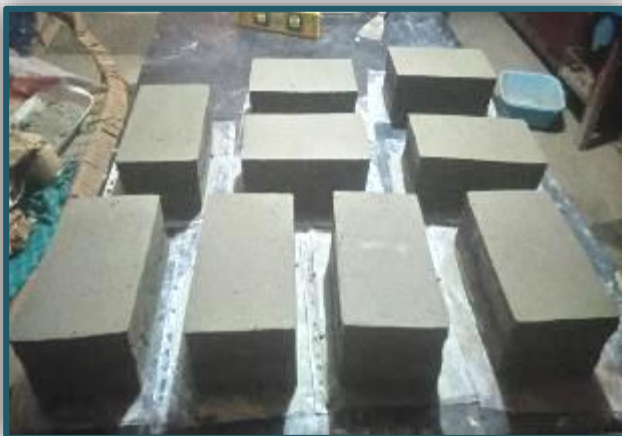
Figura 40. Unidades de ladrillos experimentales en secado, después del capping Fuente: Elaboración Propia
