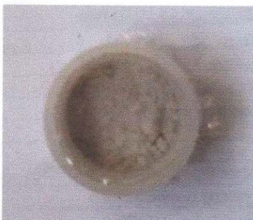
Figura 2. Muestra de Ceniza de Tusa de Maíz (Calcinada a 600°C por 2 horas), colocada en el portamuestras
