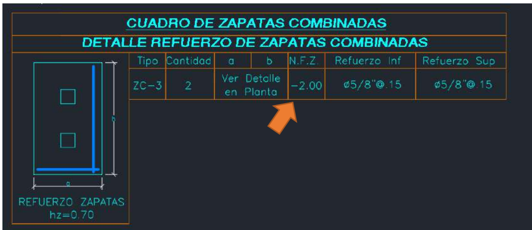
Figura N° 104: Incongruencia en Detalles estructurales de ZC – 03.
