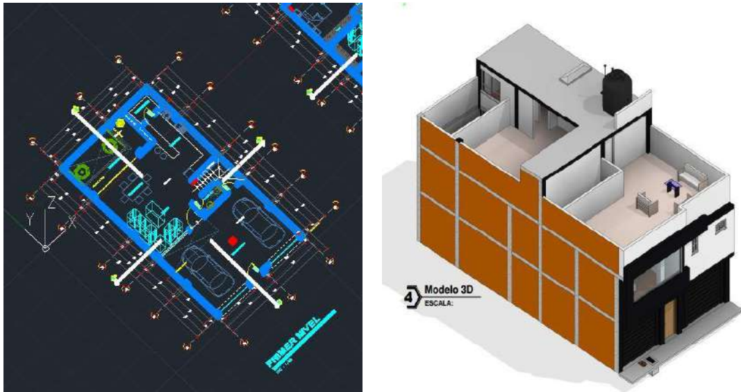
Figura N° 04: Diferencias entre CAD y BIM.
