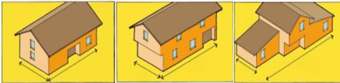
Figura 4 Irregularidad en Planta de la Edificación
