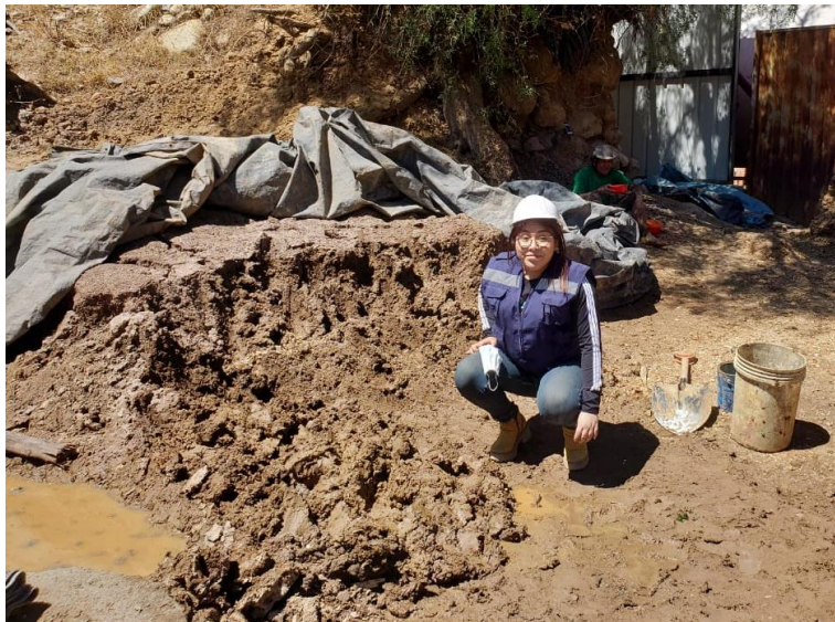
Figura 21: Mezcla de barro se prepara y tapa con plásticos dos días antes de la elaboración de las unidades - ladrillera Lázaro – CPM San Nicolás - Huaraz
