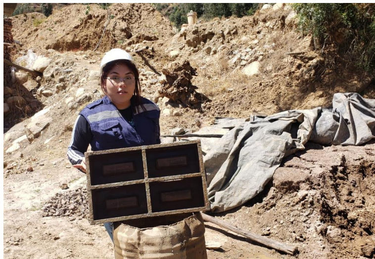
Figura 23: moldes o gaveras de madera para la elaboración manual de unidades de albañilería - ladrillera Lázaro – CPM San Nicolás - Huaraz
