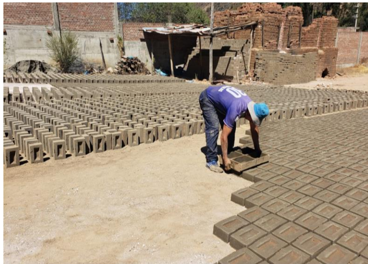
Figura 13: Proceso de colocación en zona plana para secado natural- ladrillera Santa Rosa – CPM San Nicolás - Huaraz
