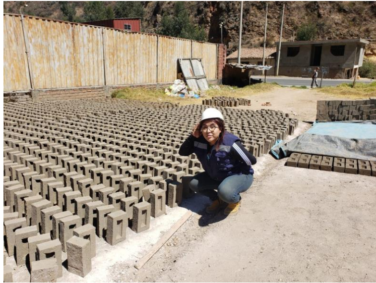
Figura 24: Proceso de secado natural de las unidades de albañilería- ladrillera Lázaro – CPM San Nicolás - Huaraz
