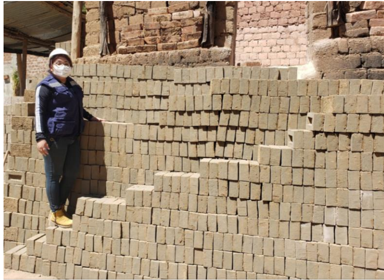
Figura 16: Colocación de ladrillo crudos para cocción en el horno artesanal - ladrillera Santa Rosa – CPM San Nicolás - Huaraz
