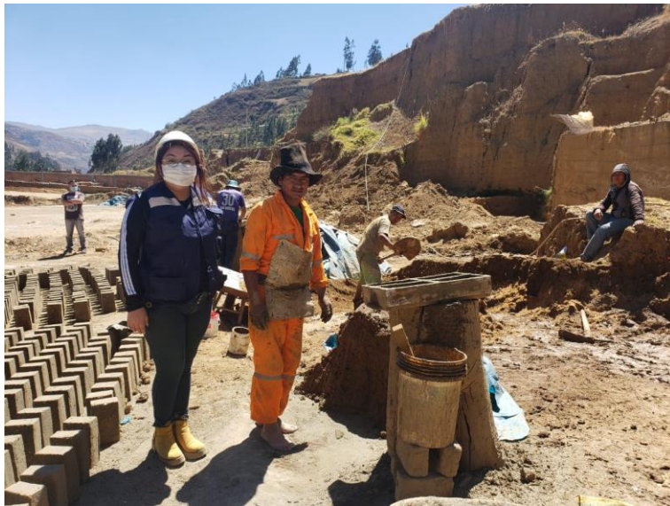
Figura 15: Proceso de elaboración artesanal diaria de unidades de albañilería - ladrillera Santa Rosa – CPM San Nicolás - Huaraz
