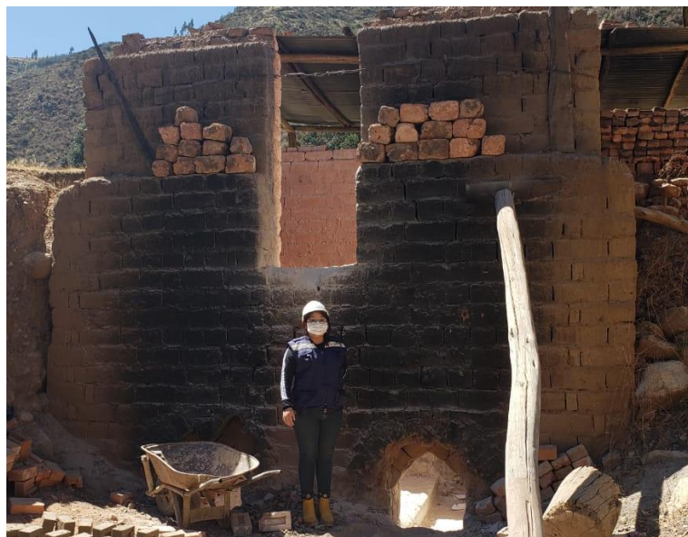
Figura 25: Horno artesanal con túnel de ventilación - ladrillera Lázaro – CPM San Nicolás – Huaraz
