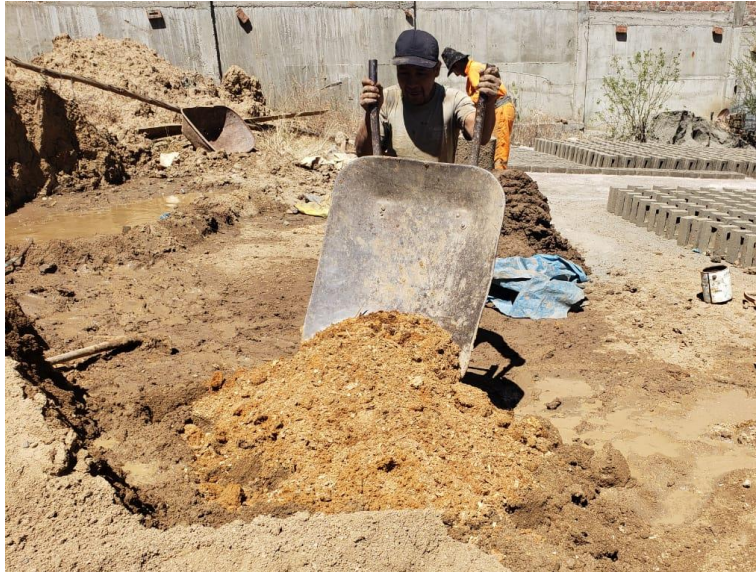
Figura 14: incorporación de “aserrín” a la tierra y arcilla - ladrillera Santa Rosa – CPM San Nicolás - Huaraz
