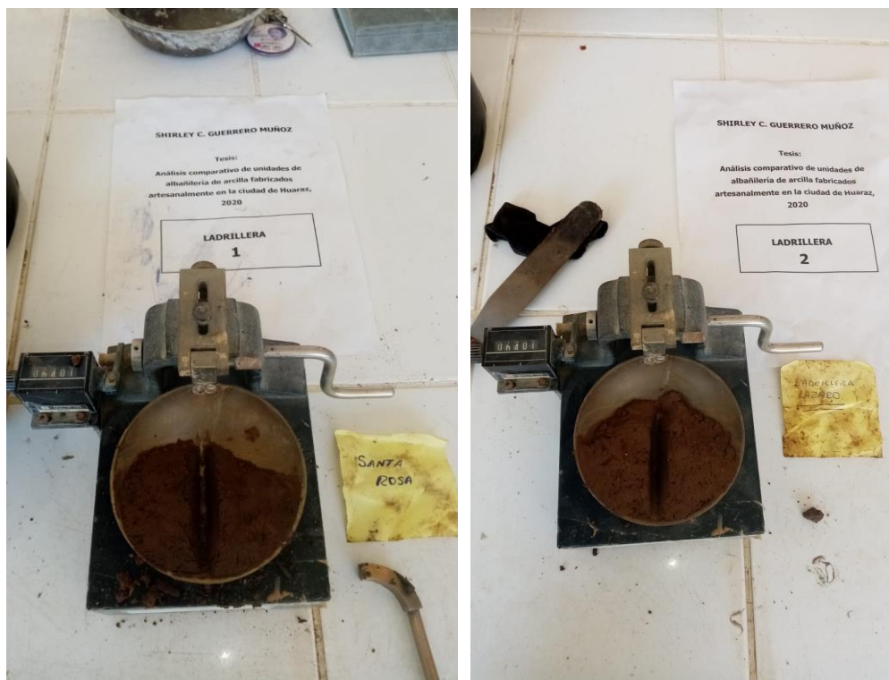
Figura 28: Muestras de arcillas para ensayo de límites de consistenci. Copa de Casagrande ladrillera 1 Santa Rosa y Ladrillera 2: Lazaro – CPM San Nicolás – Huaraz
