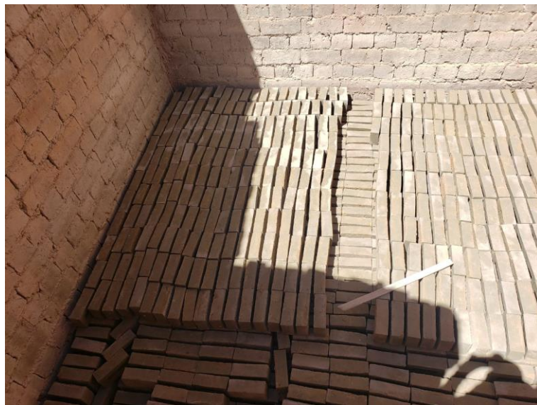
Figura 17: Colocación a través de las unidades de nivel a nivel para distribuir el calor de cocción - ladrillera Santa Rosa – CPM San Nicolás - Huaraz
