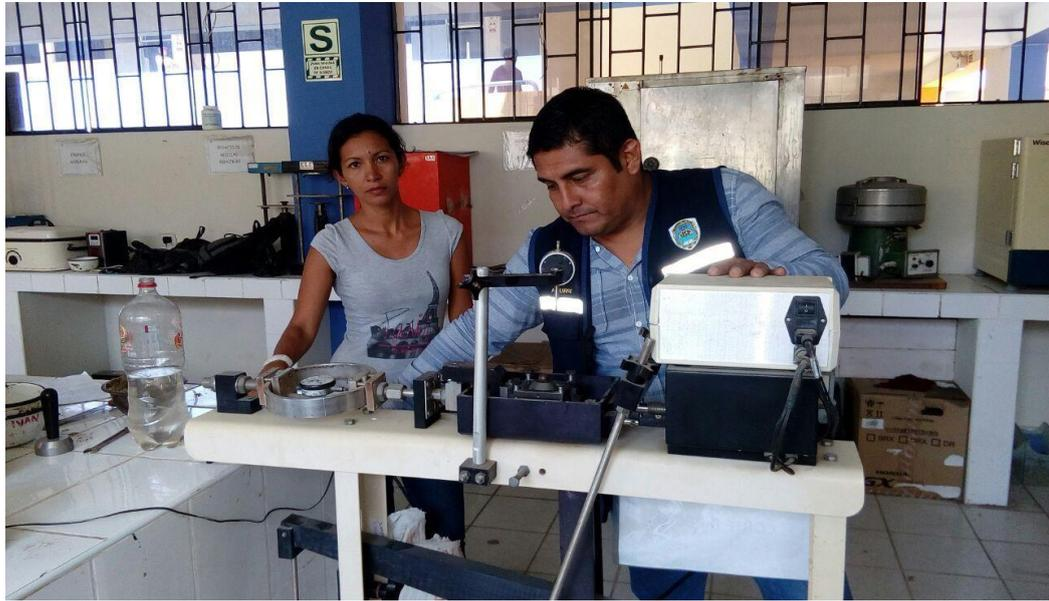
*Figura 31: realizando el ensayo del corte directo.*
