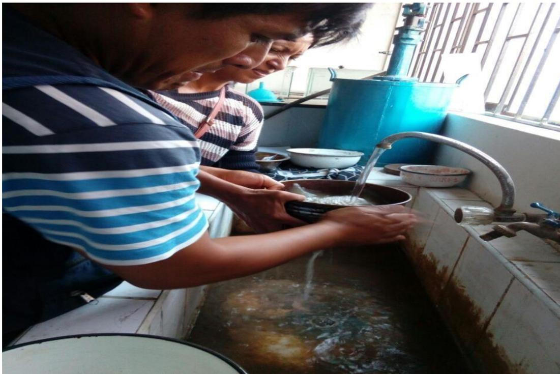
*Figura 18: realizando el análisis granulométrico por lavado.*
