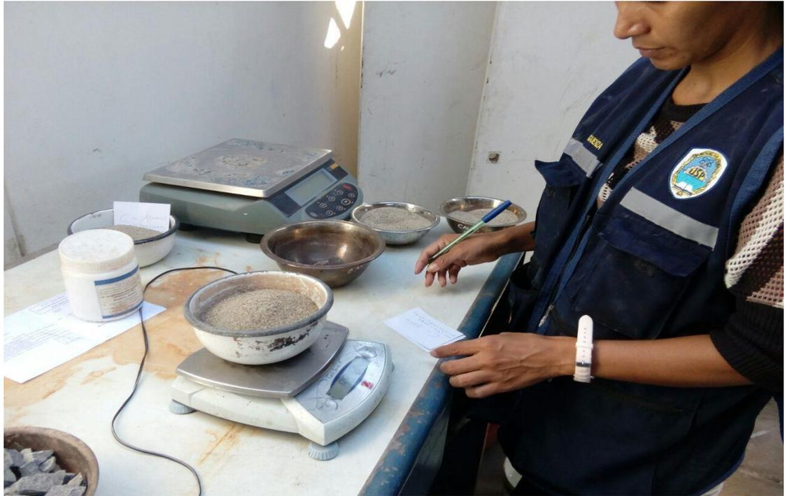
*Figura 17: pesando la muestra para realizar el análisis granulométrico.*
