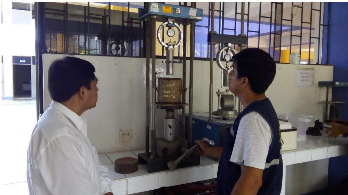
*Figura 26: realizando la penetración de las muestras de CBR con la supervisión del, asesor.*
