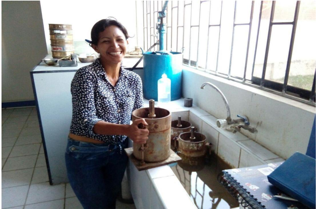
*Figura 25: retirando las muestras de CBR del agua.*
