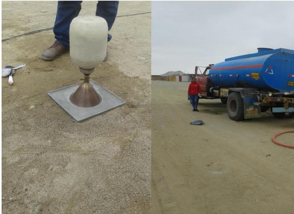
*Figura 29: realizando un segundo punto de densidad.*
