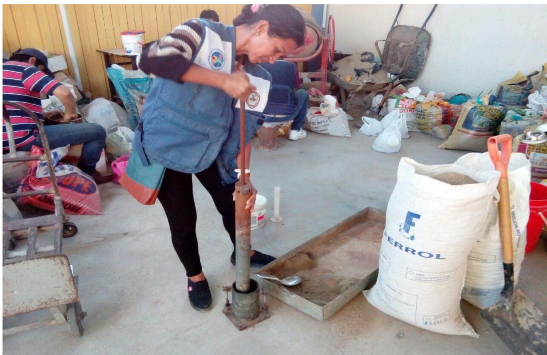
*Figura 22: realizando El ensayo de proctor método A.*
