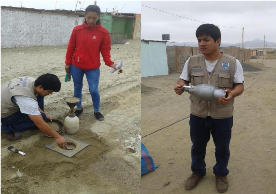
*Figura 28: realizando la densidad de campo en el área del proyecto*
