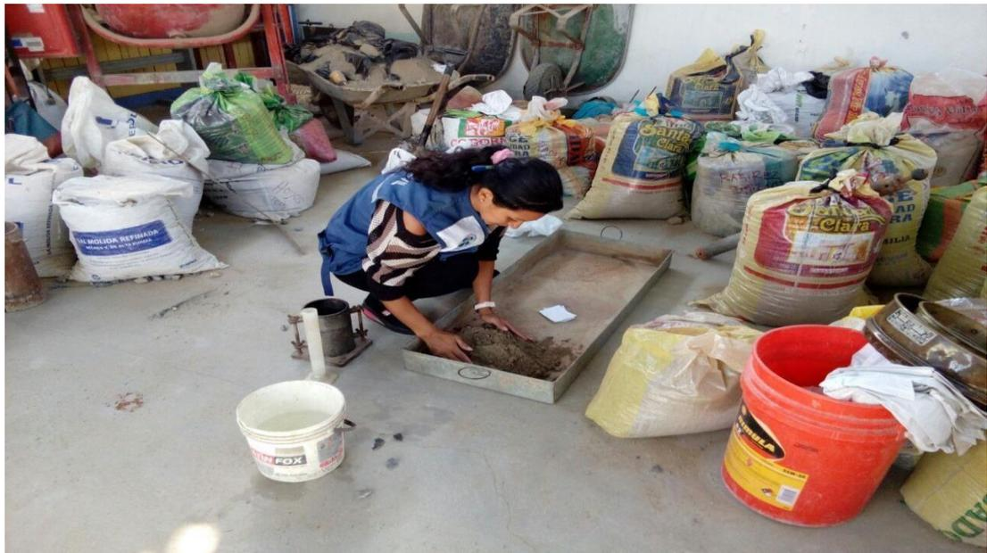
*Figura 21: realizando El ensayo de proctor y CBR.*
