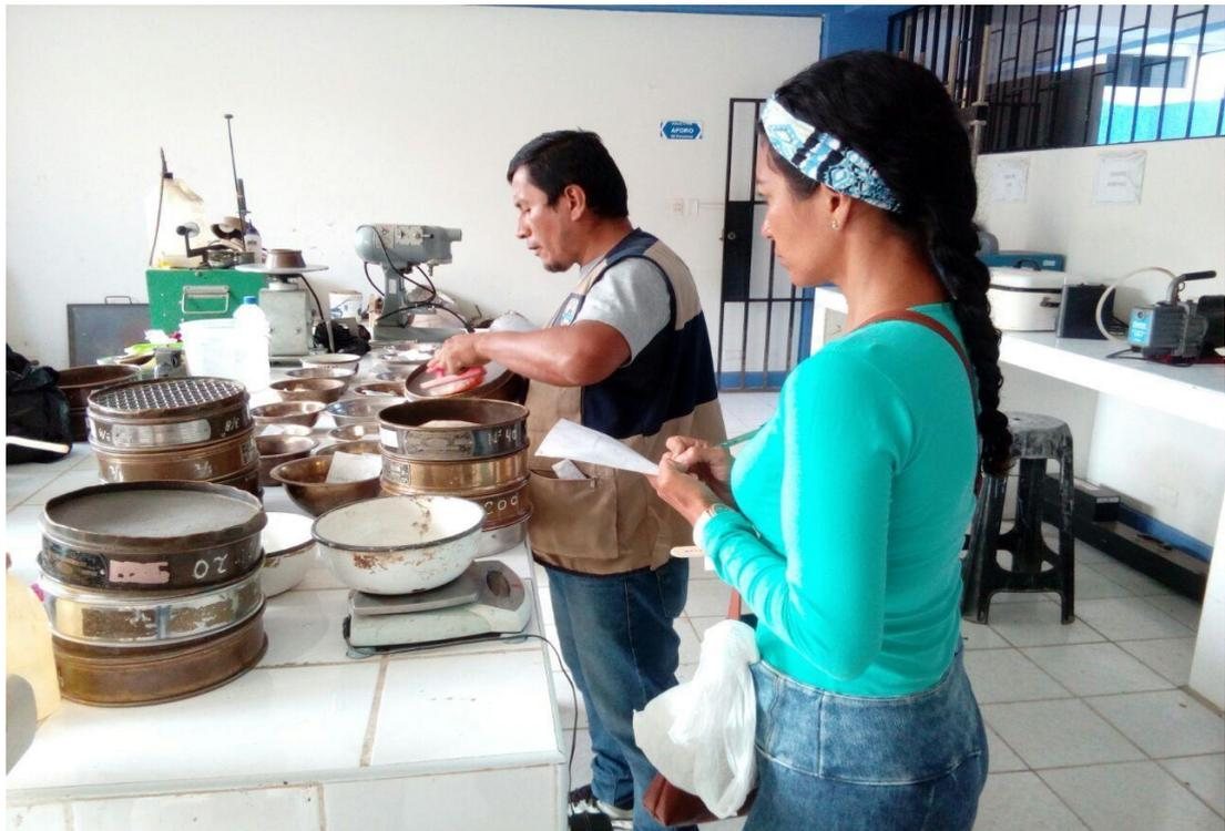
*Figura 19: realizando el análisis granulométrico con los tamiz.*
