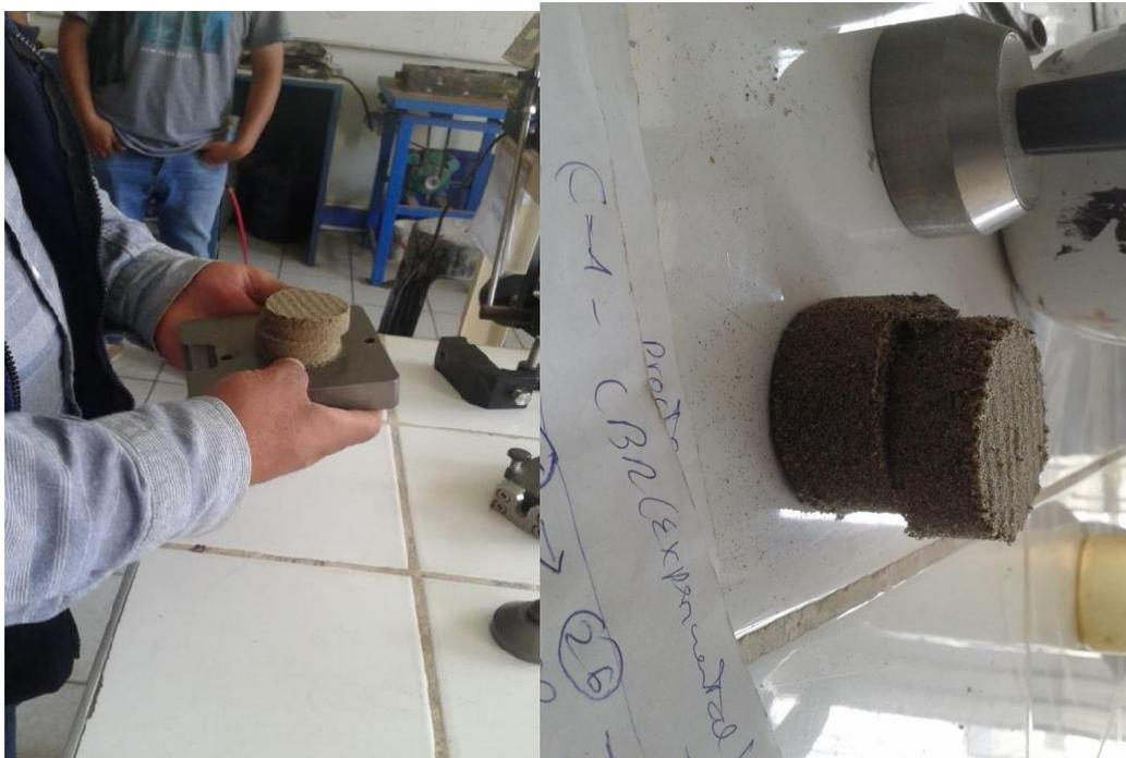
*Figura 30: muestra de la verificación del corte directo.*
