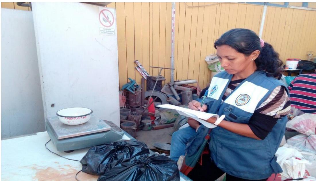
*Figura 20: pesando las muestras para proctor y CBR.*
