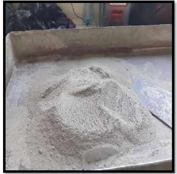
Figura N°52: Mezclado uniforme de los materiales adicionado al suelo para el CBR Experimental.
