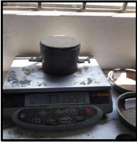
Figura N°45: Peso del molde + la muestra húmeda compactada y enrasada.
