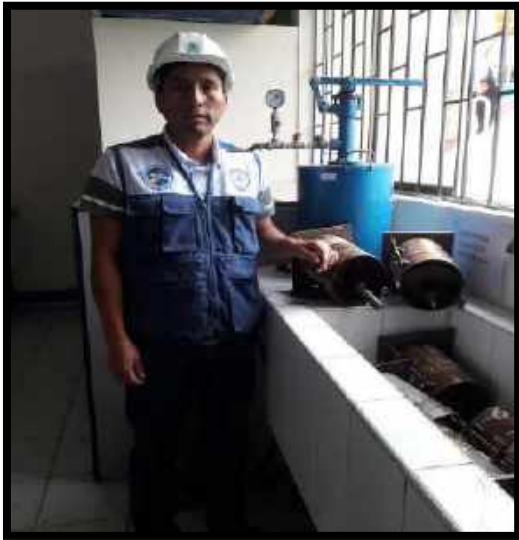
Figura N°33: Después de estar sumergido en el agua ahora se encuentran escurriendo los moldes.
