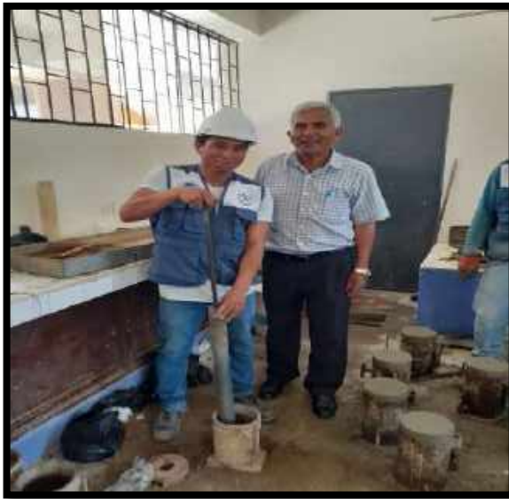
Figura N°53: Realizando 56 golpes, 26 golpes y 12 golpes con el pisón luego de cada capa aplicada con presencia de mi asesor.
