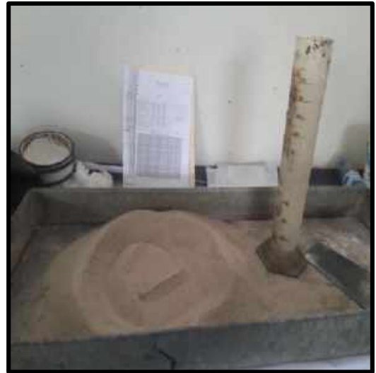
Figura N°42: Mezclado uniforme de los materiales adicionado al suelo para el Proctor Experimental.
