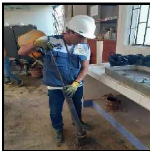
Figura N°24: Compactando con el pisón 26 golpes por cada capa del suelo en el molde.
