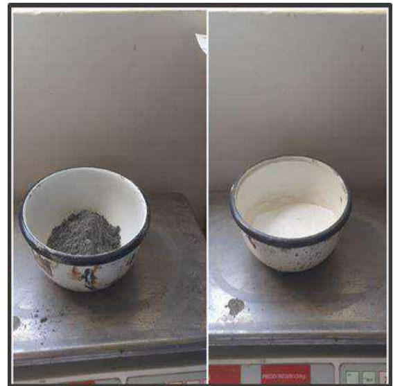
Figura N°58: Peso de la adición en un 7% de cenizas de concha de abanico y 5% cenizas de carbón mineral.
