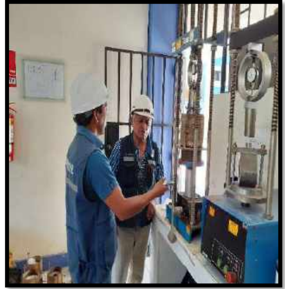
Figura N°56: leyendo las lecturas diales de la máquina del CBR Experimental con presencia del jefe del laboratorio el Ingeniero montañés.
