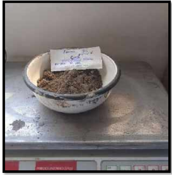
Figura N°48: Peso de material + tara adición cenizas de concha de abanico y cenizas de carbón mineral en el Proctor Experimental.
