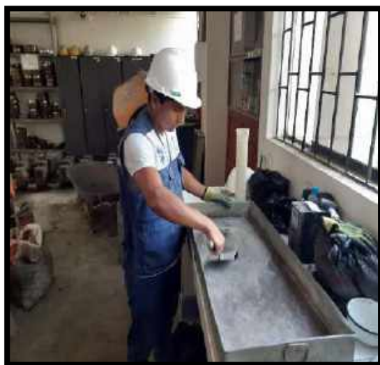
Figura N°23: Preparación de la muestra de suelo más el agua.
