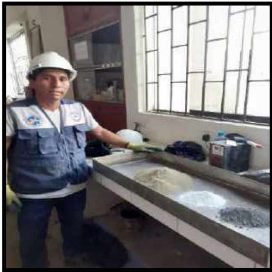
Figura N°59: Vista de la adición de un 7% de cenizas de concha de abanico y 5% de cenizas de carbón mineral.
