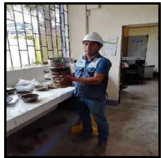
Figura N°20: Evidencia de haber ya realizado el tamizado de la muestra de suelo.
