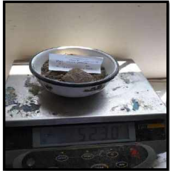
Figura N°46: Peso de material + tara adición cenizas de concha de abanico y cenizas de carbón mineral en el Proctor Experimental.
