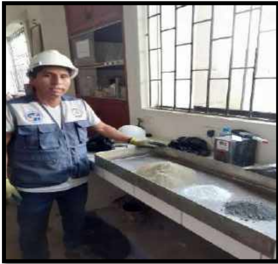
Figura N°41: Vista de la adición de 5% de cenizas de concha de abanico y 3% de cenizas de carbón mineral.
