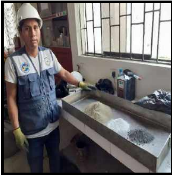
Figura N° 51: Vista de la adición de un 5% de cenizas de concha de abanico y 3% de cenizas de carbón mineral.
