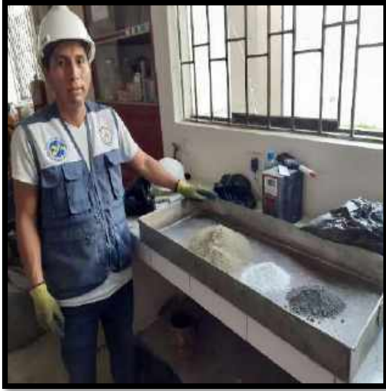
Figura N°49: Vista de la adición de un 7% de cenizas de concha de abanico y 5% de cenizas de carbón mineral.
