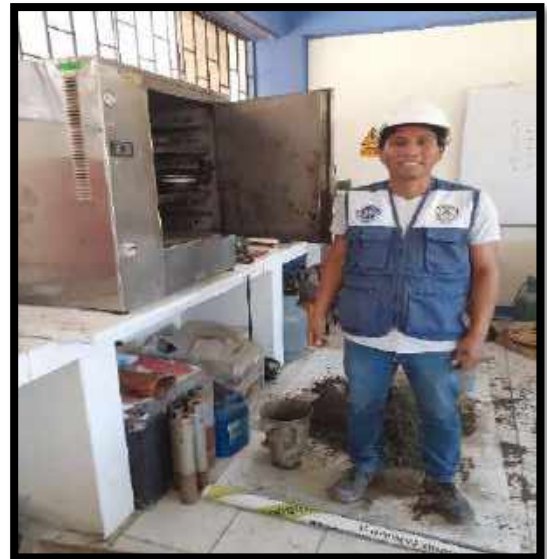
Figura N°18: secando la muestra del suelo del horno a una temperatura de 110°C.
