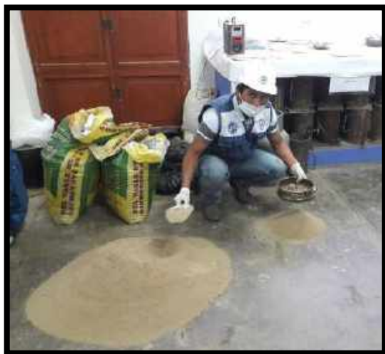
Figura N°21: Tamizando el material del suelo y determinación de los pesos retenidos.
