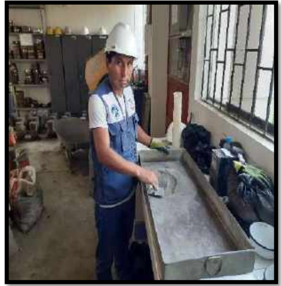
Figura N°50: Mezclado uniforme de los materiales adicionado al suelo para el Proctor Experimental.
