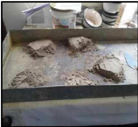
Figura N°43: Separación de la muestra en cinco partes iguales antes de echarle al molde el proctor experimental.
