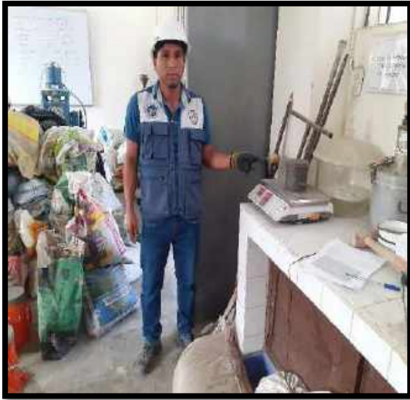
Figura N°47: Peso del molde + la muestra húmeda compactada y enrasada.
