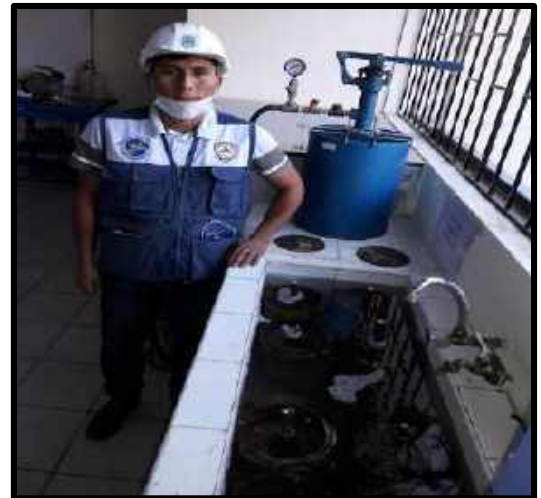
Figura N°32: Colocación de los moldes CBR en agua durante 72 horas para su durado.
