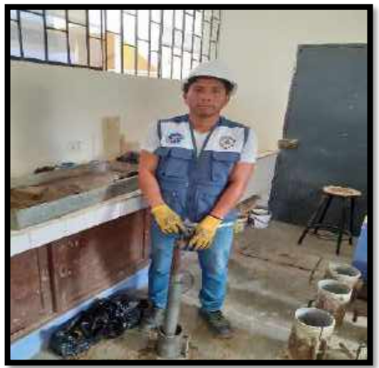
Figura N°44: Realizando 26 golpes por cada capa con el pisón luego de cada capa aplicada en el molde.
