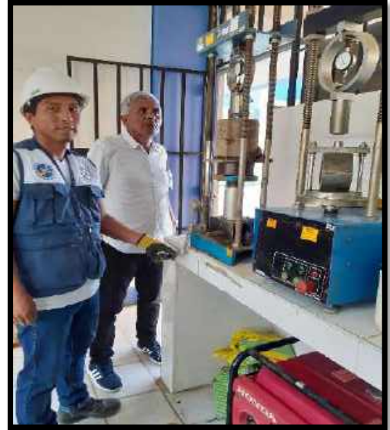
Figura N°64: leyendo las lecturas diales de la máquina del CBR Experimental.
