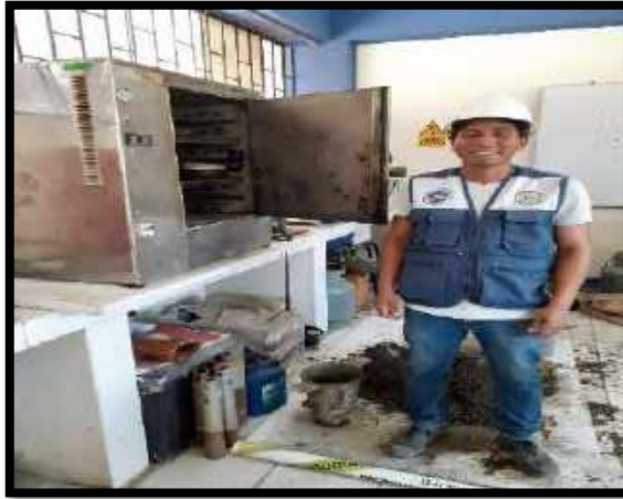
Figura N° 15: secando la muestra del suelo del horno a una temperatura de 110°C.
