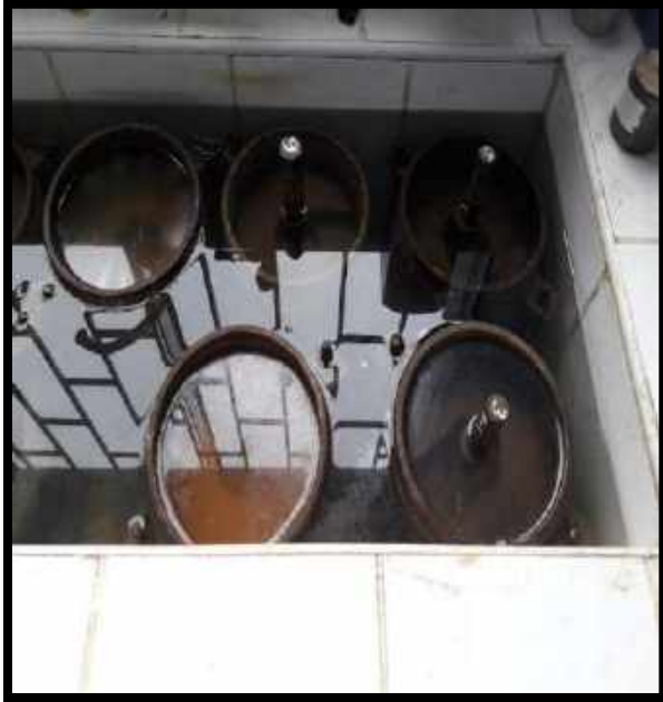
Figura N°63: Después de estar sumergido en el agua ahora se encuentran escurriendo los moldes de CBR Experimental para ser ensayado.
