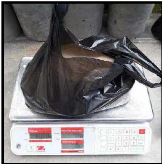
Figura N°57: Pesado de 3 muestras de suelo de 6 kg cada una para el ensayo.
