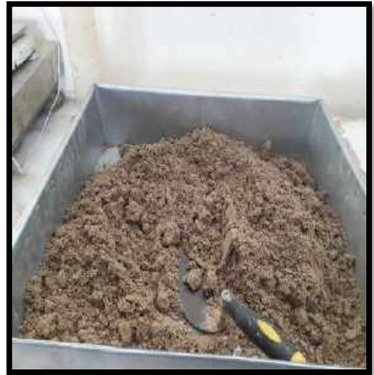
Figura N°60: Mezclado uniforme de los materiales adicionado al suelo para el CBR Experimental.
