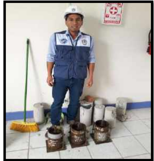
Figura N°34: se encuentra listo lo molde para realizarse el ensayo de penetración.
