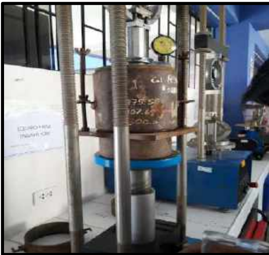
Figura N°35: Observamos que ya se encuentra colocado el molde más la muestra de suelo en la máquina de CBR.
