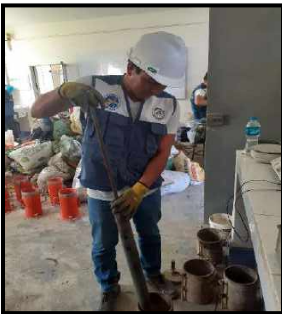
Figura N°61: Realizando 56 golpes, 26 golpes y 12 golpes con el pisón luego de cada capa aplicada en el molde.
