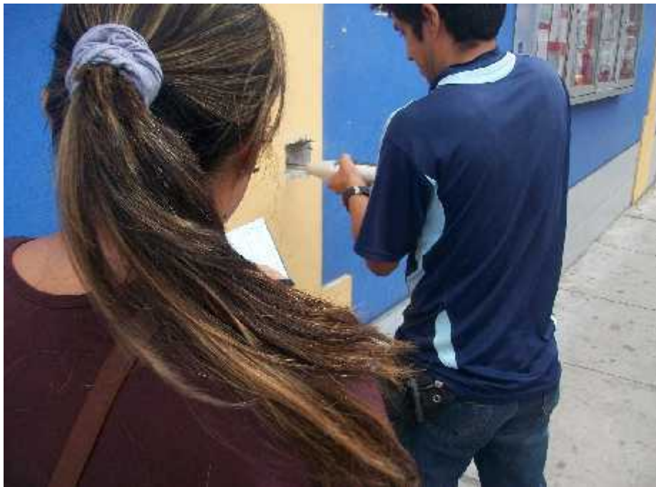
Realizando el ensayo con el esclerómetro a la columna del auditorio
