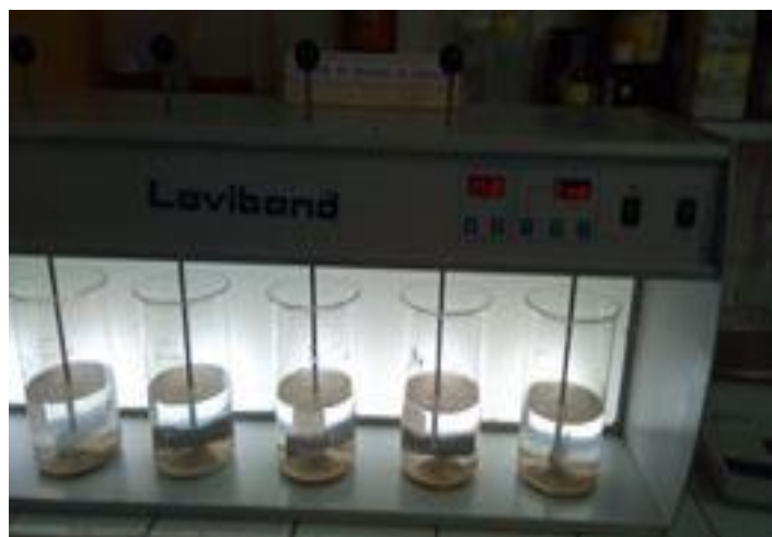
Figura 18: Mezclado lento (15 minutos – 0 rpm) Fuente: Elaboración propia
