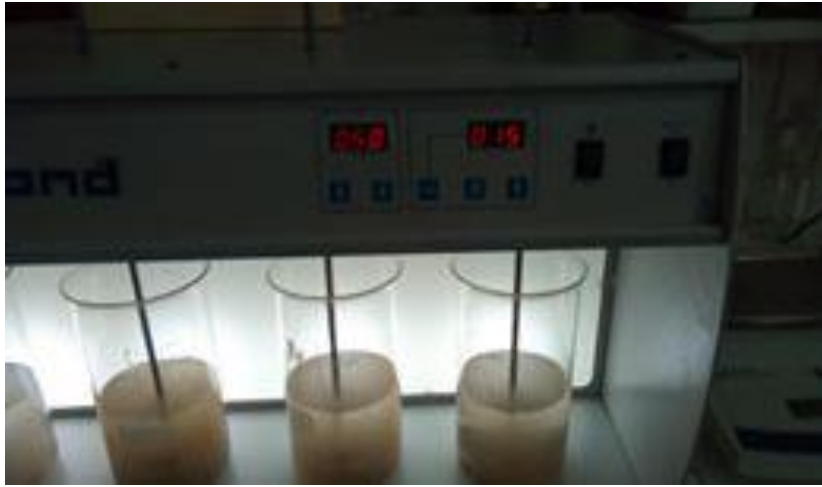
Figura 17: Mezclado lento (15 minutos – 50 rpm) Fuente: Elaboración propia
