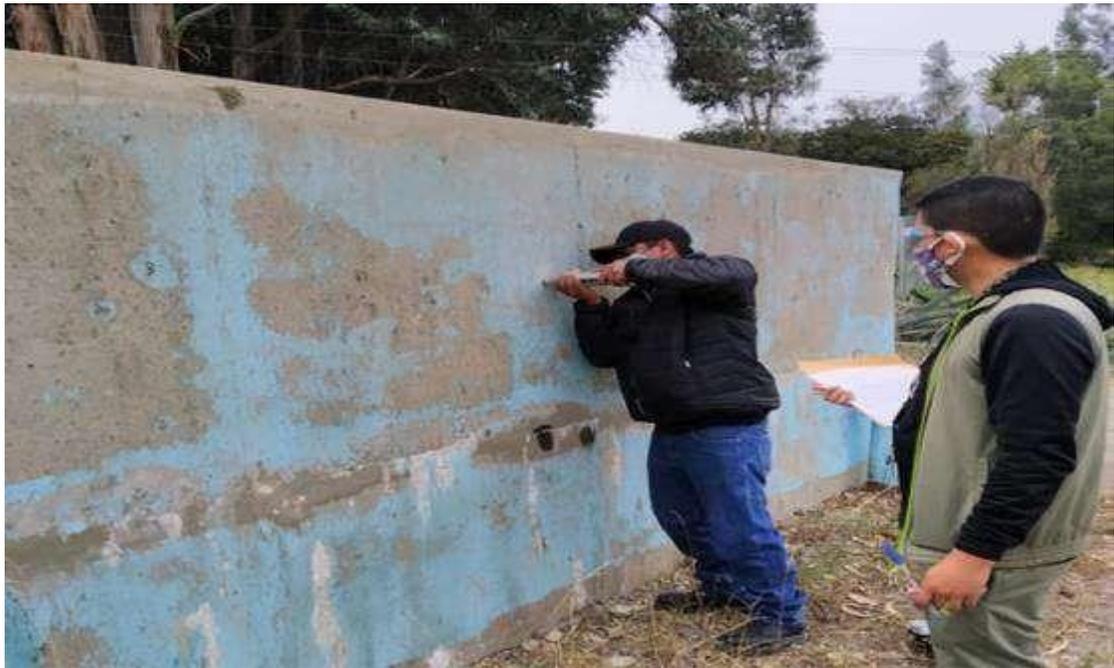
Anexo 07: Ensayo de esclerometría
