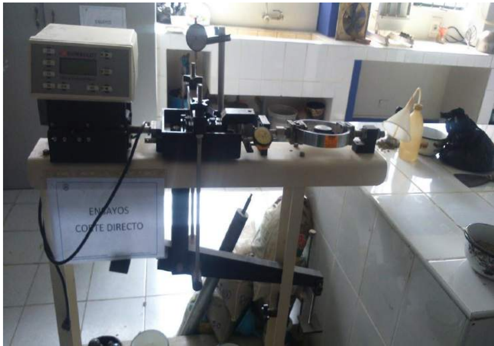
Figura N° 80: Vista de la máquina para realizar el ensayo de corte directo en el laboratorio de la Universidad San Pedro – Chimbote.
