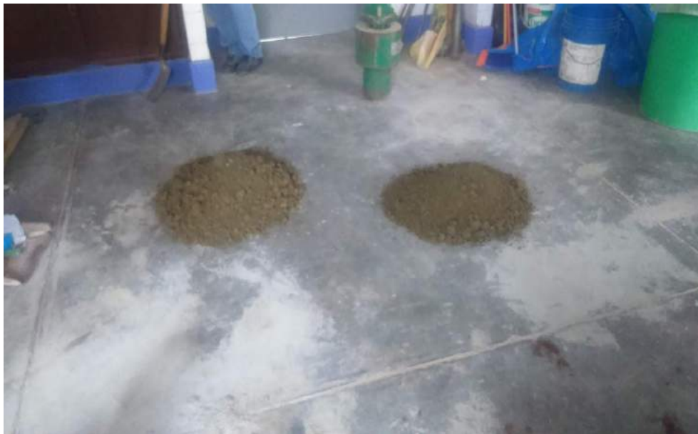
FIGURA N° 73: Vista de muestra de las dos calicatas en el laboratorio de mecánica de suelos de la Universidad San Pedro – Chimbote, para luego proseguir con el cuarteo de muestra.
