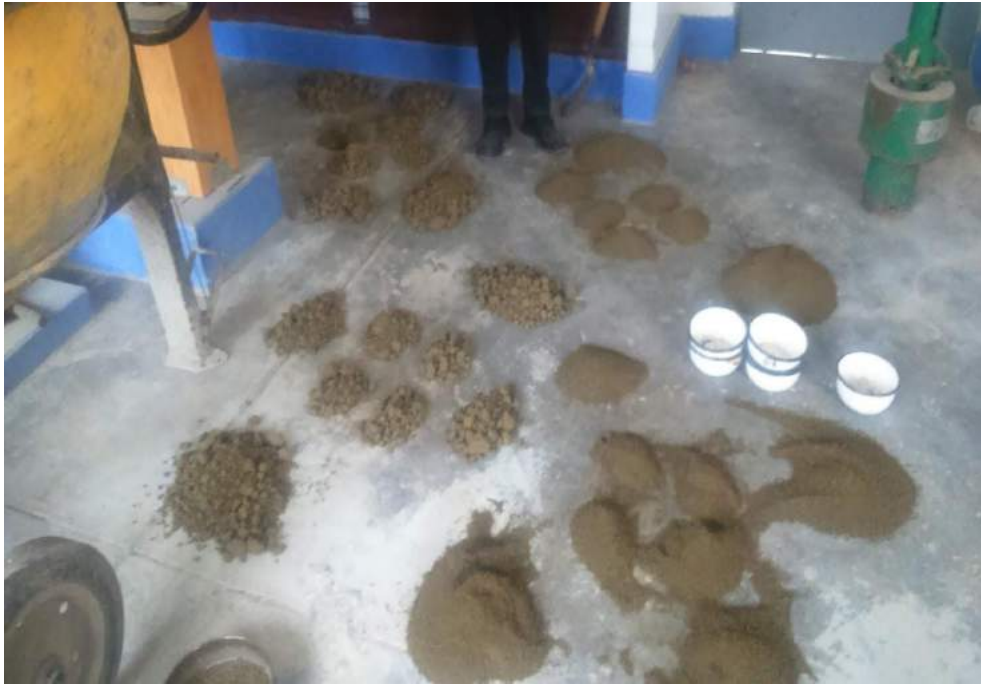
FIGURA N° 74: Vista de cuarteo de muestra en el laboratorio de mecánica de suelo y toma de muestras para diferentes ensayos de suelos que se realizó en el laboratorio.
