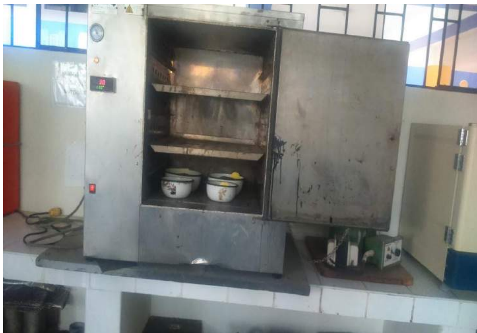
FIGURA N° 77: Vista de las muestras de suelos colocados en el horno para realizar el secado a una temperatura constante y por un tiempo mínimo de veinticuatro horas.
