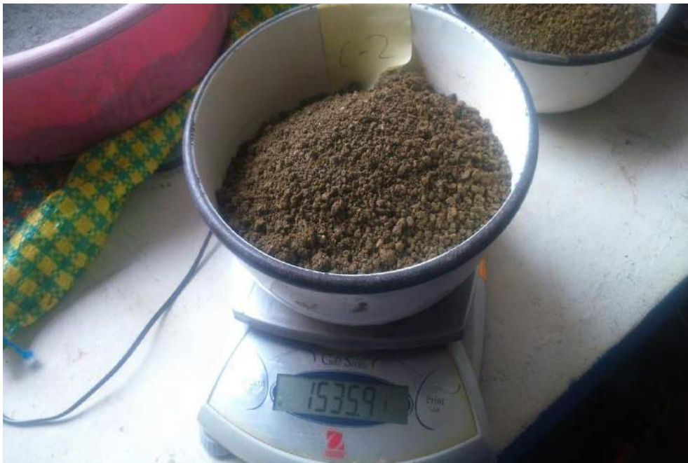
FIGURA N° 75: Vista, pesado muestra de suelo de la cada una de las calicatas con una balanza eléctrica y toma de datos para los cálculos.
