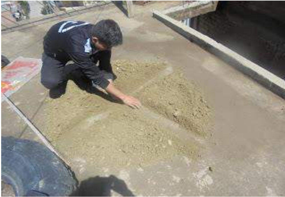
FIGURA N° 70: Vista de cuarteo de muestra por exceso para luego verter a bolsas para su traslado a laboratorio.
