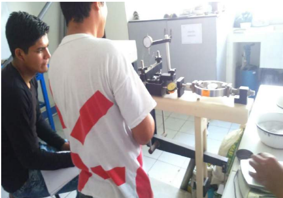
FIGURA N° 79: Vista, realizando el ensayo de corte directo de las muestras de suelos de cada una de las calicatas.
