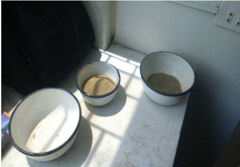
FIGURA N° 78: Vista de las muestras de suelos tamizados para realizar los ensayos de Limite Liquido, Limite plástico, e índice de plasticidad.
