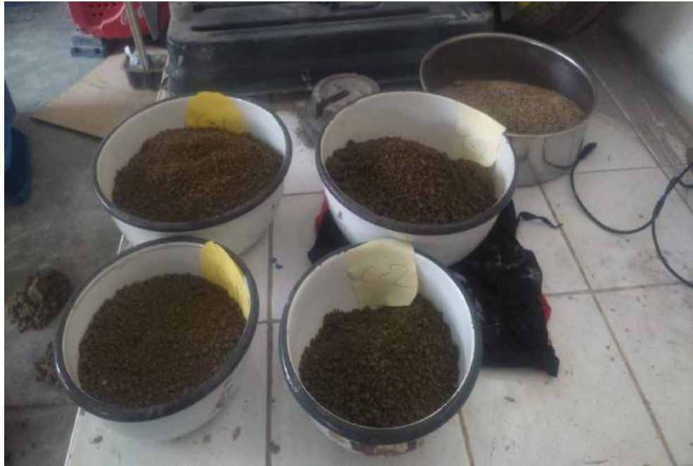
FIGURA N° 76: Vista de las muestras ya pesadas de cada una de las calicatas con su correspondiente etiquetado, para luego llevar al horno para realizar el secado.
