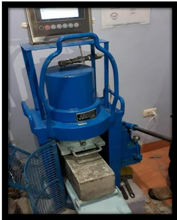
Figura 13: Ensayo de resistencia a flexión
