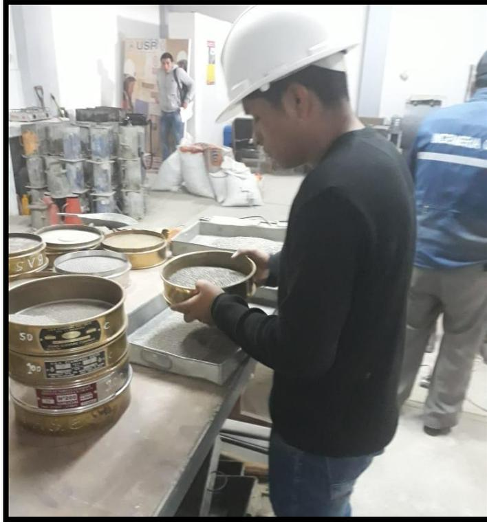
Figura 5: Tamizado de agregado fino
