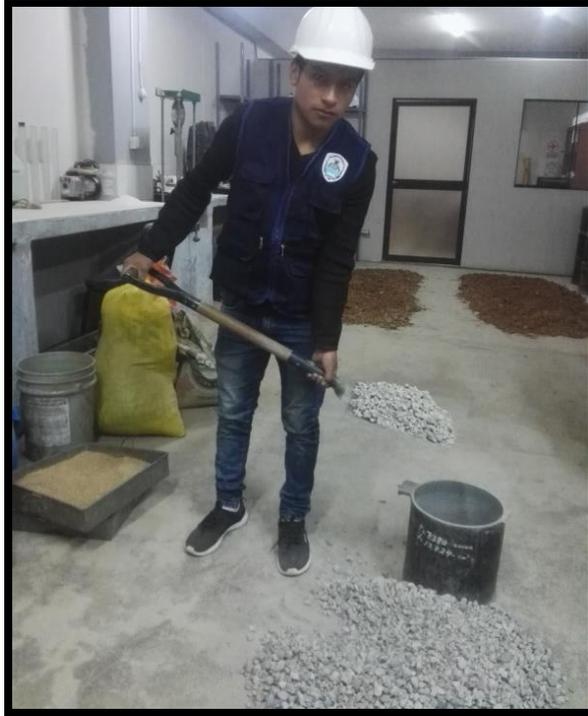
Figura 9: Peso unitario del residuo de concreto
