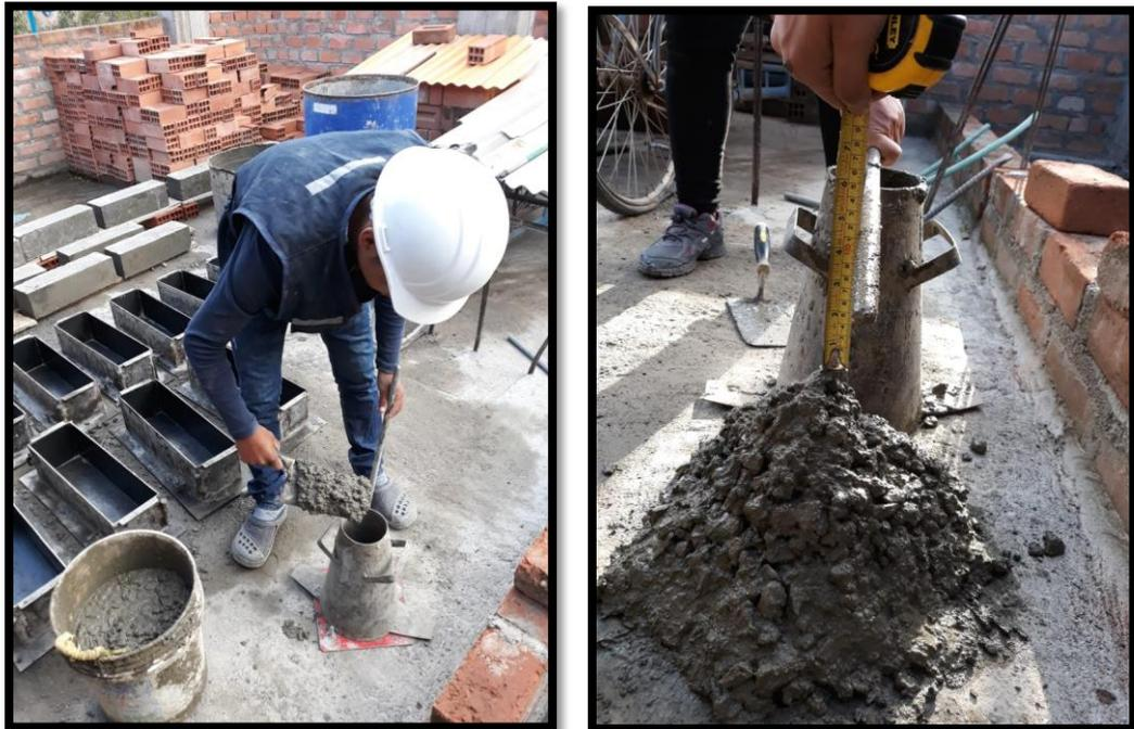
Figura 11: ensayo de slump
