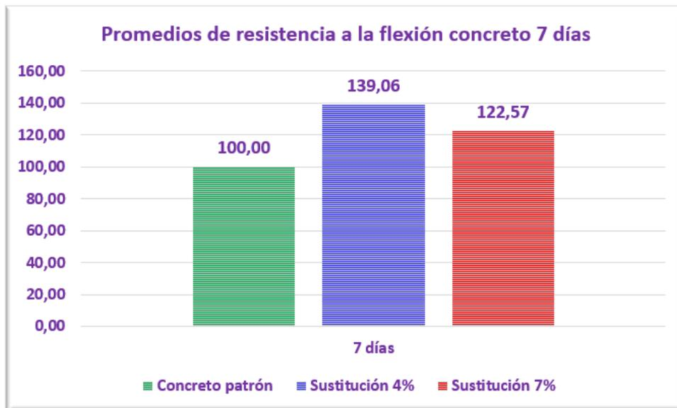
Figura 16: Promedio en porcentaje de resistencia a la flexión de concretos a los 7 días
