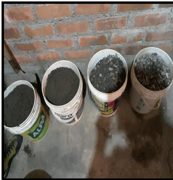
Figura 10: Materia a usarse para el preparado del concreto previamente pesados
