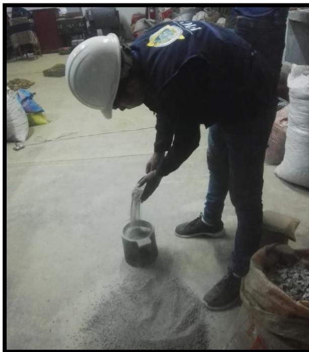
Figura 8: Llenado del molde con agregado fino para hallar el peso suelto
