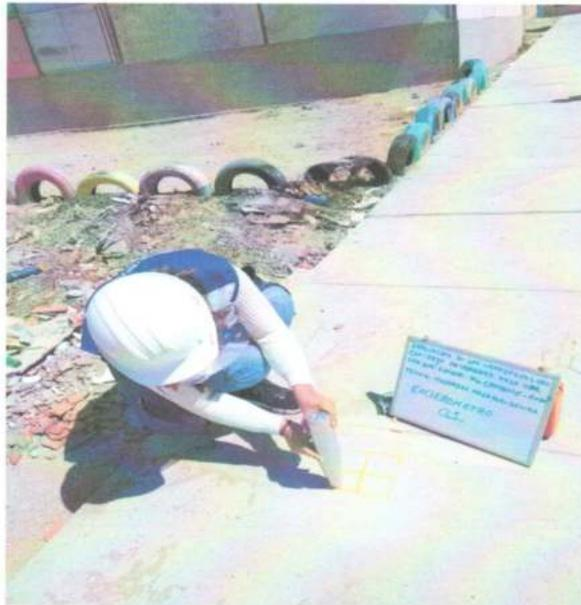
**IMAGEN 02: SE OBSERVA LA TESISTA REALIZANDO LECTURA CON EL ESCLEROMETRO EN VEREDA.**
