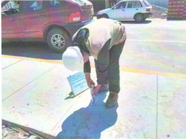
**IMAGEN 03: SE OBSERVA LA AL TECNICO REALIZANDO LECTURA CON EL ESCLEROMETRO EN VEREDA.**
