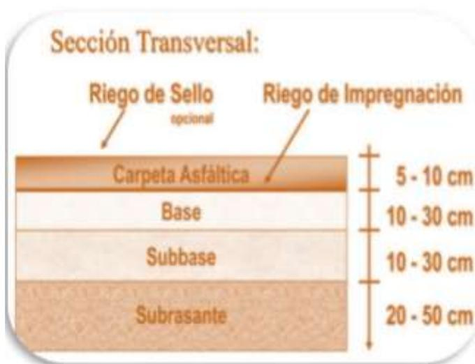
figura 1: sección transversal pavimento
