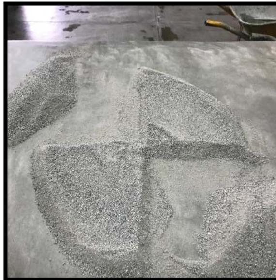
**Figura 74.** Cuarteo Agregado fino reciclado
