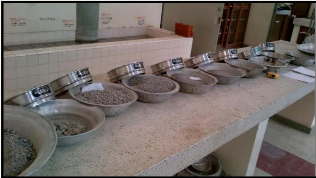
**Figura 81.** Serie de tamices con los cuales se realizó la granulometría a los agregados.
