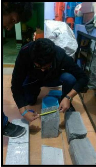
**Figura 59.** Determinación de altura promedio en la cara de fractura de la vigueta de concreto
