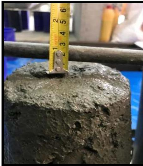
**Figura 76.** Ensayo en concreto fresco (Asentamiento) Agregado Fino Reciclado 15%
