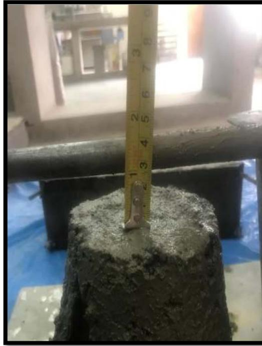
**Figura 77.** Ensayo en concreto fresco (Asentamiento) Agregado Fino Reciclado 25%
