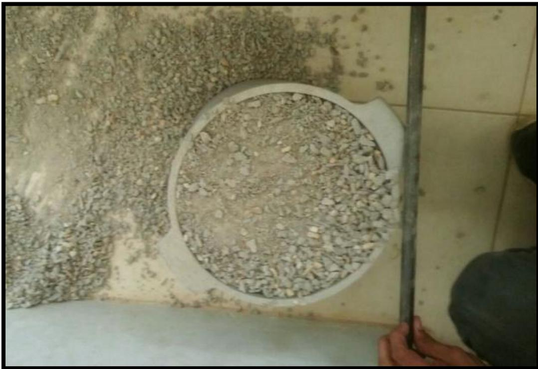
**Figura 68.** Se realizó el ensayo de peso unitario a los agregados de concreto reciclado
