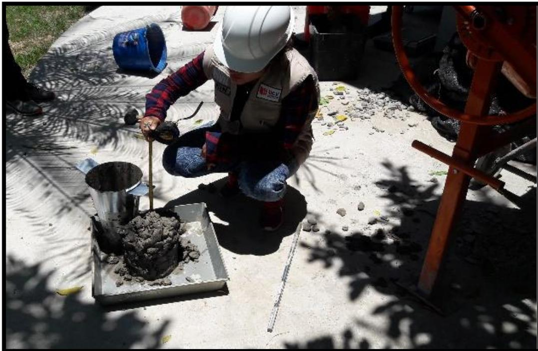
**Figura 70.** Diseño de mezcla que se está realizando.
