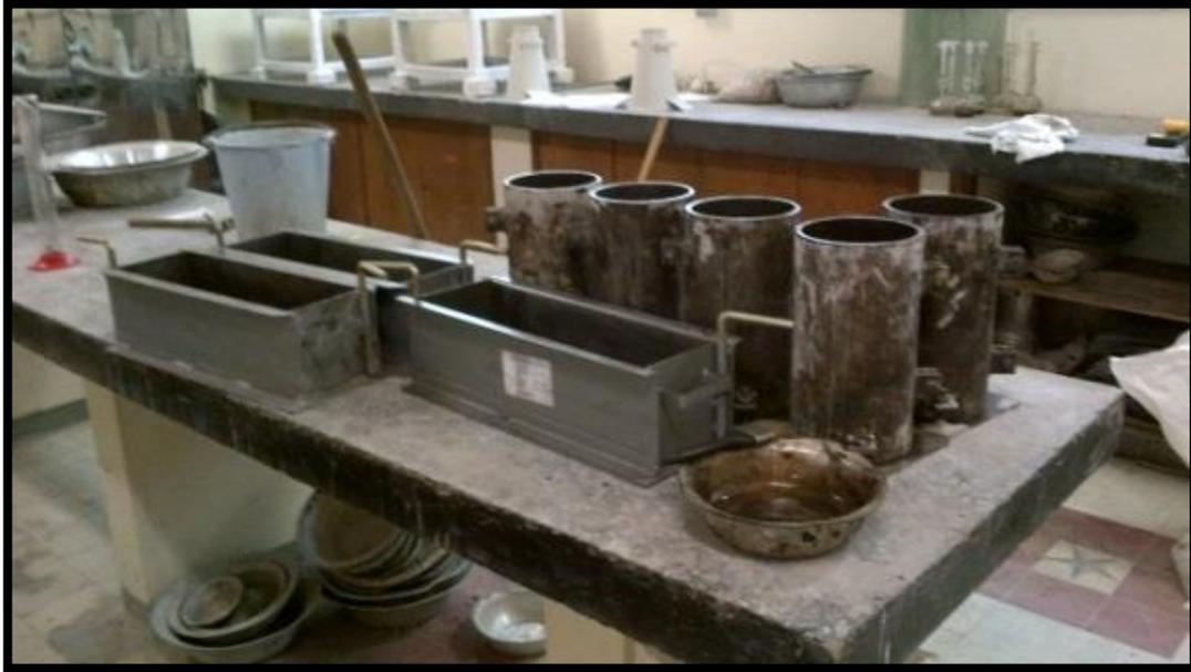
**Figura 83.** Formaletas para vigas y cilindros debidamente preparadas.
