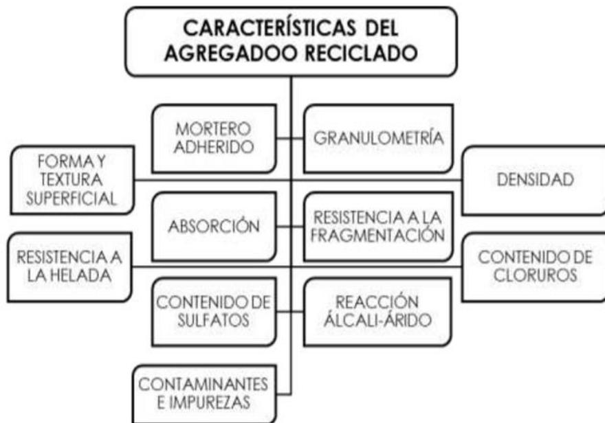
Figura 6. Características del agregado reciclado
