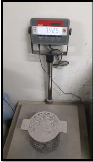
**Figura 39.** Pesaje de agregado fino reciclado compactado
