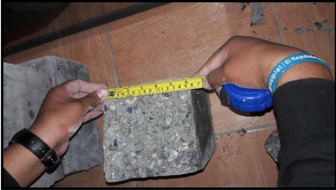
**Figura 53.** Determinación de ancho promedio en la cara de fractura de la vigueta de concreto
