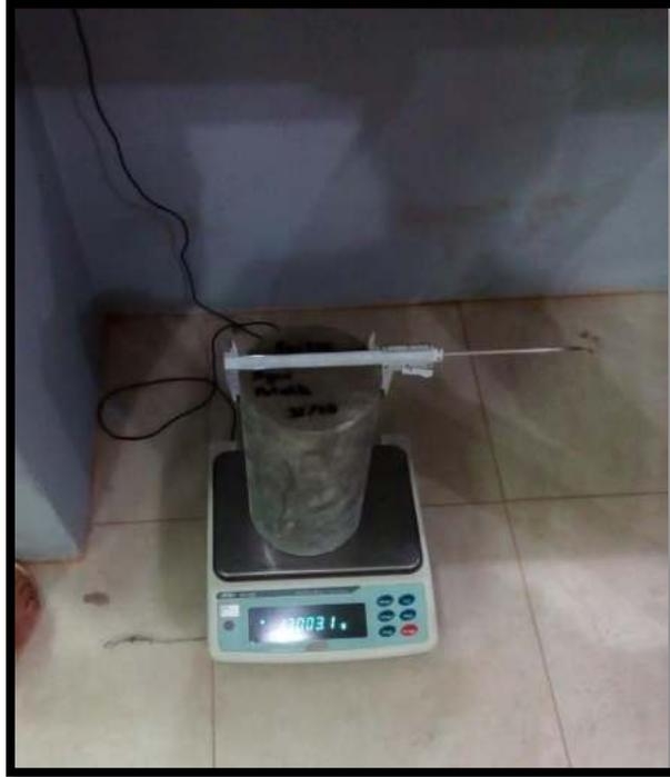
**Figura 71.** Datos del diámetro y peso de la probeta.
