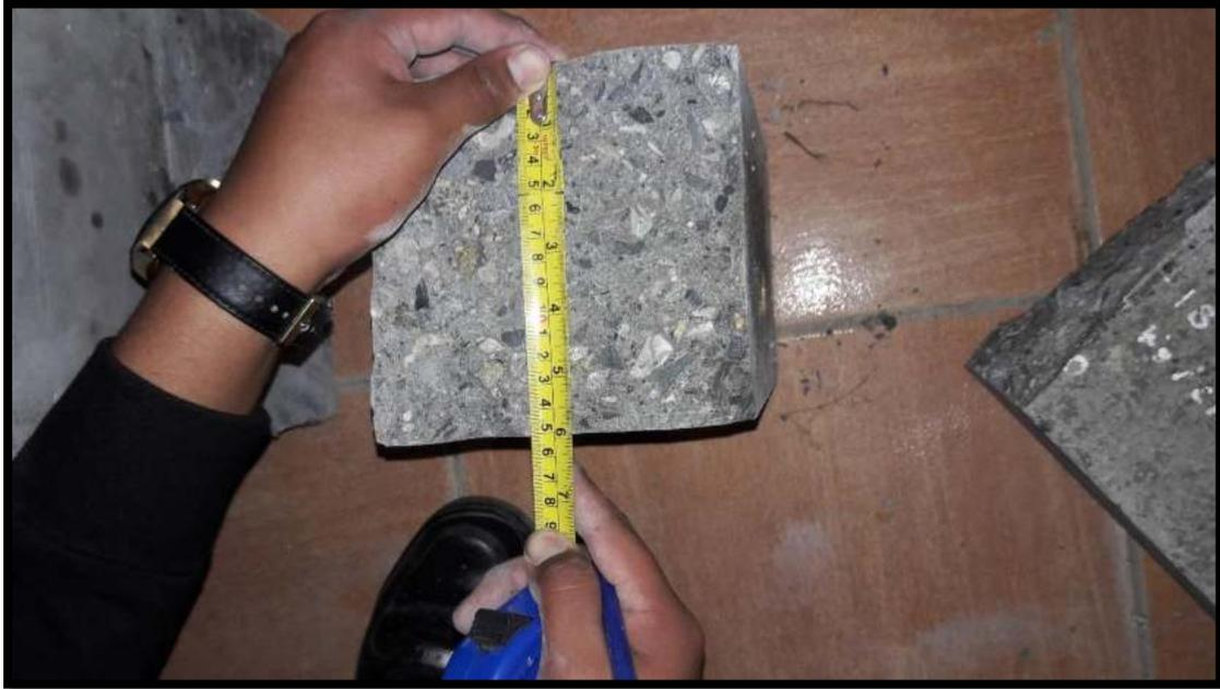
**Figura 57.** Determinación de altura promedio en la cara de fractura de la vigueta de concreto
