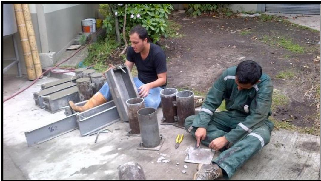
**Figura 86.** Desencofrado de probetas.
