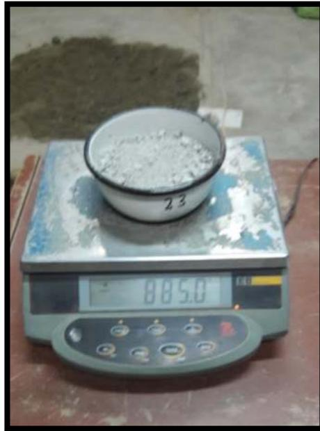
**Figura 37.** Peso de agregado fino reciclado húmedo
