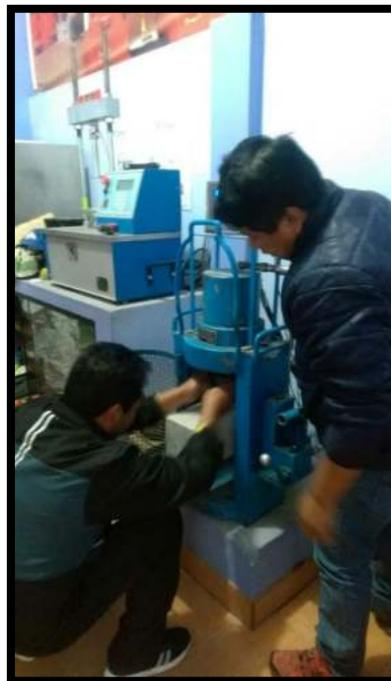
**Figura 60.** Colocación de la vigueta en la máquina
