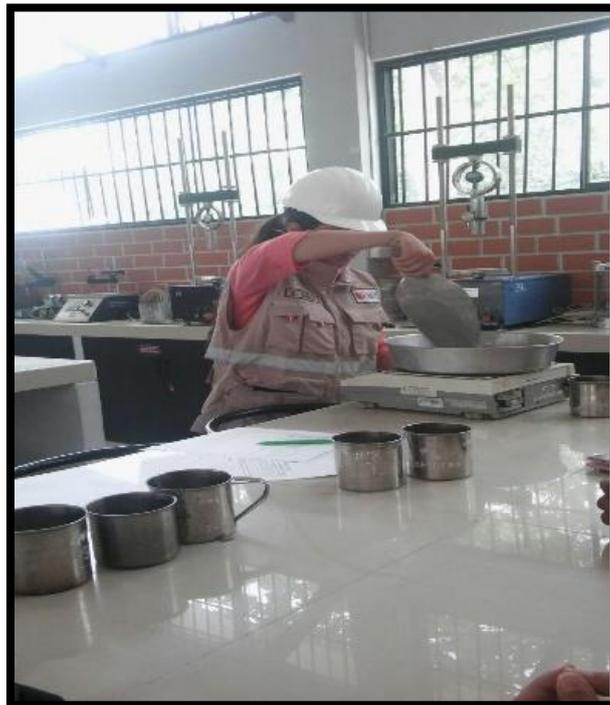
**Figura 64.** Se realiza ensayos de contenido de humedad
