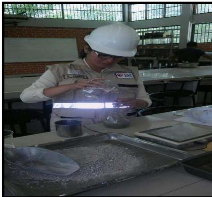
**Figura 66.** Se está realizando el ensayo de absorción de agregado fino
