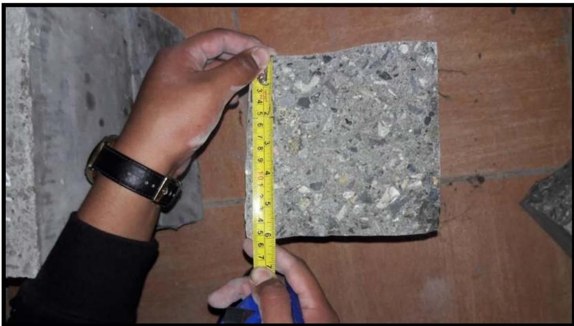
**Figura 56.** Determinación de altura promedio en la cara de fractura de la vigueta de concreto
