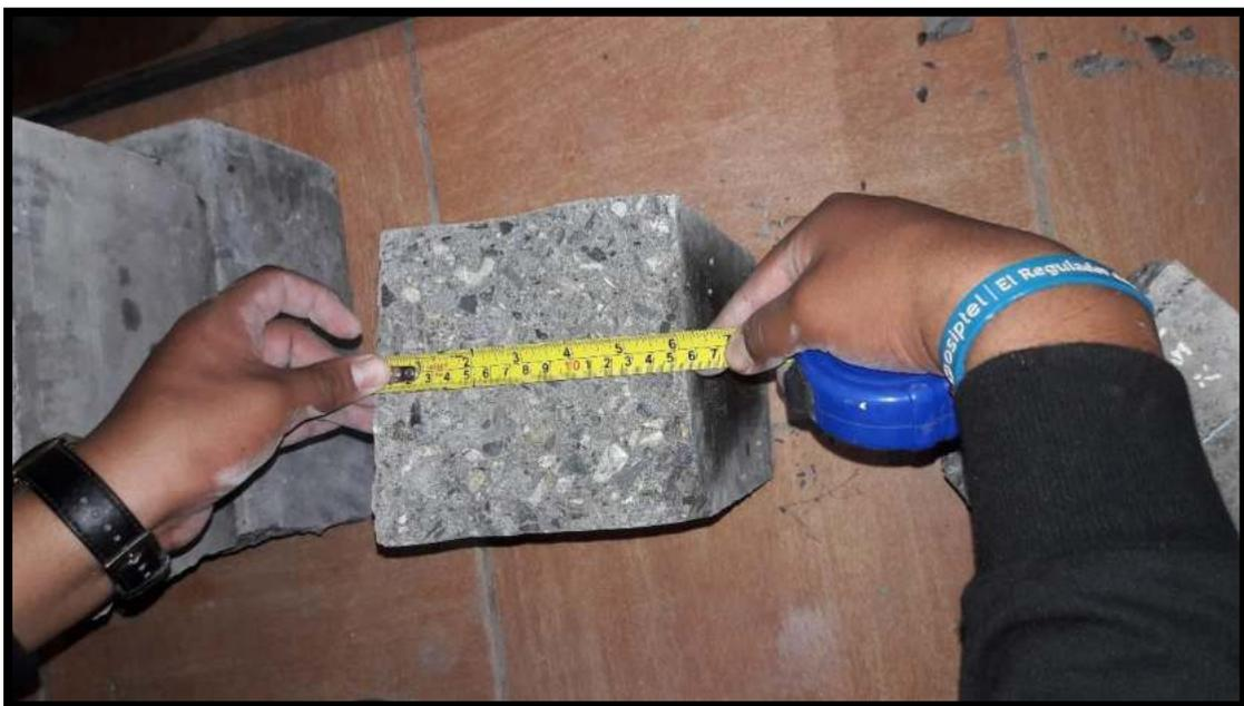
**Figura 54.** Determinación de ancho promedio en la cara de fractura de la vigueta de concreto
