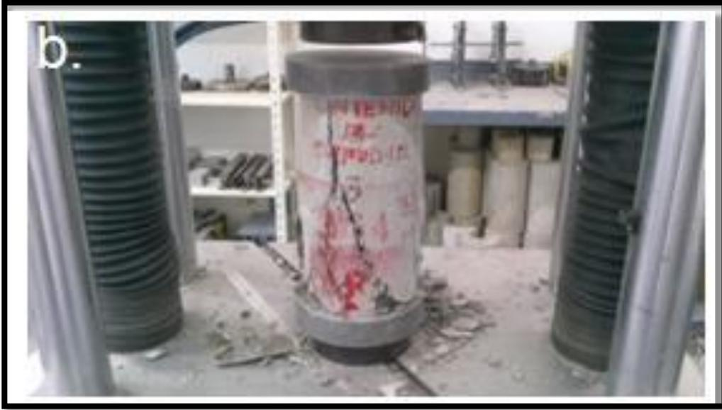
**Figura 89.** Cilindro con falla tipo 4 (b)
