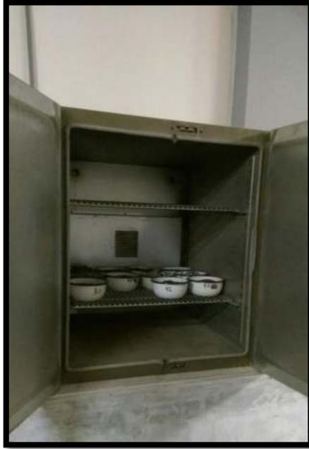
**Figura 41.** Secado de agregados en horno para análisis de porcentaje de absorción
