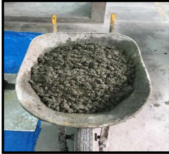
**Figura 75.** Concreto con Agregado fino Reciclado
