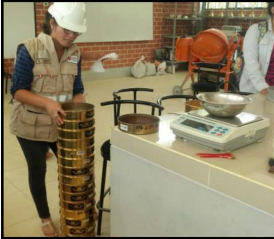
**Figura 65.** Se efectúa el ensayo de granulometría a los agregados reciclados
