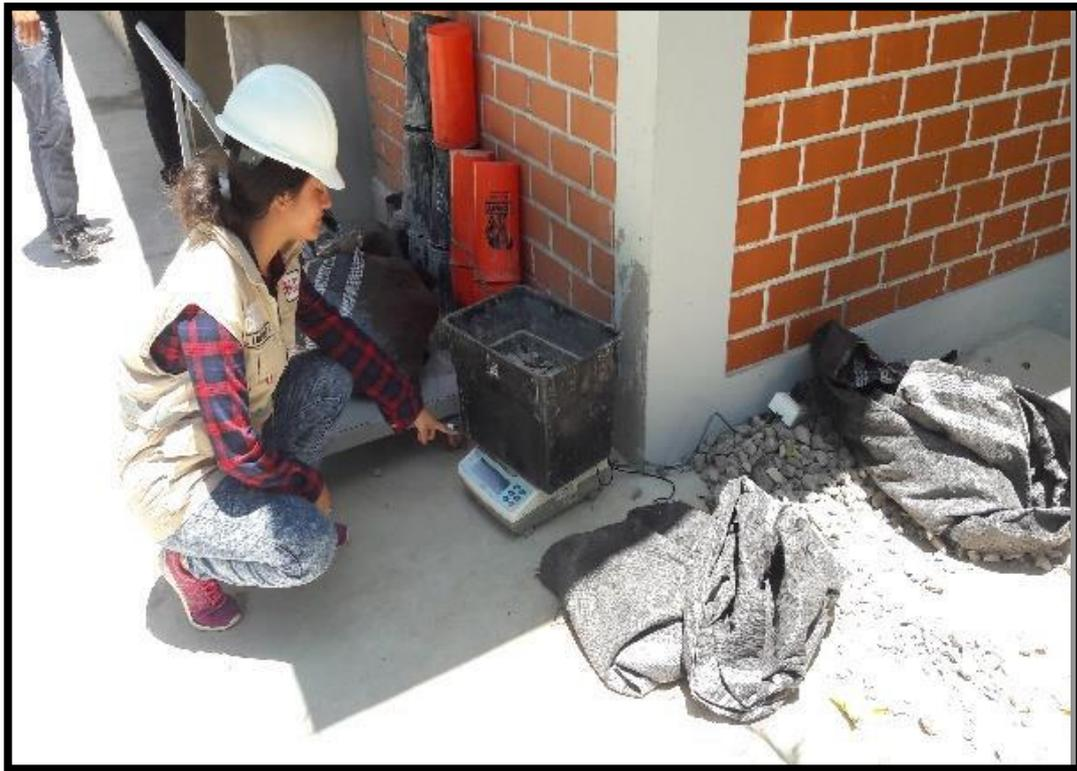
**Figura 69.** Peso de los materiales para la elaboración de las probetas
