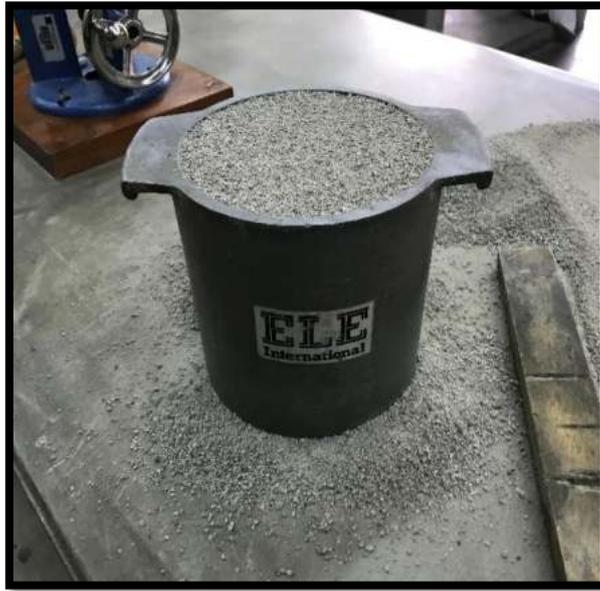
**Figura 73.** Peso Unitario de Agregado fino reciclado
