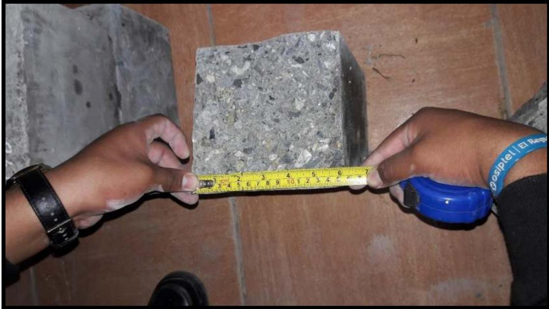
**Figura 55.** Determinación de ancho promedio en la cara de fractura de la vigueta de concreto
