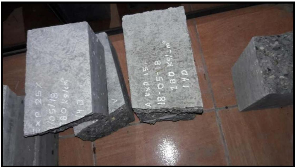
**Figura 52.** Viguetas sometidas a ensayo de determinación de resistencia a la flexión
