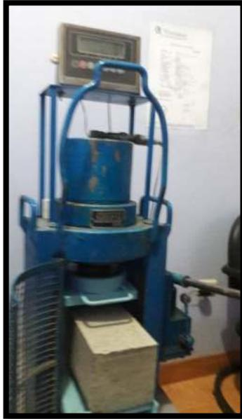
**Figura 49.** Máquina para ensayo de determinación de resistencia a la flexión
