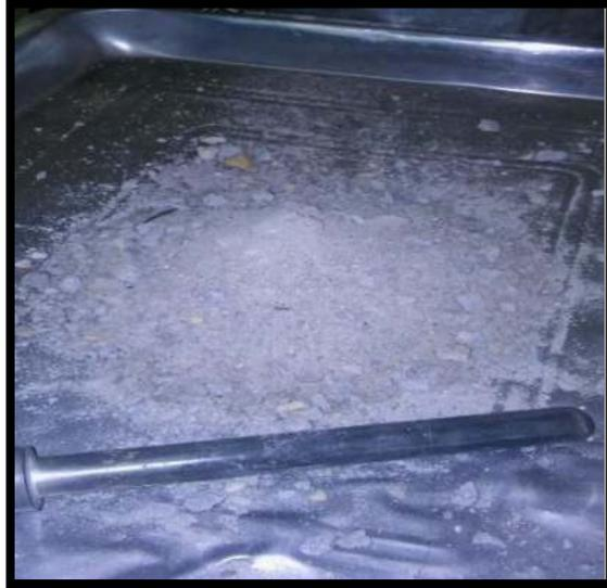
**Figura 67.** Se observa el material después de efectuarse los golpes en el cono de absorción
