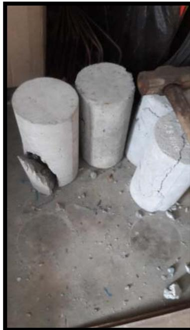
**Figura 42.** Briquetas de concreto  $f'c$  210kg/cm<sup>2</sup> para la obtención de agregado fino reciclado
