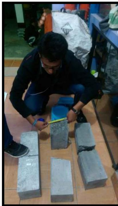
**Figura 58.** Determinación de altura promedio en la cara de fractura de la vigueta de concreto
