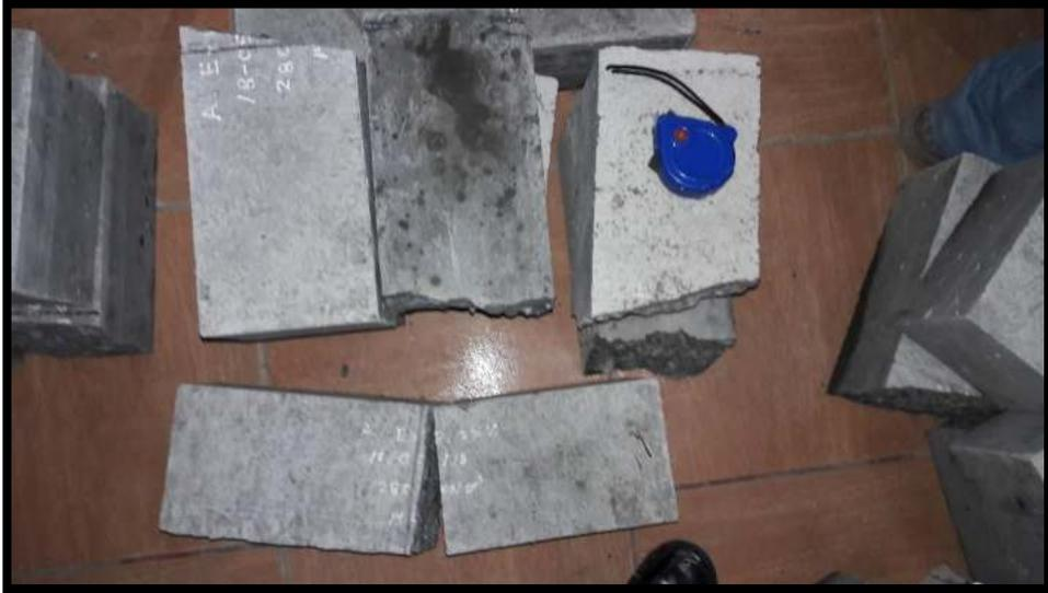
**Figura 51.** Viguetas sometidas a ensayo de determinación de resistencia a la flexión
