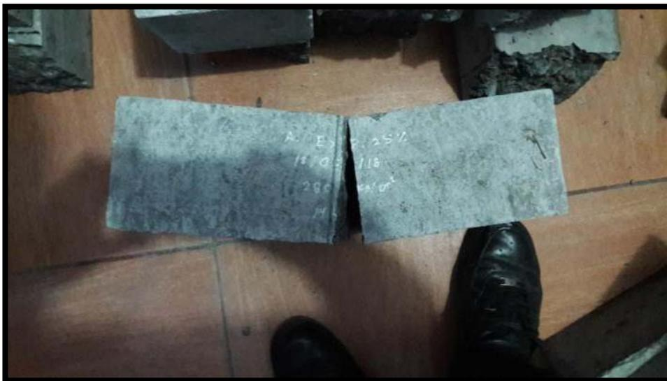
**Figura 50.** Vigueta de concreto con 25% de agregado reciclado después del ensayo de determinación de resistencia a la flexión
