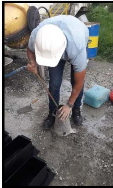
**Figura 44.** Varillado de concreto (3 capas de 25 varilladas cada una)
