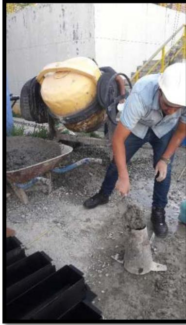
**Figura 43.** Llenado de concreto en el cono de Abrams
