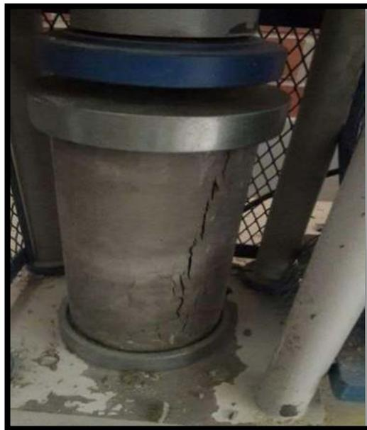
**Figura 72.** Reacción de la probeta al ser sometida a cargas para poder analizar porcentaje de resistencia de diseño
