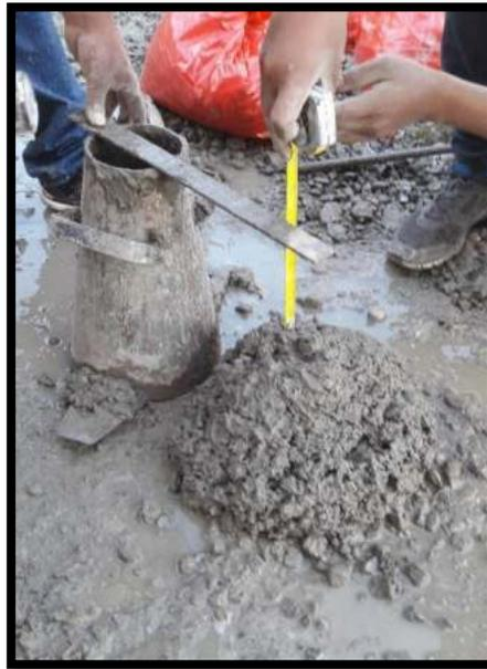
**Figura 45.** Prueba de revenimiento del concreto (Slump de 3" a 4")
