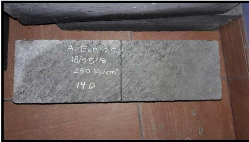
**Figura 47.** Vigueta de concreto con 25% de agregado reciclado
