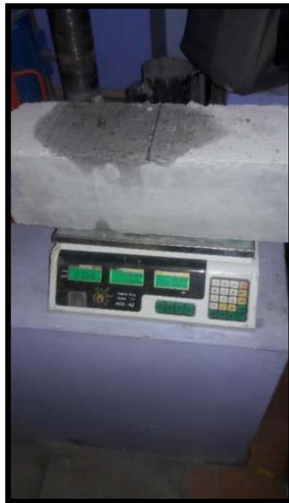
**Figura 48.** Peso de una vigueta de concreto
