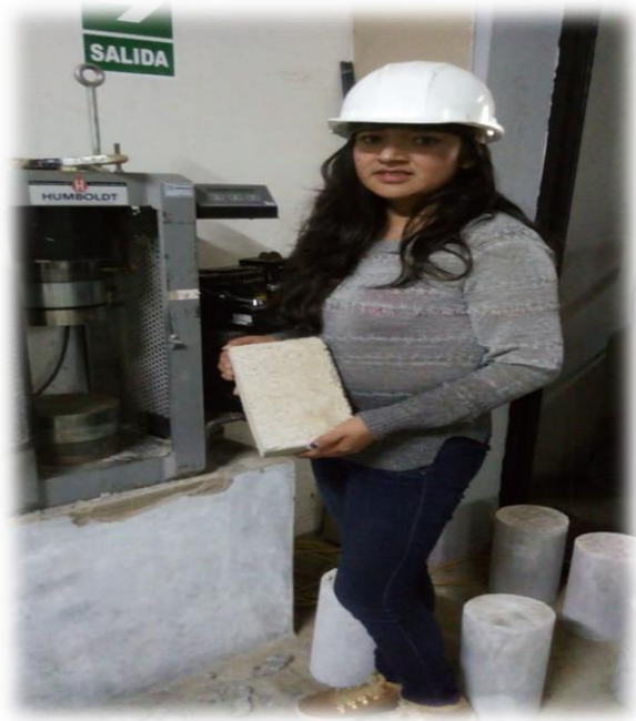
Figura 20. Ladrillos de concreto patrón y experimental sometidos a la resistencia de compresión.
