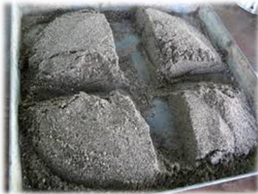
Figura 10. Haciendo el cuarteo del agregado fino.
