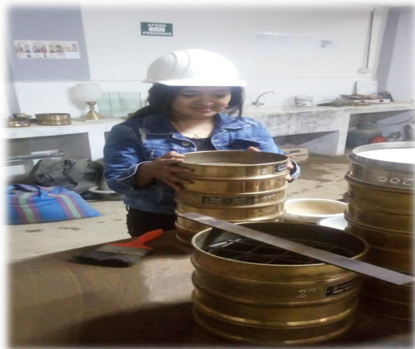
Figura 11. Realizando el tamizado de arena fina.
