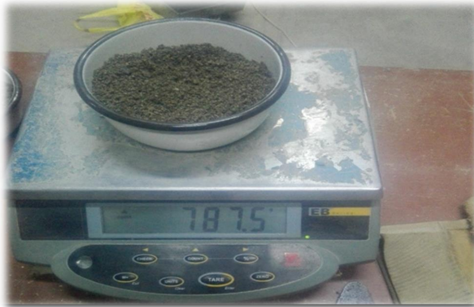
Figura 12. Determinando el peso de la muestra – agregado fino.
