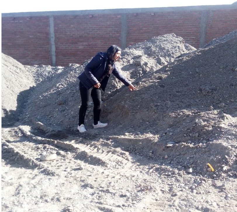
Figura 8. Agregado grueso para la elaboración de ladrillo de concreto (Tacllan).
