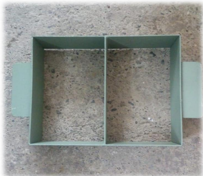
Figura 15. Moldes para la elaboración de ladrillo de concreto.
