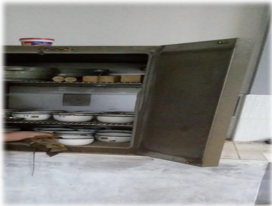
Figura 13. Llevando el agregado fino al horno 24h de secado.
