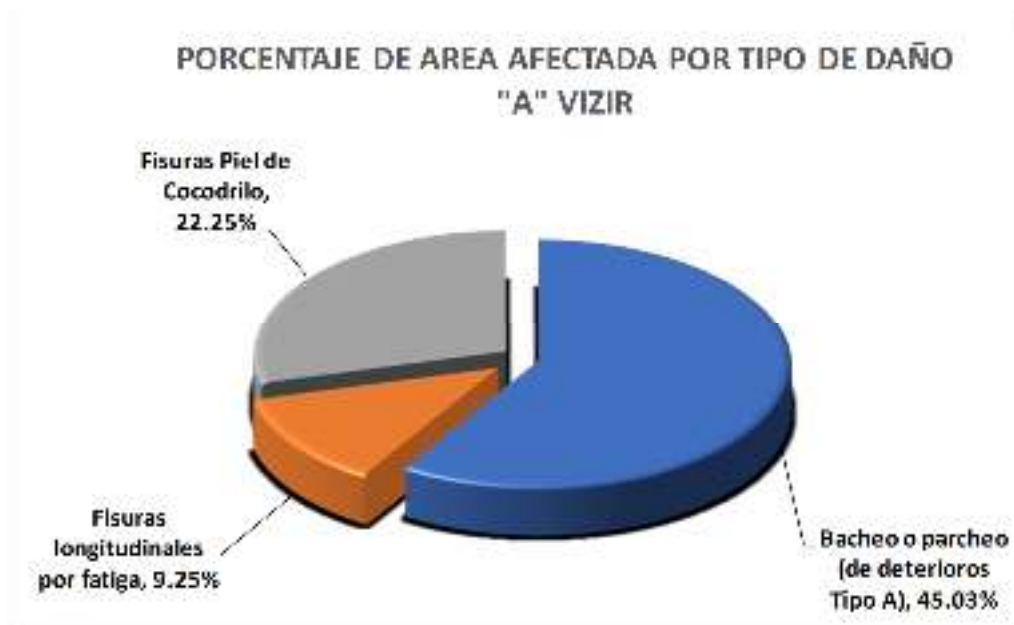
Figura 3. Área afectada por tipo de daño A.
