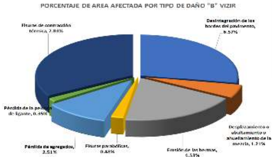
Figura 4. Porcentaje de daños de tipo estructural del Área afectada por daño de tipo B.
