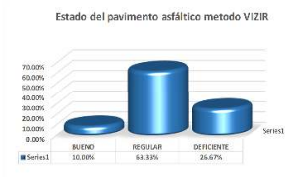
Figura 5. Porcentaje del Estado del pavimento método VIZIR.
