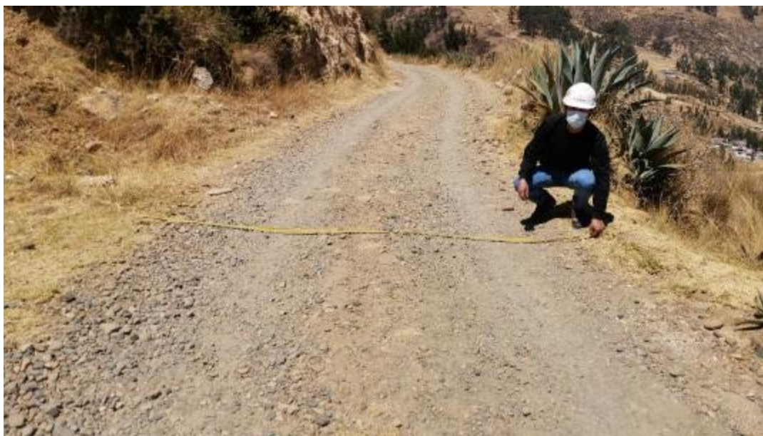
Figura 48: Unidad de muestra N°4 (prog. 1+630 km – 1+720 km). Unidad de muestra N°4. Longitud 90 m, considerando ancho de calzada 4 m y área 360 m 2 de acuerdo a la metodología URMM.
