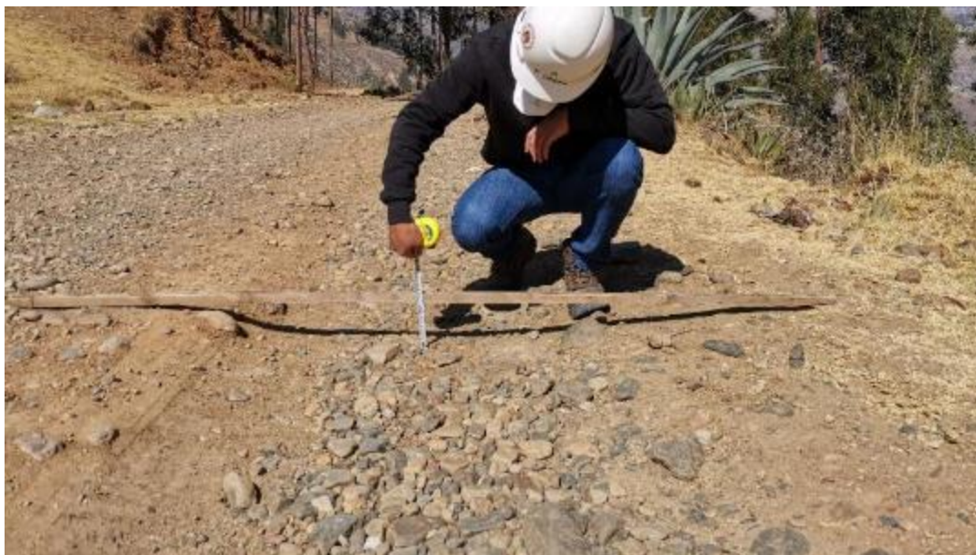
Figura 57: Unidad de muestra N°5 (prog. 2+030 km – 2+095 km). Falla 85 (Baches) según tabla 6 (Nivel B), de cantidad 30.
