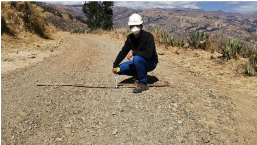
Figura 54: Unidad de muestra N°5 (prog. 2+030 km – 2+095 km). Falla 81 (Sección Transversal Incorrecta) según tabla 6 (Nivel B), de longitud 55m.
