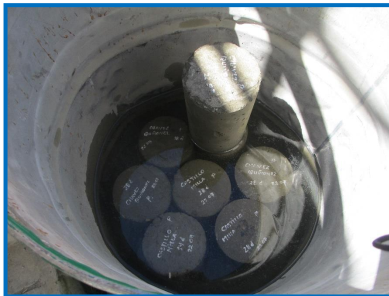
Figura 65: Curado de especímenes de concreto Fuente: (Chavez, 2018)
