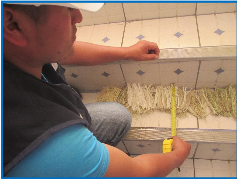
Figura 60: Corte y medición de la fibra de agave con longitud de 10cm. Fuente: (Chavez, 2018)
