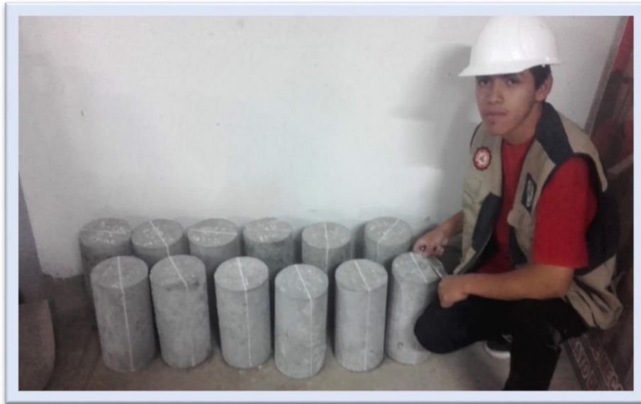
Figura 36 Marca geometrica para la prueba de resistencia a tracción (Traccion indirecta)
