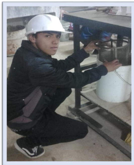
Figura 31 Medicion de pesos unitarios de grava
