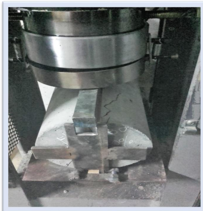
Figura 41 Fisura del concreto adicionando 6% de fibra de alambre galvanizado
