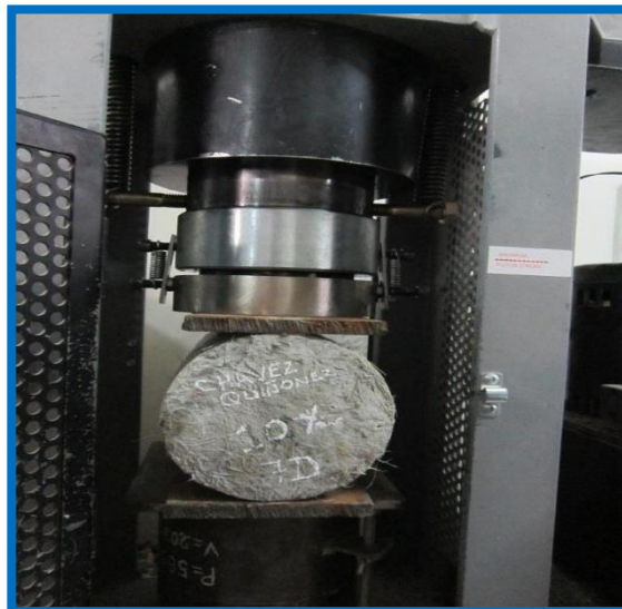
Figura 67: Rotura tracción diametral de la probeta experimental con 10% de fibra de agave.
