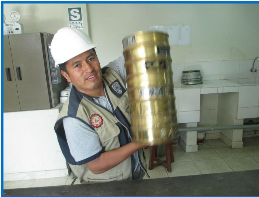
Figura 61: Tamizado de los agregados. Fuente: (Chavez, 2018)
