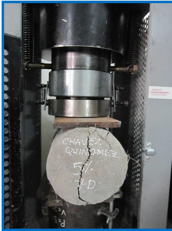
Figura 66: Falla por tracción diametral de la probeta experimental con 5% de fibra de agave.
