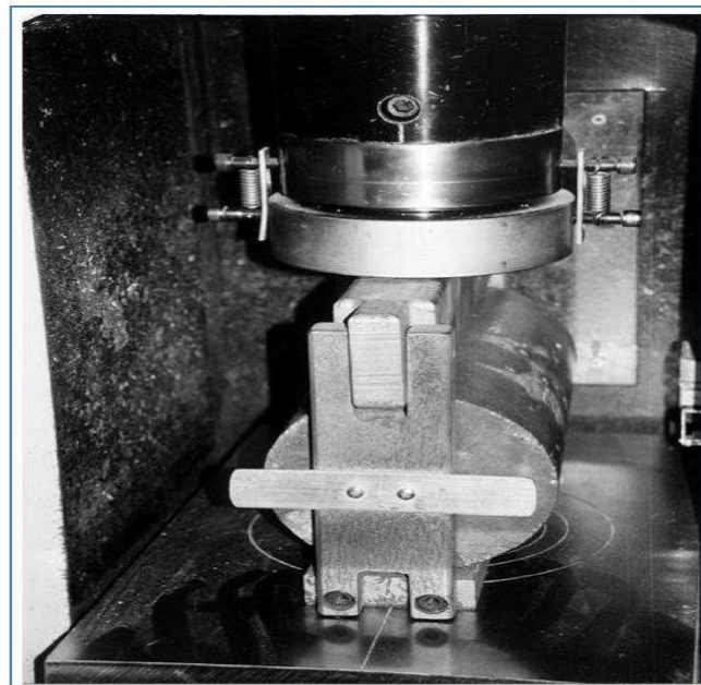
Figura 3. Cilindro colocado para ensayo de tensión indirecta
