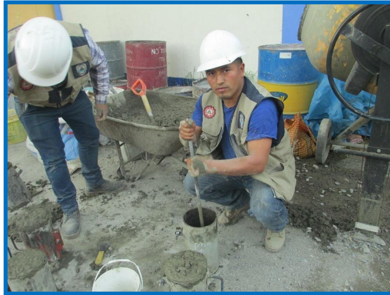
Figura 64: Elaboración de las probetas de concreto Fuente: (Chavez, 2018)
