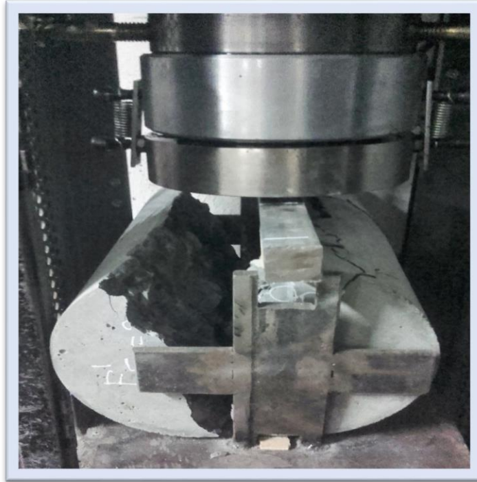
Figura 40 Rotura del concreto Patrón F'c = 280 \text{ kg/cm}^2
