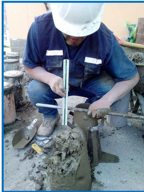
Figura 63: Ensayo de asentamiento del concreto “Slump”
