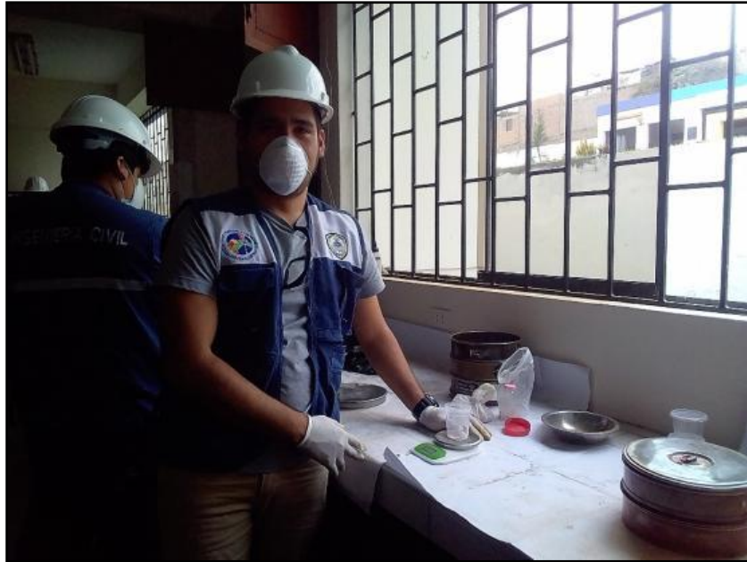
Foto 07. Mi persona usando correctamente los EPP, pesando polvo de concha de abanico para ensayo de análisis térmico diferencial.
