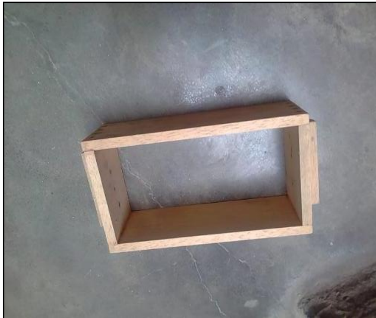
Foto 12. Molde o gavera de madera de \frac{1}{2} " de grosor, de dimensiones según norma para ladrillos King Kong las cuales es de 23 x 13 x 9 cm.
