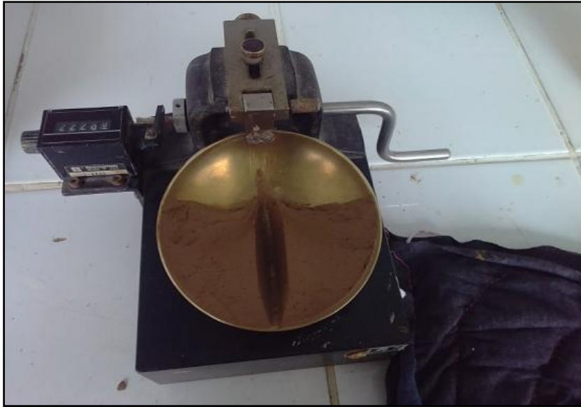
Foto 05. Ensayo de límite líquido al suelo arcilloso en el instrumento copa de Casagrande del laboratorio de Suelo.
