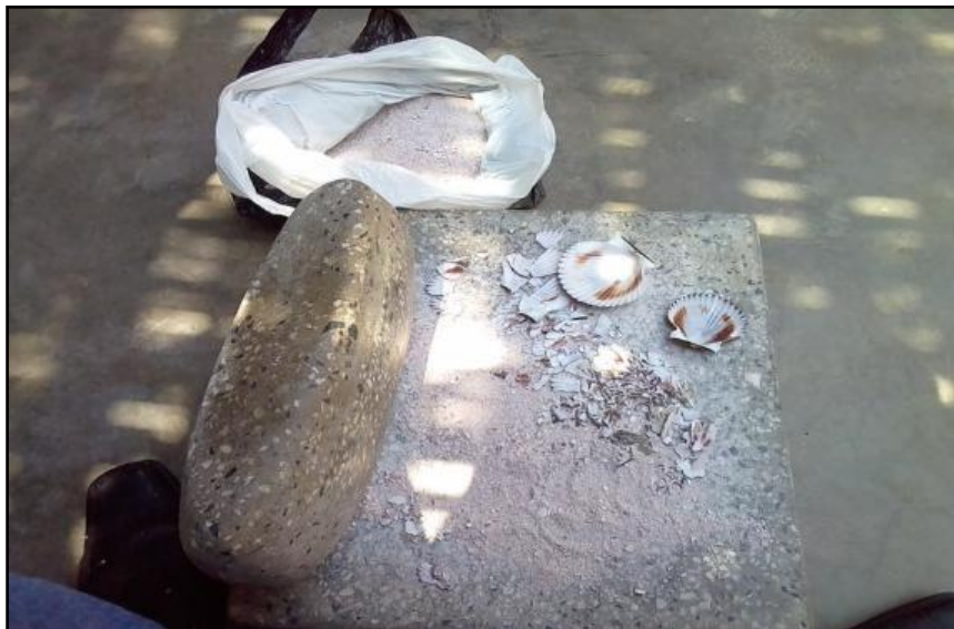
Foto 04. Triturado y molienda de las valvas de la concha de abanico usando un batan de piedra rustico y una piedra pesada.
