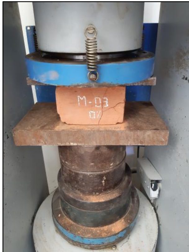
Foto 16. Ladrillos de arcilla debidamente rotulados sometidos a cargas en la compresora hidráulica del laboratorio.
