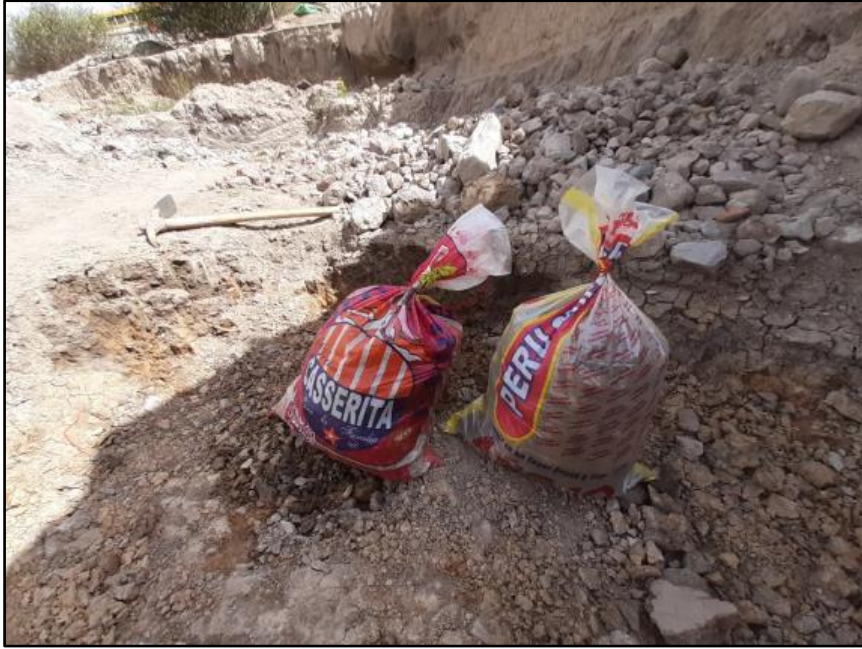
Foto 01. Extracción de arcilla de un yacimiento en una ladrillera del pueblo de Yuracoto, Caraz.
