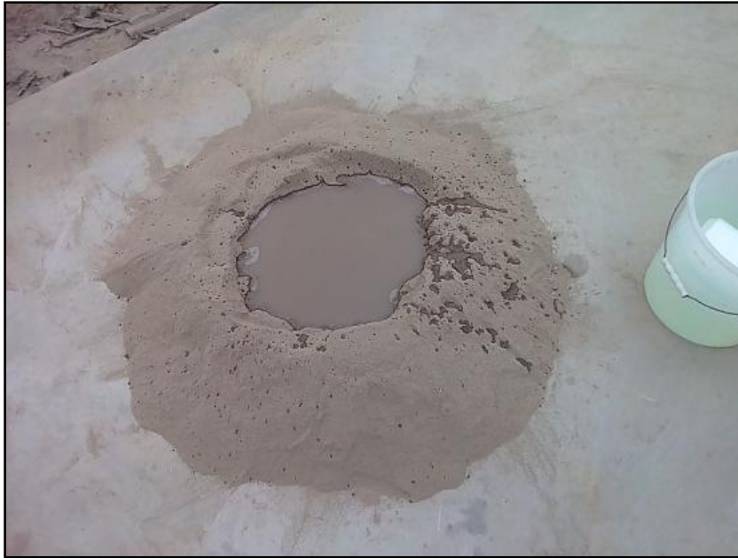
Foto 11. Vertido de agua en la depresión que se hizo en la mezcla de arcilla y tierra del ladrillo.
