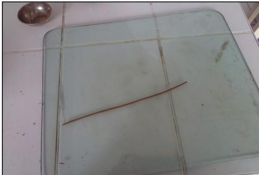
Foto 06. Ensayo de límite plástico al suelo arcilloso usando una base de vidrio limpia para formar cilindros.
