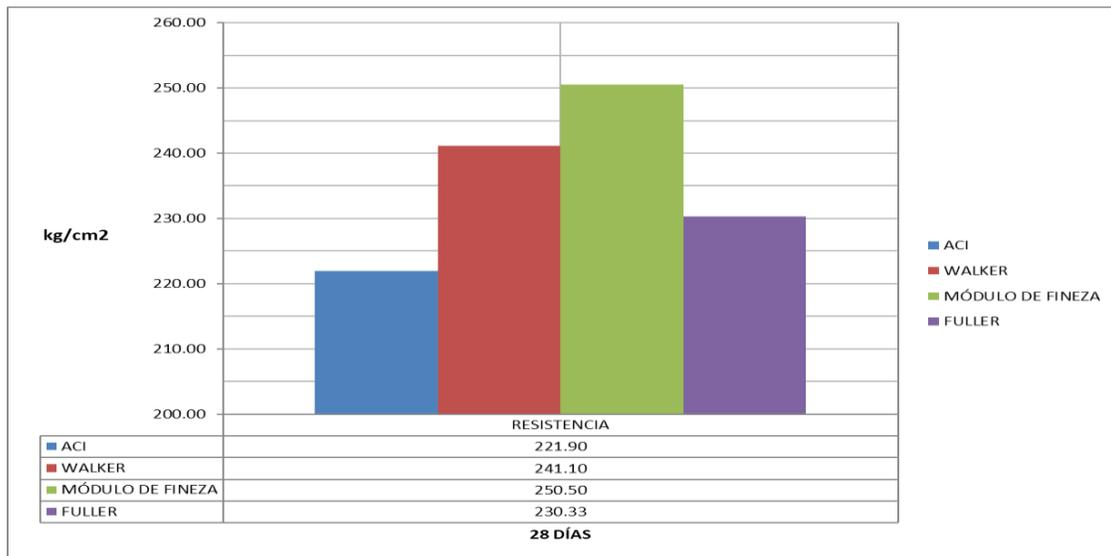
*Figura 27: Resistencias Promedios de los Concretos por cada Método*
