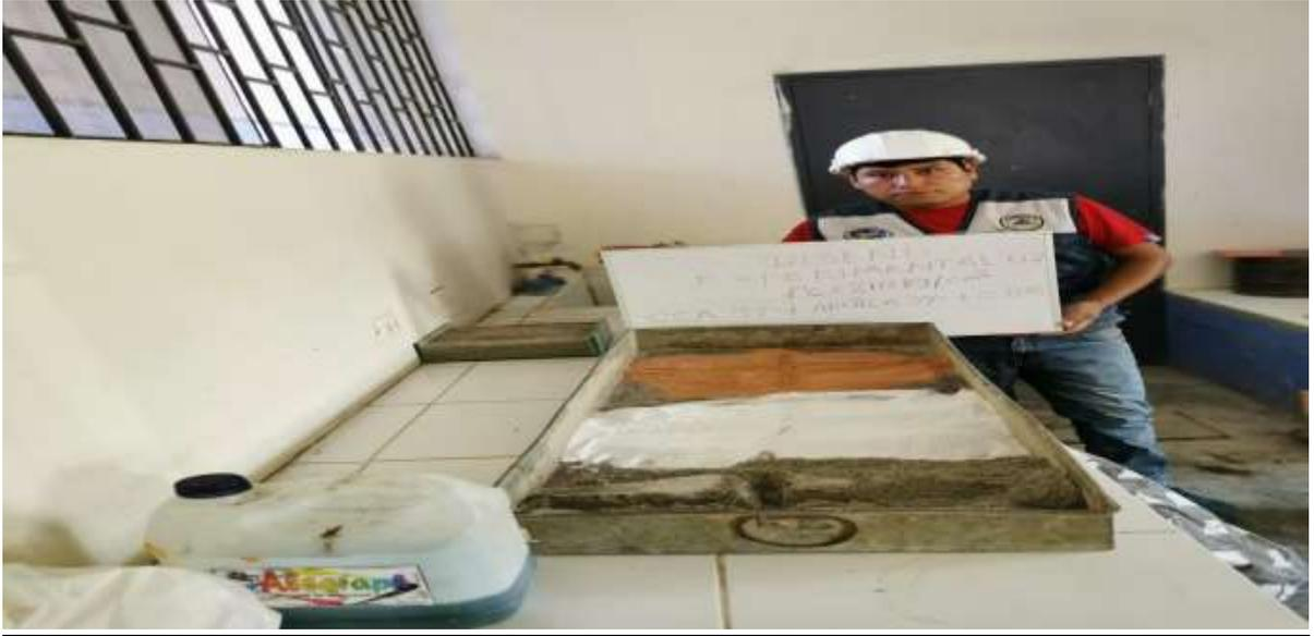
**Figura 119:** Procedemos a mezclar el cemento con nuestra sustitución al 12% por ceniza de concha de abanico y arcilla de Quitarcasa
