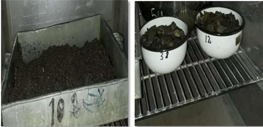
**Figura 89y90:** Arena: La muestra se procede a tamizar (Malla N°4) para que las partículas puedan ser introducidos en la fiola.
