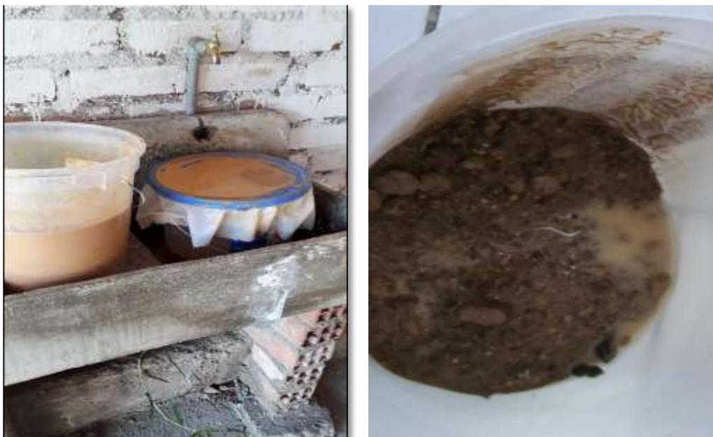
**Figura 13y14:** Ya completamente disuelta se coló la arcilla haciendo uso se la tela organza para retener la arena y piedras pequeñas.
