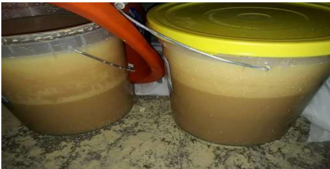
**Figura 15:** El material que pasó la tela organza se hecho en dos baldes transparentes de 16Lt juntamente con agua. Se dejó reposar 24 horas para facilitar que se separe los limos y la arcilla.
