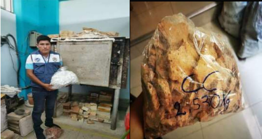
**Figura 21y22:** La arcilla se calcino a temperatura de 550° por 2horas, en la mufla de la UNT, En la muestra N°1 Se ingreso al horno 1.500Kg de Arcilla lo cual hubo perdida del 20%, reduciendo a su peso final en 1.200Kg de arcilla, En la muestra N°2 Se ingreso al horno 1.500Kg de Arcilla lo cual hubo perdida del 20%, reduciendo a su peso final en 1.200Kg de arcilla.
