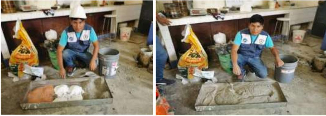
**Figura 112y113:** Procedemos a colocar nuestro material de sustitución al 10%, 90% de cemento + 7.5% CCA + 2.5% Arcilla, luego procedemos a combinarlo para tener nuestro cemento sustituido al 10%.
