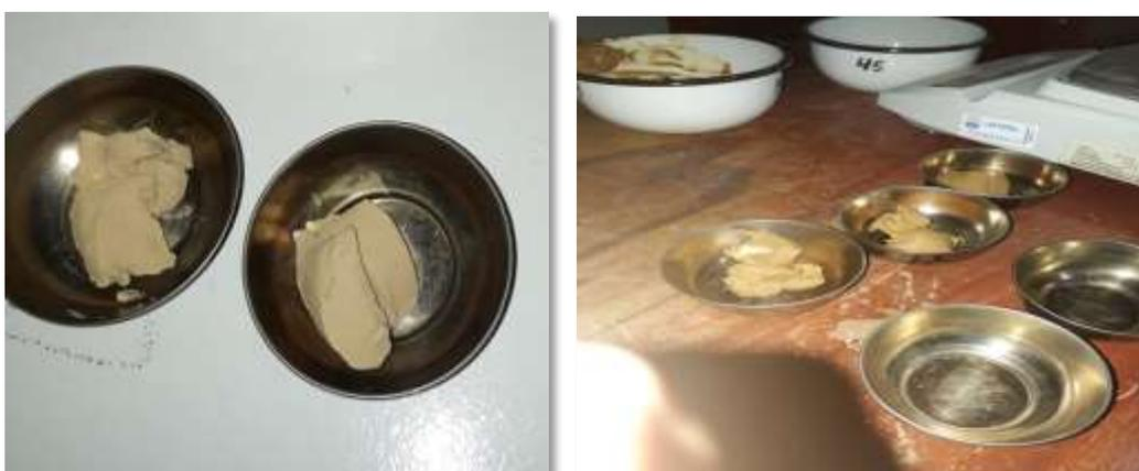
**Figura 32y33:** Poner en movimiento la cazuela con ayuda de la manivela y suministrar los golpes que sean necesarios para cerrar la ranura en 12.7mm (½ “). Cuando se cierre la ranura en ½”, registrar la cantidad de golpes y tomar una muestra de la parte central para la determinación del contenido de humedad. Este proceso se repite nuevamente con tres muestras más para lograr cuatro puntos a diferentes contenidos de humedad. Los siguientes rangos de golpes son los recomendados:
