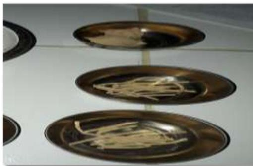
**Figura 37:** Una vez que se ha producido el límite plástico se debe colocar el rollito en un recipiente de peso conocido y se pesa para determinar el contenido de humedad.
