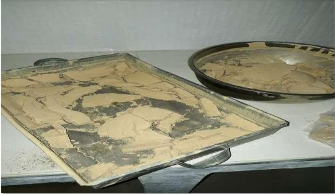
**Figura 19:** Para el secado de la arcilla se dejó secar a temperatura ambiente. Se hizo uso de recipientes protegidos para evitar el ingreso de polvo en los recipientes.
