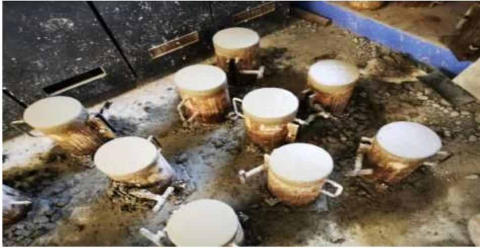
**Figura 117:** Por ultimo desencoframos al día siguiente pasando de 18 a 24 horas para ser desencofrado y pesar.
