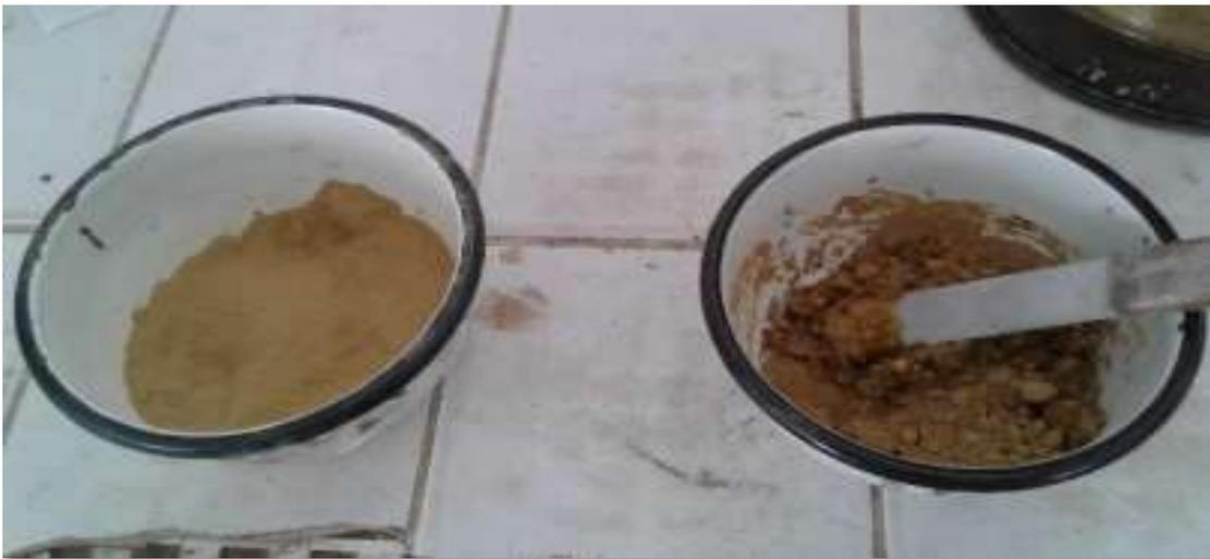
**Figura 29:** Colocar el suelo pasante malla No. 40 en una vasija de evaporación y añadir una pequeña cantidad de agua, dejar que la muestra se humedezca para posteriormente Mezclar con ayuda de la espátula hasta que el color sea uniforme y conseguir una mezcla homogénea. La consistencia de la pasta debe ser pegajosa.
