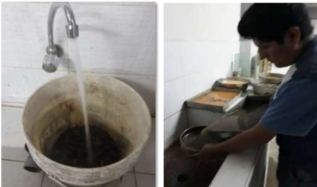
**Figura 87y88:** Colocación de la muestra en el recipiente y lista para ser dejada 24 horas en agua.
