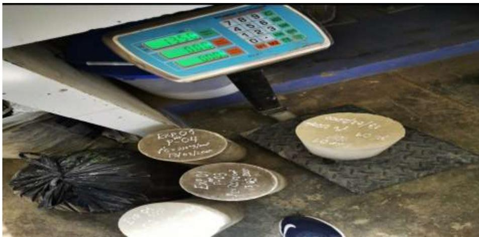
**Figura 118:** Procedemos a pesar nuestras probetas del experimental 01, después de haber sido desencofrado.
