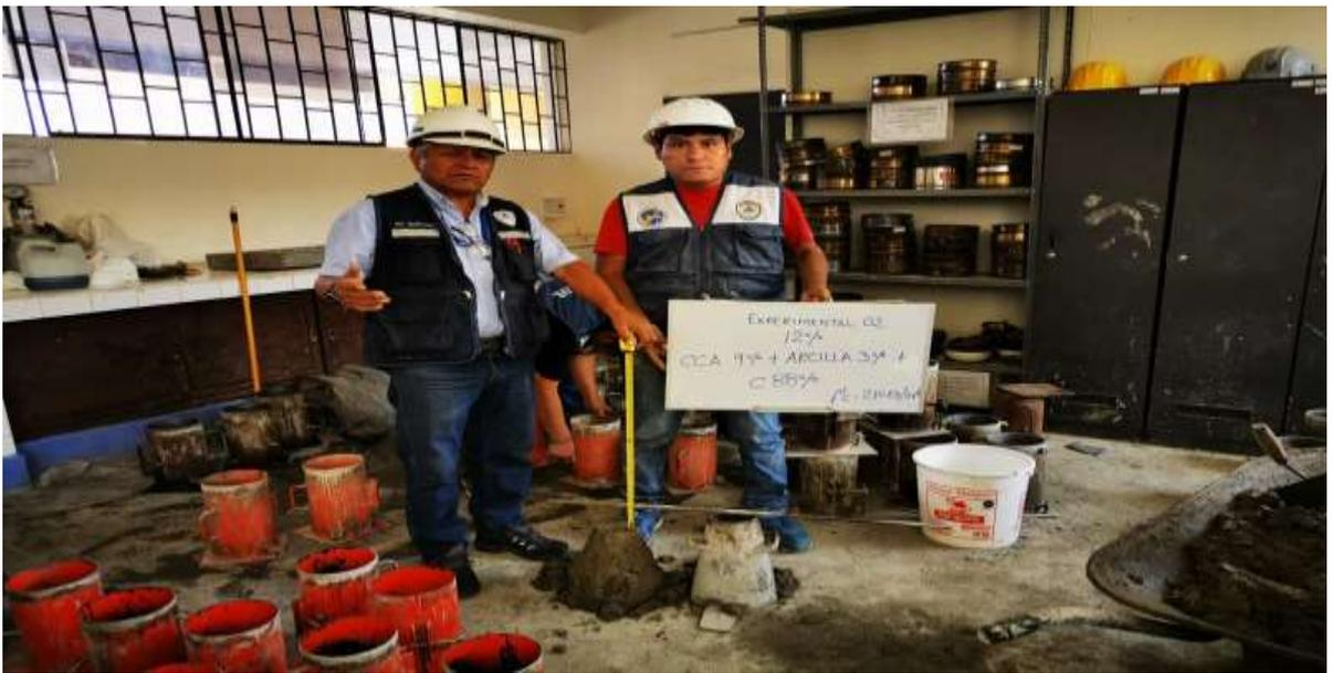
**Figura 120:** Procedemos a realizar en ensayo del SLUMP dando como resultado 3'' Lo cual está dentro de lo establecido.
