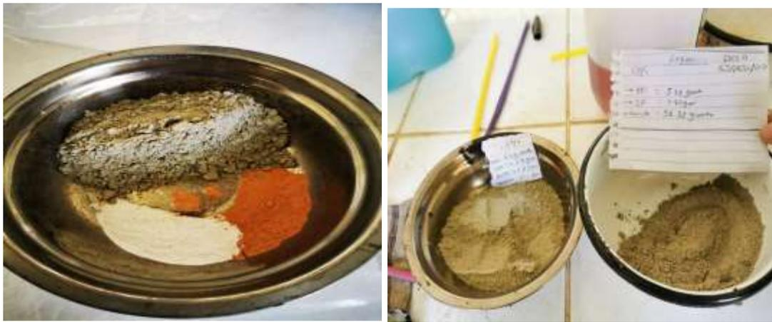
**Figura 58y59:** Se realiza la combinación para luego proceder a realizar el peso específico siguiendo los pasos anteriores
