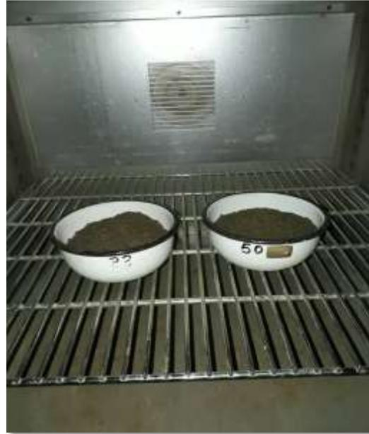
**Figura 63y64:** La muestra colocamos en el horno a una temperatura de  $105^{\circ}$ - $110^{\circ}$ C, por 24 horas (11:10 am- 11:10am)
