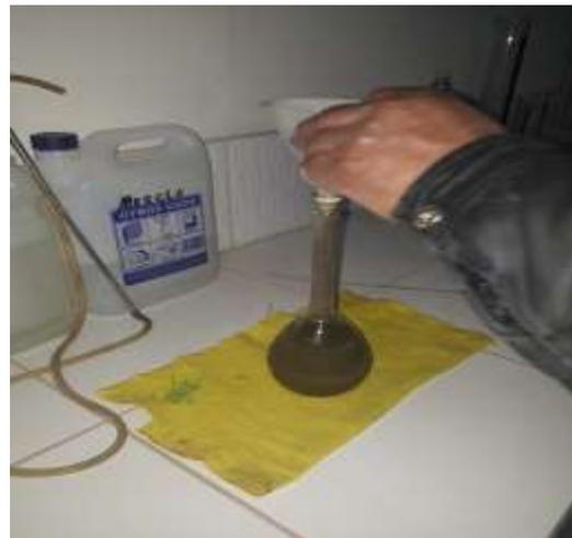
**Figura 95y96:** Para el ensayo de absorción del agregado fino Se utilizó 300 gr de la arena superficialmente seca.
