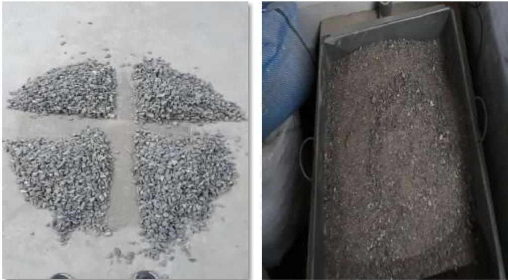
**Figura 60y61:** Seleccionamos una Porción de los Agregados en los recipientes para el ensayo respectivo.
