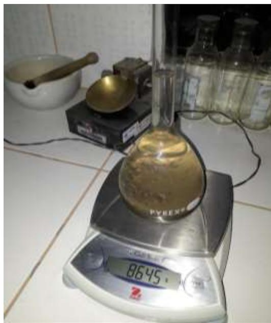
**Figura 98y99:** Después de retirar el aire se completó con el agua hasta alcanzar la marca que tiene la fiola, Luego se procedió a pesar la fiola + arena + agua
