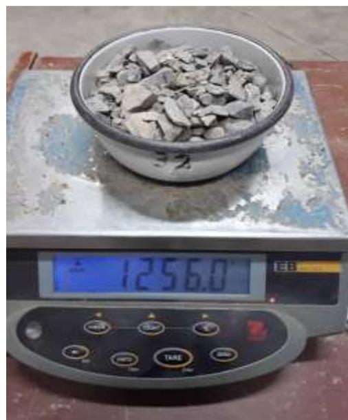
**Figura 65y66:** Procedemos a pesamos las muestras sacadas del horno.
