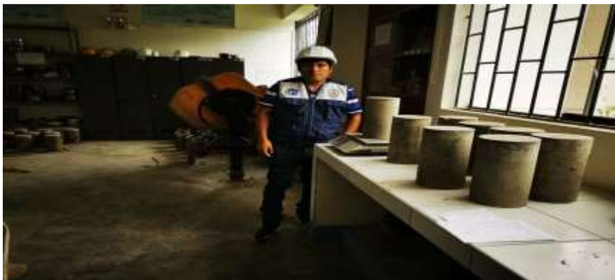
**Figura 107:** Se procede a desencofrar las probetas patrón para luego pesar cada una de ellas.
