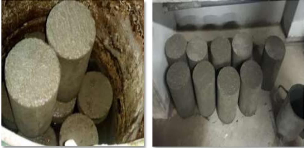
**Figura 108y109:** Las probetas se retiraron de los moldes entre las 18 y 24 horas después de moldeadas, para luego sumergirlas en agua para su curado.
