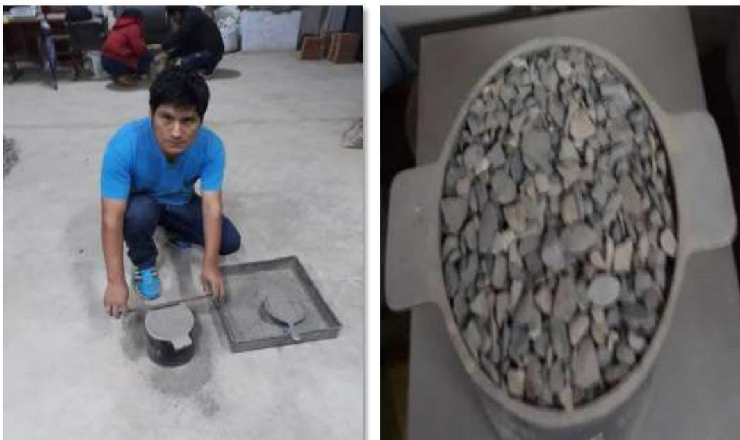
**Figura 81y82:** Con la varilla de acero se procede a eliminar las demasías del molde moviendo la varilla de un lado a otro en la parte superior del molde.
