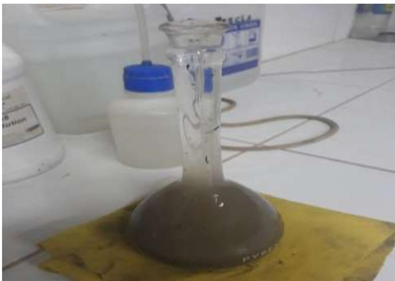
**Figura 97:** La muestra se movía suavemente durante 15 minutos para lograr retirar el aire atrapado en la fiola.
