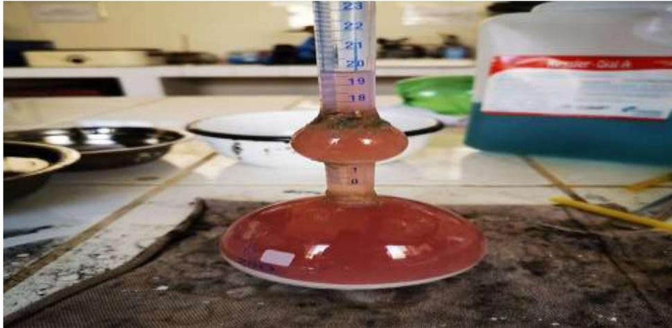
**Figura 56:** Colocar el tapón en el frasco y hacer girar éste en una posición inclinada o girarlo horizontalmente y suavemente en círculo, de tal manera de liberar de aire hasta que ya no exista escape de burbujas hacia la superficie.
