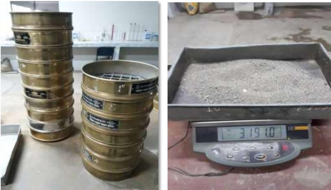
**Figura 102y103:** Obtenemos una cantidad óptima y procedemos a pesar la cantidad de agregado obtenido.
