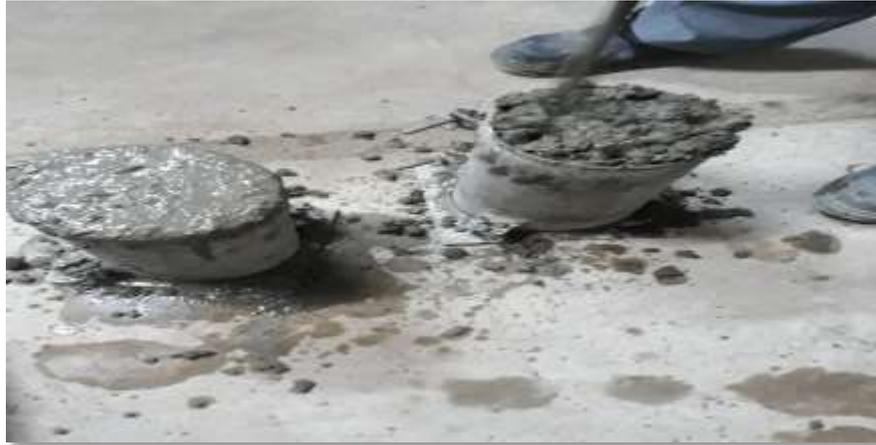
**Figura 106:** Luego del mezclado, se llena de inmediato el molde hasta un tercio de su altura, compactando a continuación con la barra mediante 25 golpes verticales. El proceso se repite en las 3 capas siguientes, de manera que la barra penetre hasta la capa precedente no más de 1". En la última, se coloca material en exceso, para enrazar a tope con el borde superior del molde, sin agregar material.
