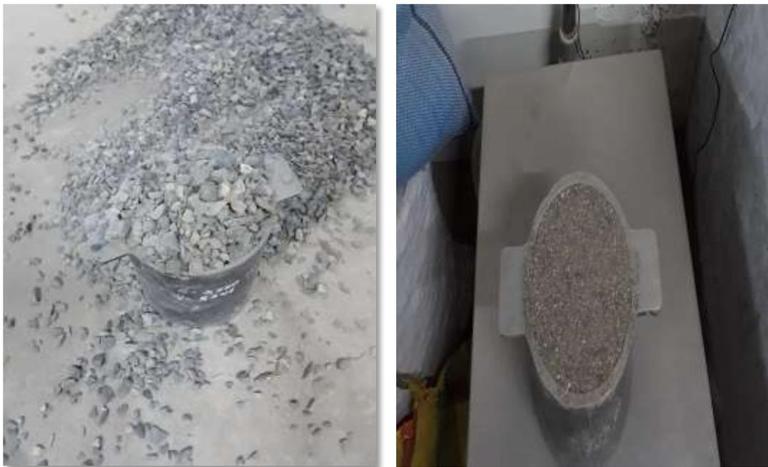
**Figura 79y80:** Llene el recipiente hasta el rebosamiento y varille como en las anteriores capas.
