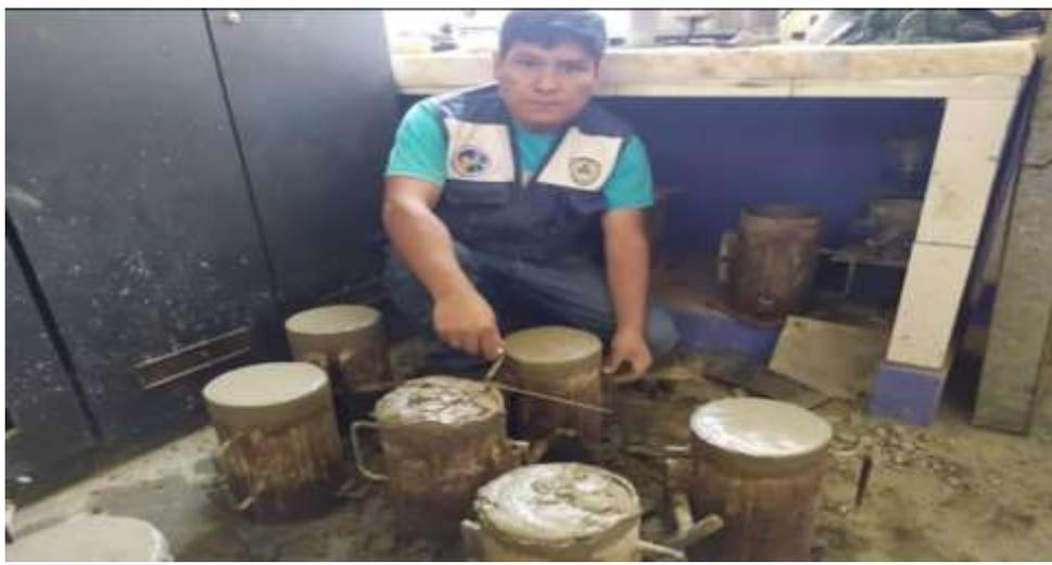
**Figura 116:** Procedemos a llenar los moldes de probeta con la mezcla, compactando con los 25 golpes verticales
