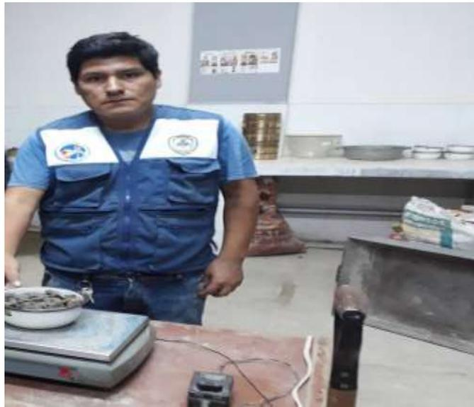
**Figura 62:** Pesamos las muestras del agregado fino y agregado grueso
