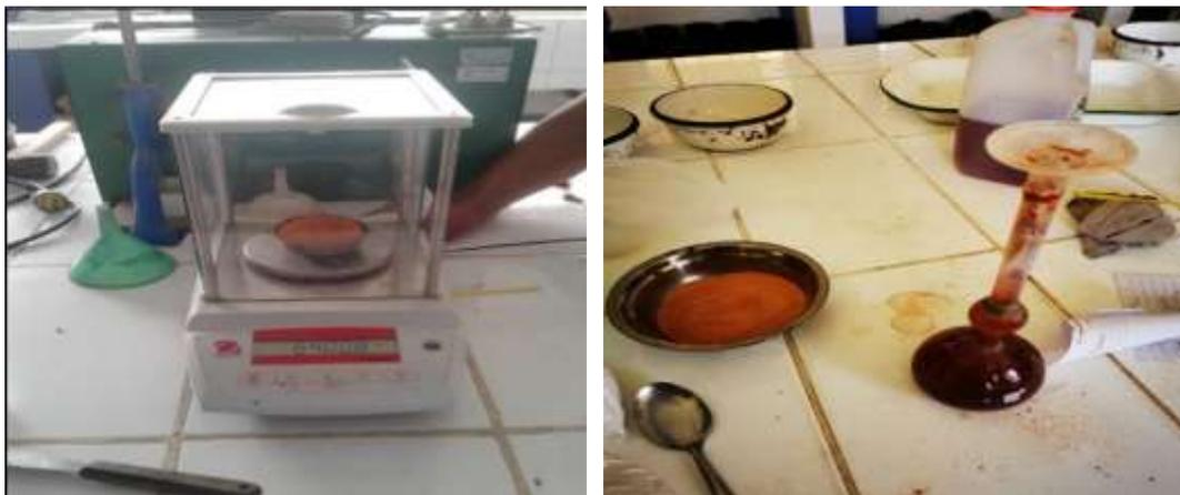
**Figura 54y55:** Procedemos a Pesar una cantidad de arcilla Y ceniza de concha de abanico de  $64 \pm 0.05$  g y depositarla en el frasco. Debe tener cuidado al depositar la arcilla de evitar salpicaduras y observar que la arcilla no se adhiera al interior del frasco por encima del líquido. Se puede utilizar un embudo para acelerar la colocación la arcilla y para prevenir que éste se adhiera al cuello del frasco.
