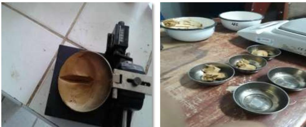
**Figura 30y31:** Se coloca una pequeña cantidad de masa húmeda en la parte central de la copa y se nivela la superficie, Luego se pasa el acanalador por el centro de la copa para cortar en dos la pasta de suelo, posteriormente La ranura debe apreciarse claramente y que separe completamente la masa del suelo en dos partes. La mayor profundidad del suelo en la copa debe ser igual a la altura de la cabeza del acanalador ASTM.
