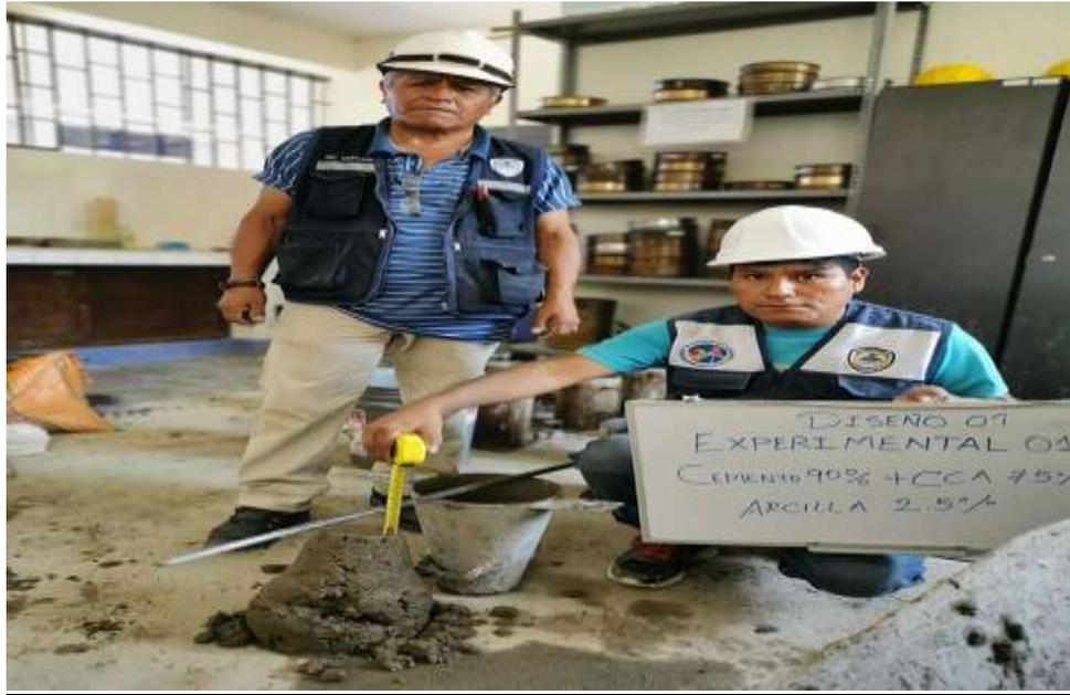
**Figura 115:** Realizamos el ensayo de slump para conocer la consistencia del concreto, es decir, su capacidad para adaptarse con facilidad al encofrado que lo va a contener con un mínimo de vacíos, dando como resultado un slump de 3 pulgadas, lo cual se encuentra en el rango.
