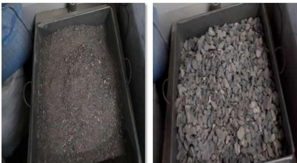
**Figura 75y76:** Seleccionamos una porción de los agregados en los recipientes para el ensayo respectivo.
