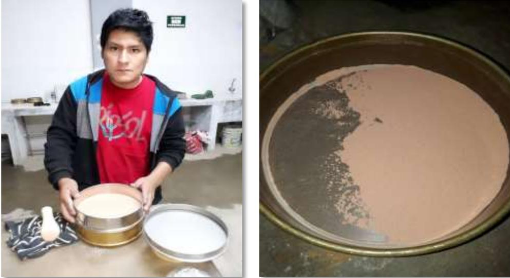
**Figura 27y28:** Preparar la muestra seca, disgregándola con el mortero y pasarlo por la malla No. 200 para obtener una muestra representativa de unos 250 gr. aproximadamente.
