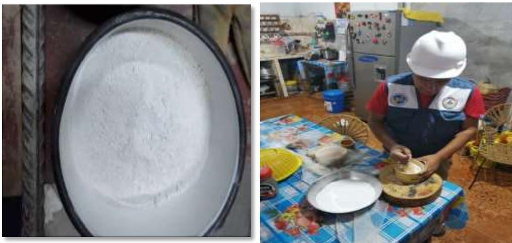
**Figura 49y50:** Se procedió a triturar la concha de abanico calcinada y luego Se tamizo abanico por la malla N°200 Para poder ser usada para nuestro experimental.
