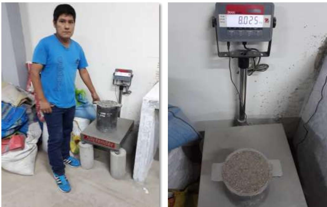
**Figura 83y84:** Una vez enrasado procedemos a pesar los agregados.
