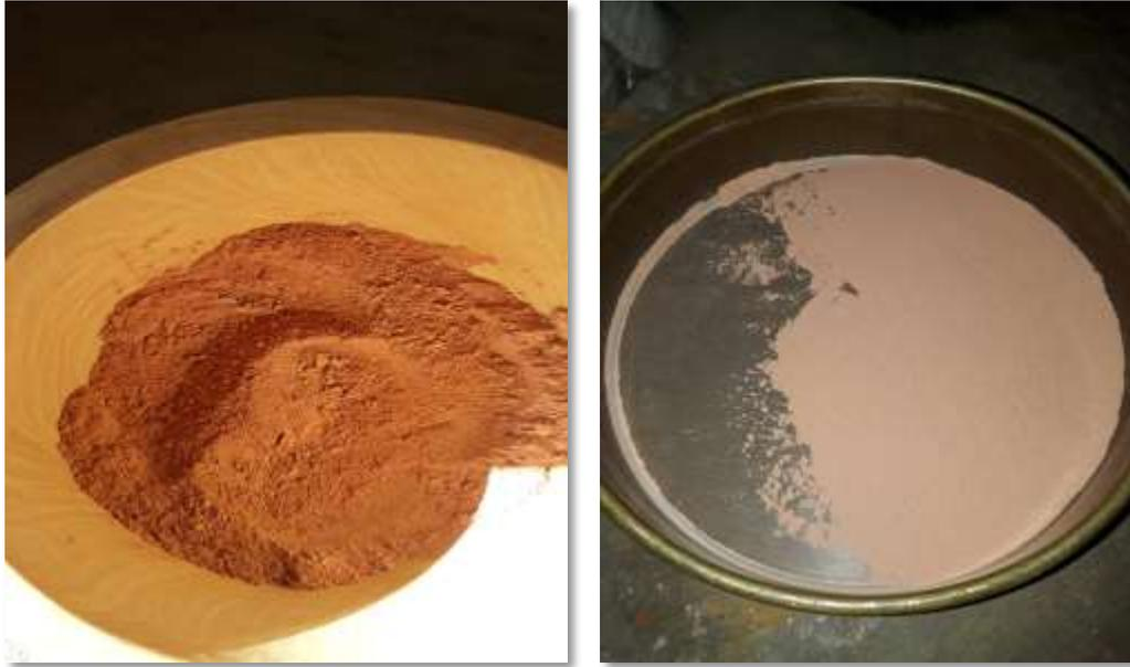
**Figura 24y25:** Se consideró una pérdida del 2% debido a la finura de las partículas de arcilla son menores a 2 micras y estas se suspenden en el aire.
