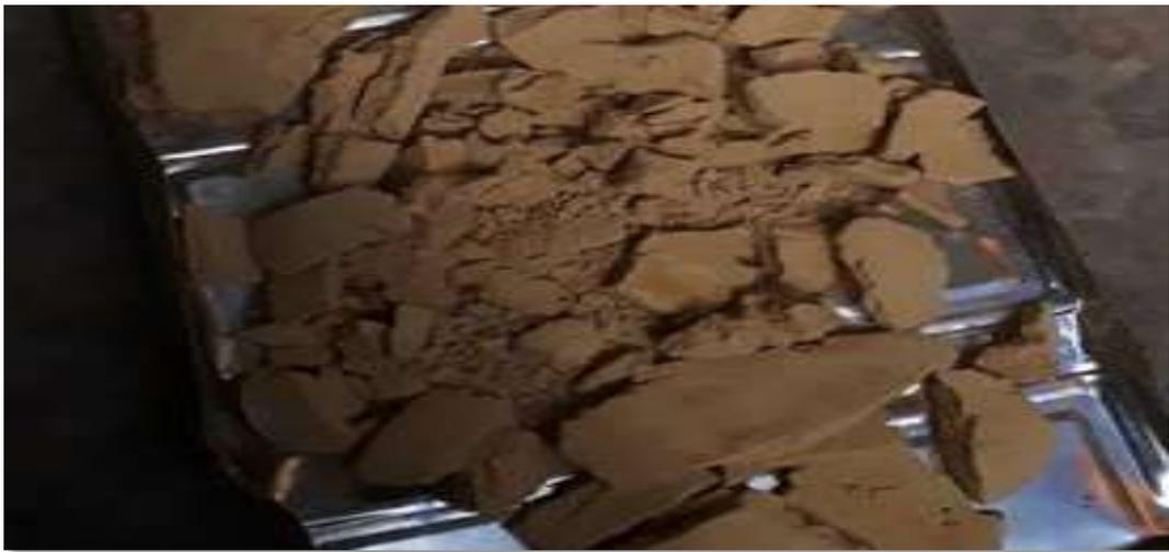
**Figura 20:** De 3.00 kg de material recogido de campo se obtuvo 2.00 kg de arcilla pura. Reduciendo EL 40%.
