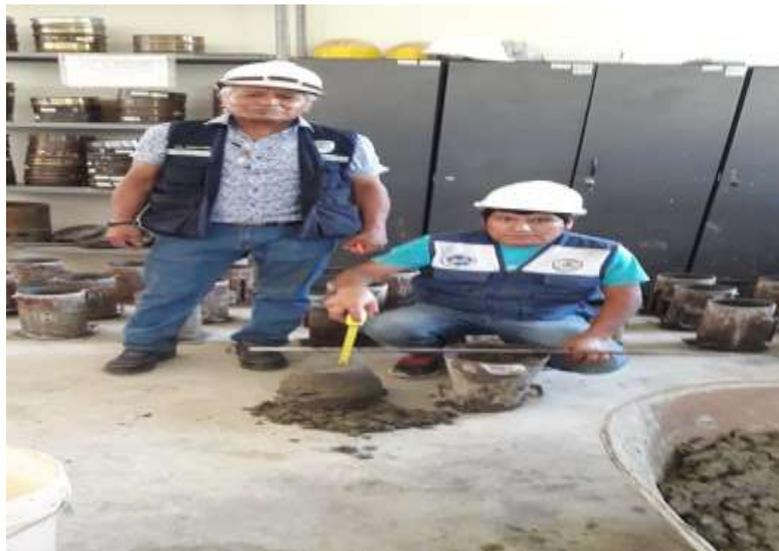
**Figura 105:** Se realiza en ensayo de SLUMP, dando como resultado 3” en presencia del Ing. montañés
