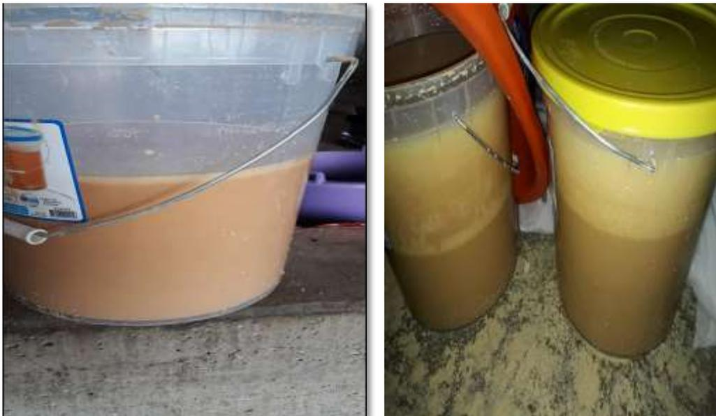
**Figura 11y12:** Se seleccionó la arcilla (3.0 Kg) y se procedió al lavado de la misma haciendo uso de un balde de 21Lt. Se hecho arcilla en el balde hasta la 1/8 parte del balde para ser disuelta con agua.
