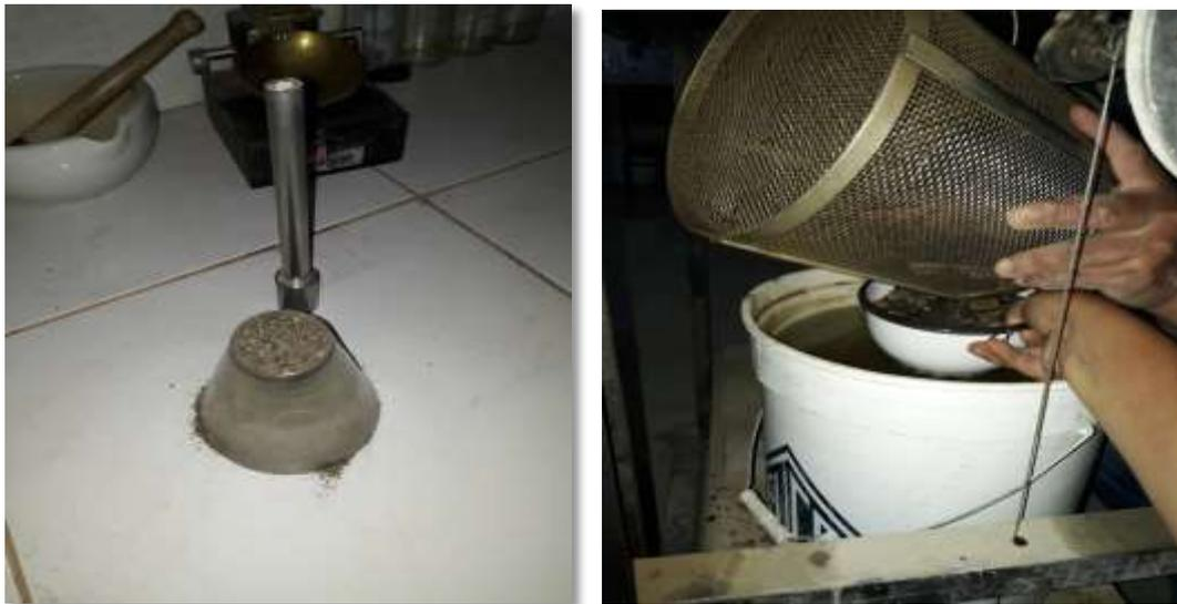
**Figura 91y92:** Arena: La muestra seca se le agrega agua hasta tener la arena superficialmente seca luego se introduce en el cono para saber si la muestra tiene humedad requerida.
