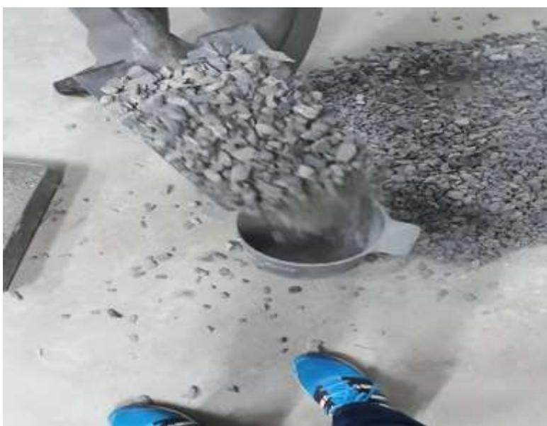
**Figura 77:** Llenar el molde hasta una tercera parte del molde. Varille la capa del agregado con 25 Golpes igualmente distribuidos sobre la superficie.
