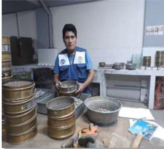
**Figura 104:** Después de haber pesado el agregado se empieza a tamizar el material mediante el método descrito de la norma ASTM-C136.
