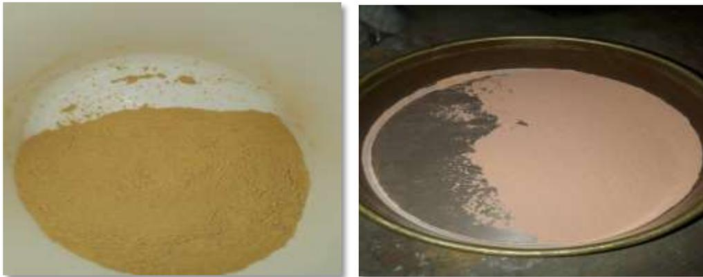
**Figura 34y35:** Se trabaja con el material preparado para el límite líquido se toma aproximadamente 20gr
