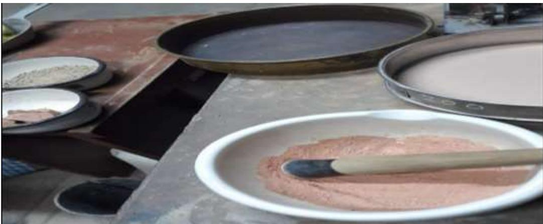
**Figura 23:** La arcilla se molió en un mortero hasta obtener una finura de 75-150 micras. Esto se logró haciendo uso de la malla N°200 en Laboratorio de suelos.
