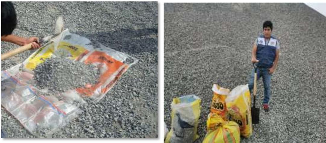
**Figura 3y4:** El agregado Grueso (Piedra Chancada  $\frac{3}{4}$ ”) que se utilizó en el presente trabajo de investigación se extrajo de la cantera “RUBEN” que se encuentra ubicada en el distrito de Chimbote, antes de llegar al túnel de Coishco.
