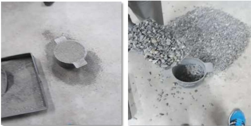
**Figura 69y70:** Se procede a tomar la muestra señalada para llenar el molde con una palana hasta rebosar (En el caso de la arena usamos un cucharon para llenar el molde).
