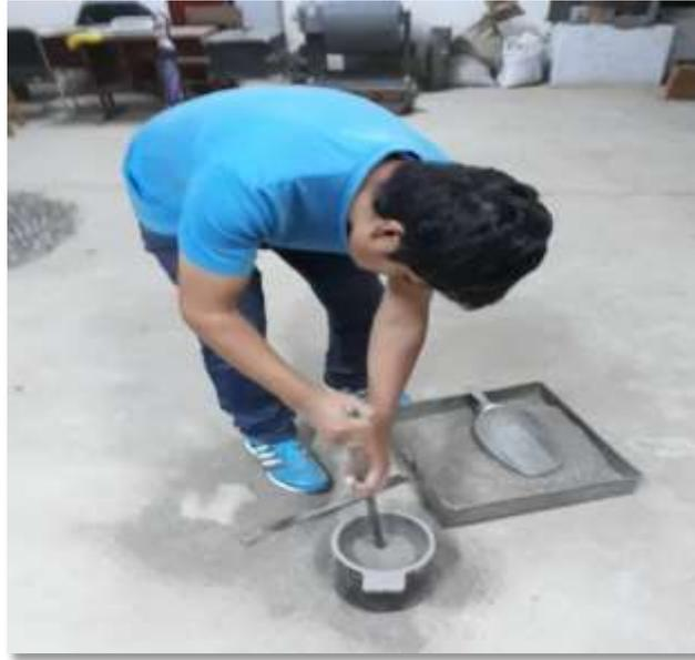
**Figura 78:** Siga llenando el recipiente hasta dos terceras partes del total y varille como en la capa inicial.
