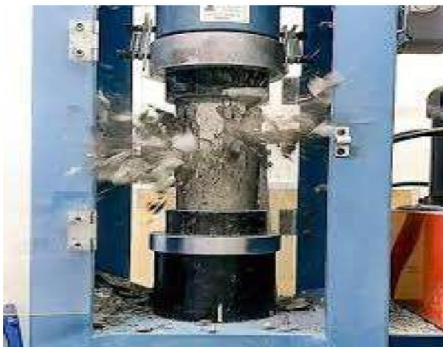
*Figura 2.* Resistencia a la Compresión
