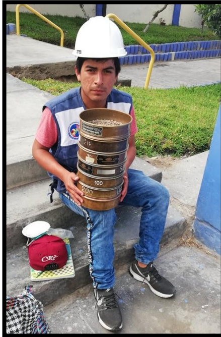
Figura 23: GRADANDO LA ARENA GRUESA
