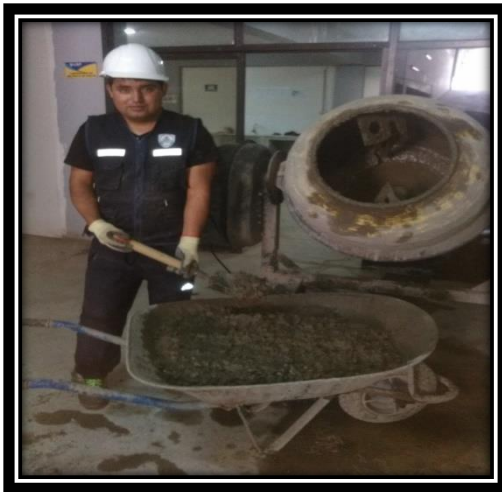
Figura 54. Realizando la mezcla para la prueba del slump
