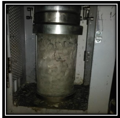
Figura 61. Probeta rota a los 7 días
