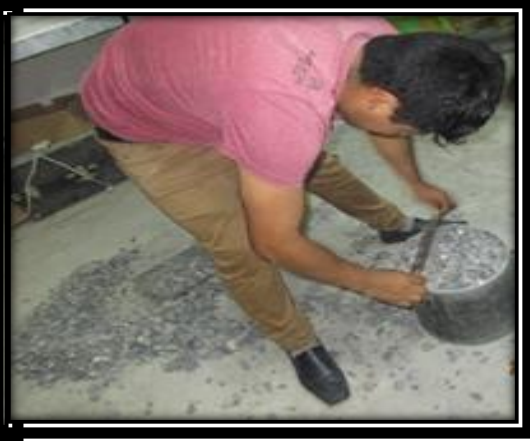
Figura 36. Enrasando la superficie con un regla
