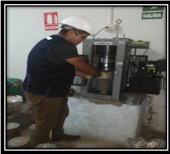
Figura 62. Colocando la probeta para su ruptura
