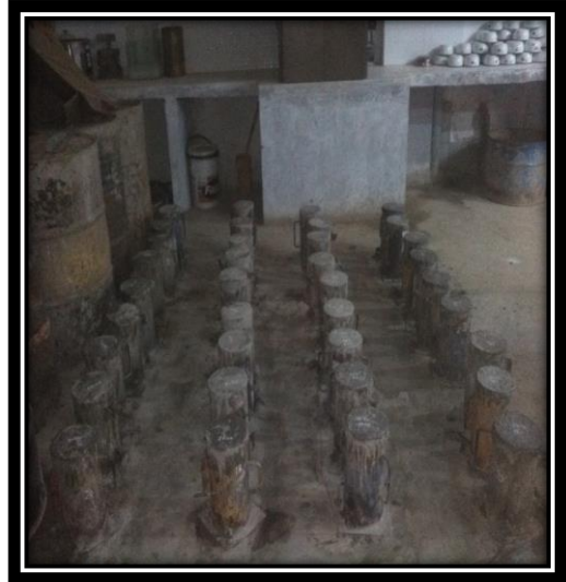
Figura 59. Vaciado de las 36 probetas
