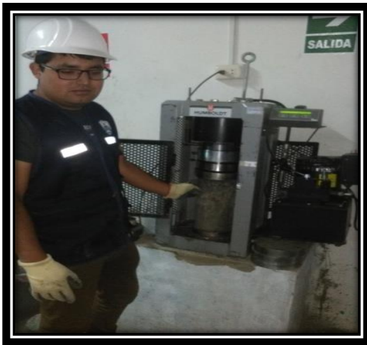
Figura 60. Puesto la probeta a la compresora para su ruptura
