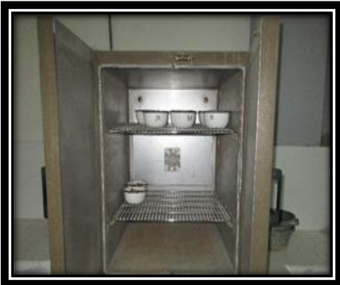
Figura 34. Introducido al horno las muestras por 24 horas
