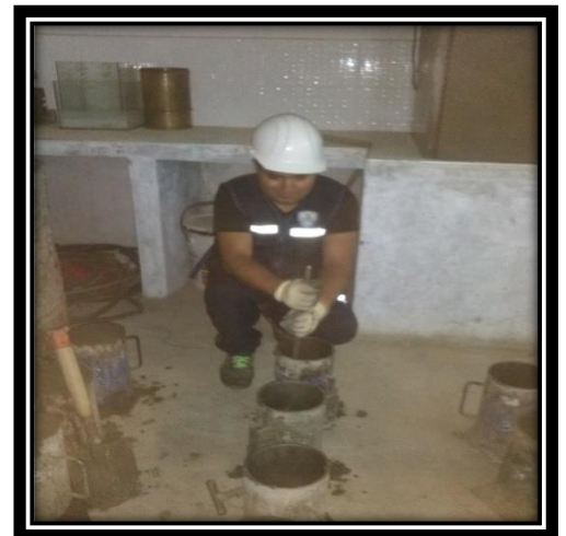
Figura 57. Realizando el vaciado de las probetas
