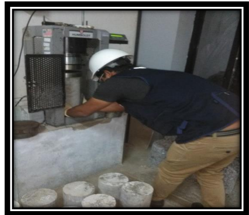
Figura 65. Colocando la probeta para su ruptura
