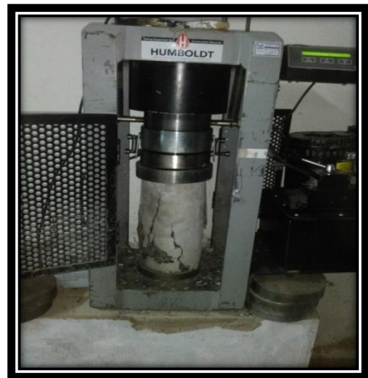
Figura 69. Probeta rota a los 28 días
