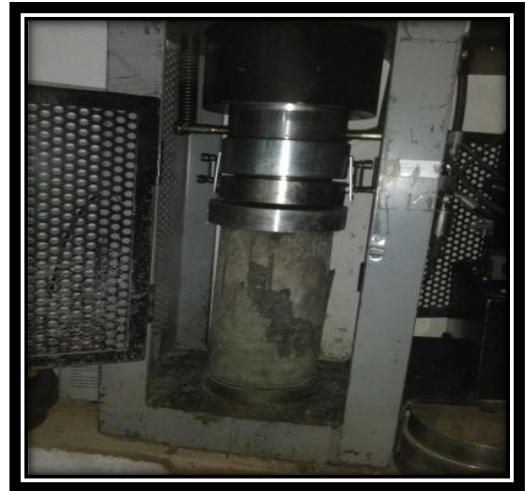
Figura 63. Probeta rota a los 7 días
