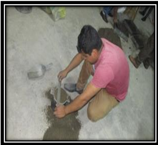
Figura 37. Enrasando con una regla el agregado fino
