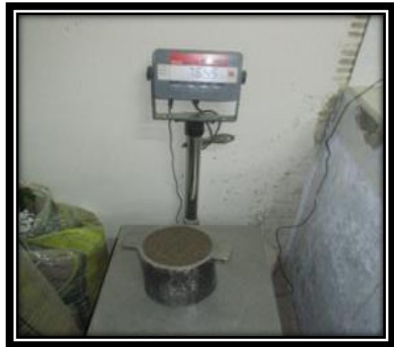
Figura 38. Pesando el agregado más el recipiente
