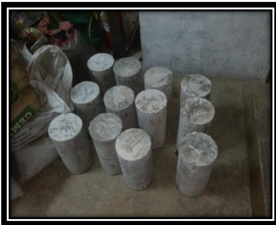
Figura 64. Probetas para su ruptura a los 14 días
