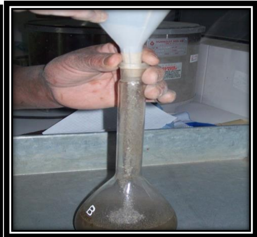
Figura 42. Colocando el agregado fino a la fiola
