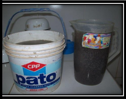
Figura 40. Muestra de agregado fino sumergida en agua
