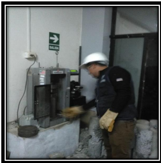
Figura 68. Colocando la probeta para su ruptura
