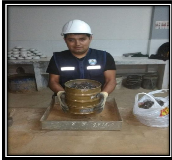
Figura 51. Realizando el tamizaje de la viruta de acero
