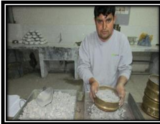
Figura 47. Lavando la muestra del agregado fino
