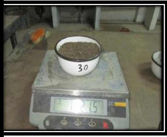
Figura 32. pesando el agregado fino
