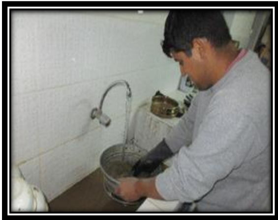
Figura 47. Lavando la muestra del agregado fino
