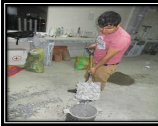
Figura 35. Llenando el recipiente con el agregado
