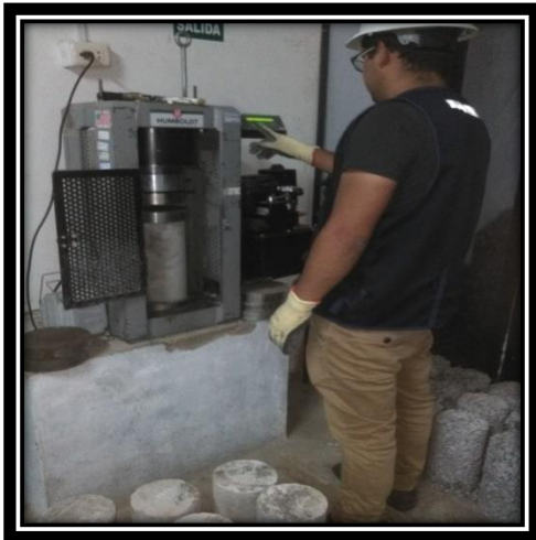
Figura 66. Realizando la ruptura de la probeta a los 14 días
