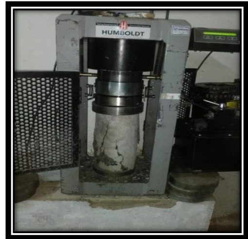
Figura 67. Probeta rota a los 14 días
