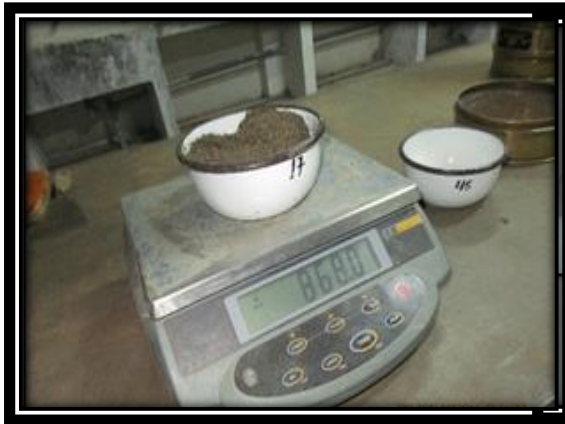
Figura 39. Pesando el agregado fino para el ensayo
