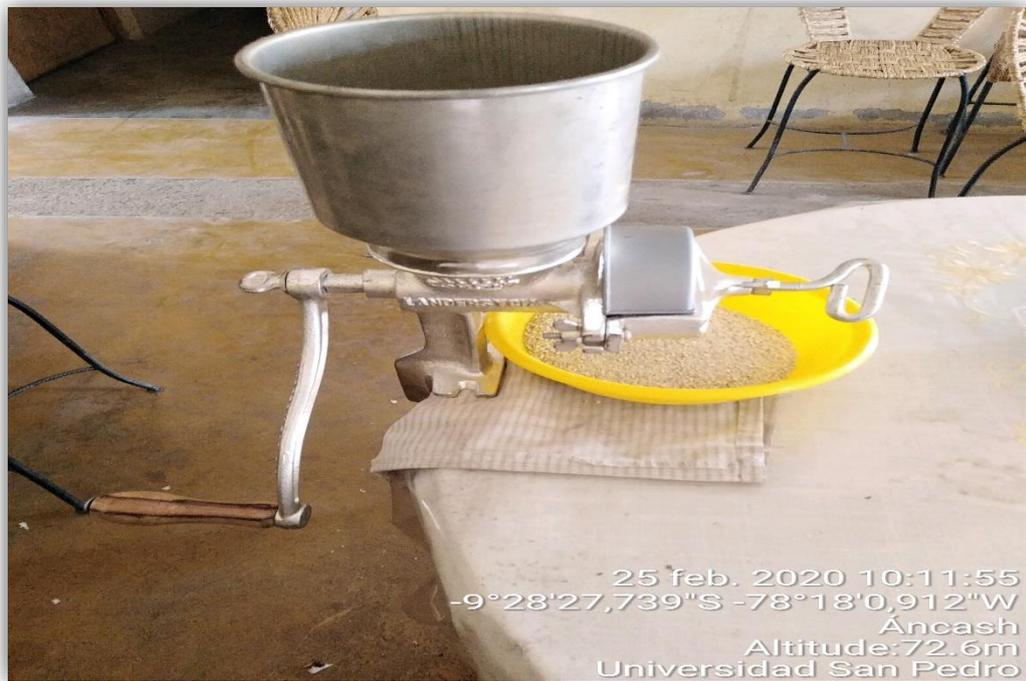
**Figura N°19:** Realice el proceso de pulverización
