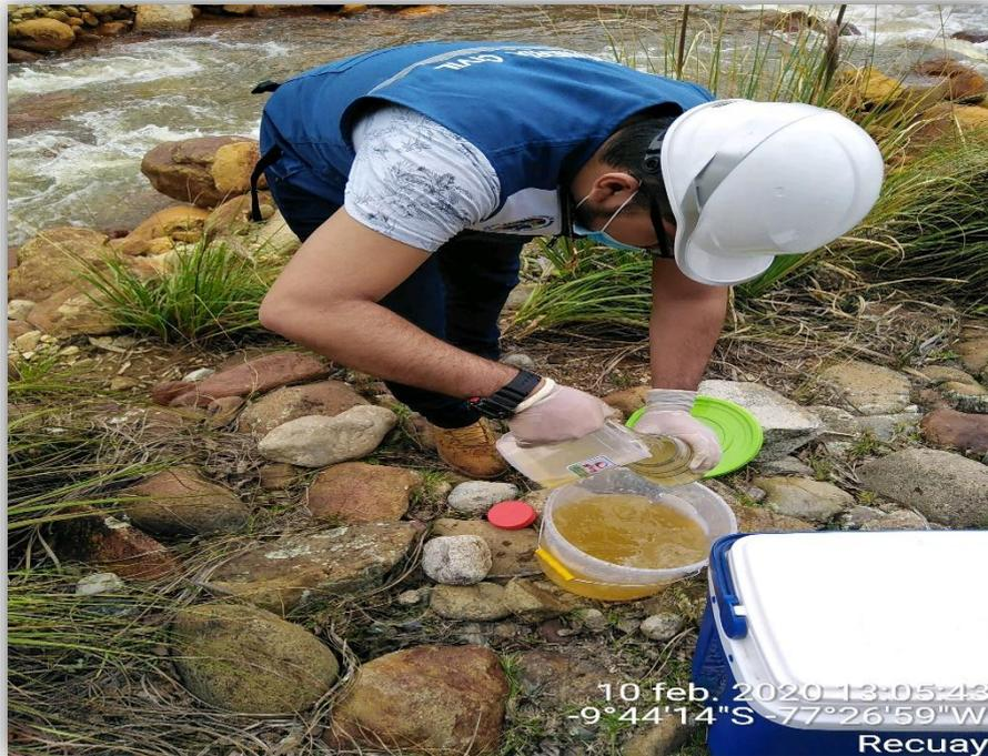
**Figura N°04:** Depositando agua a un recipiente de 1 litro de primer uso
