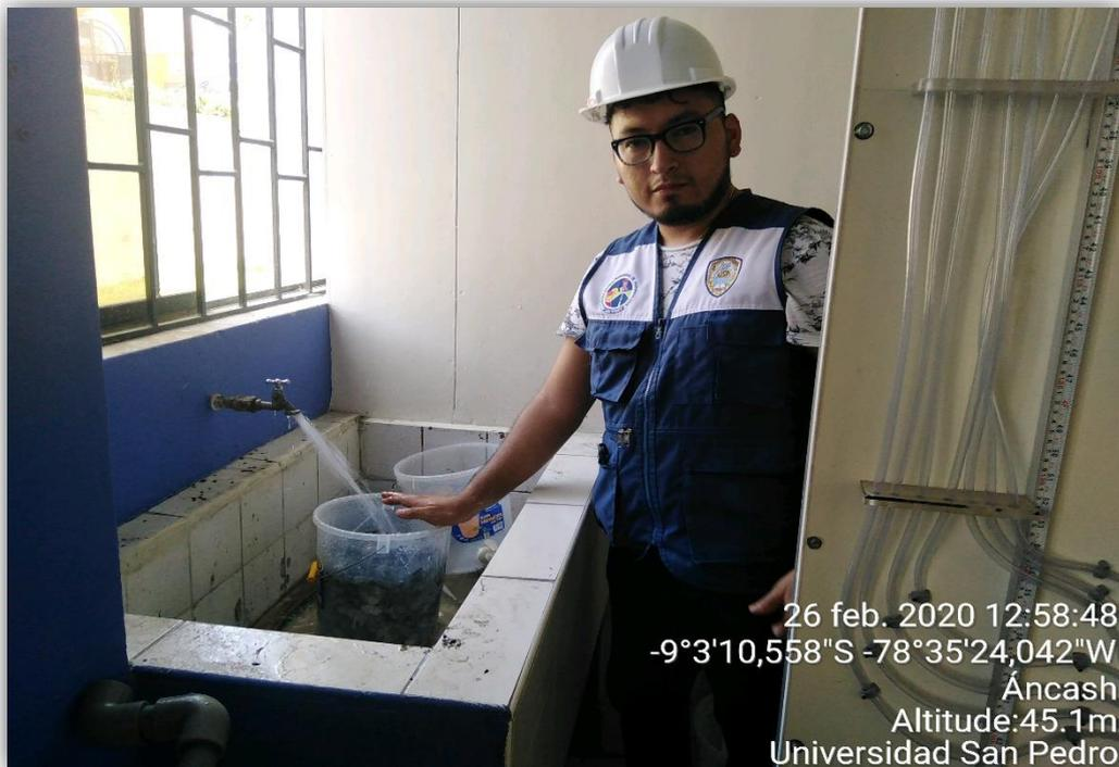
**Figura N°28:** Lavando las capas de piedra de 1",1/2" y confitillo
