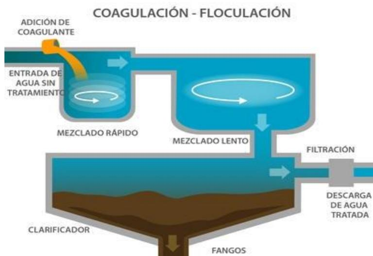
Figura 4: Proceso de Tratamiento de la Coagulación – Floculación
