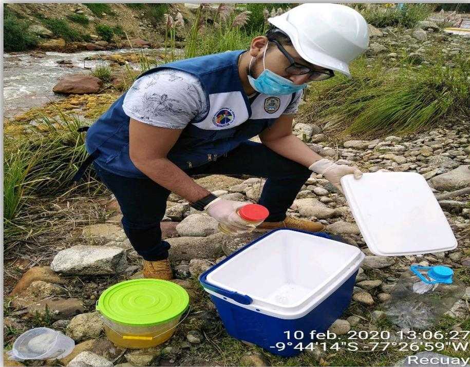
**Figura N°06:** Llevando el agua en un cooler con una T 6° con hielo seco Mapa
