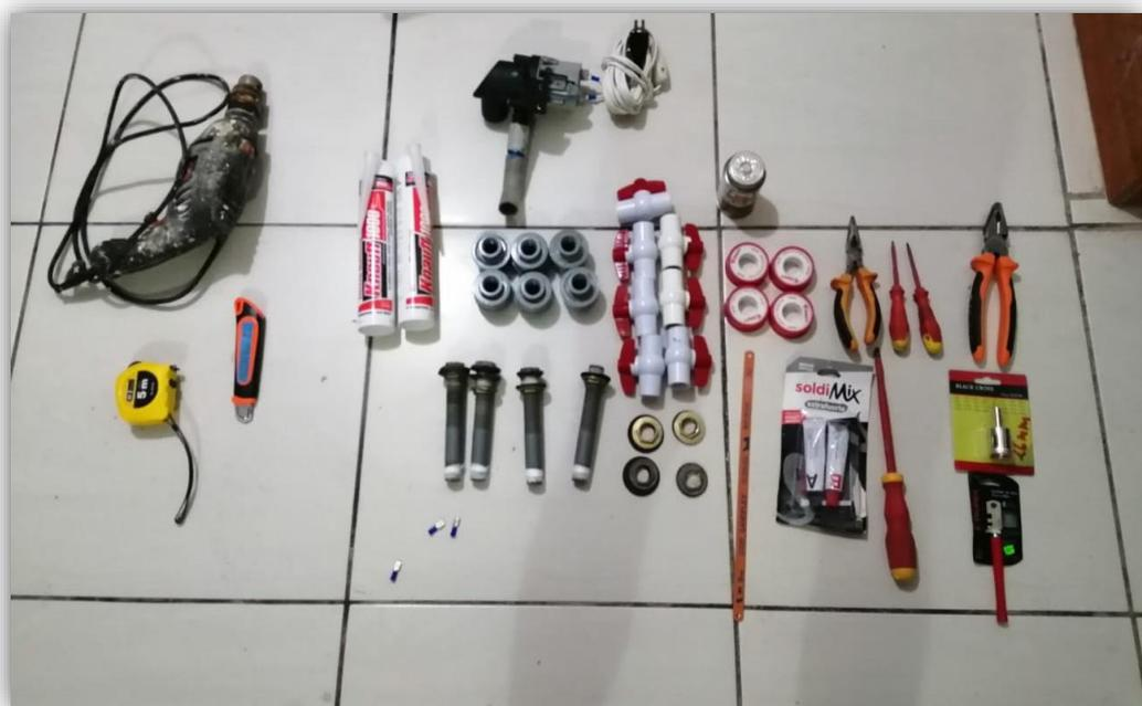
**Figura N°24:** Materiales para elaboración de la conexión de las tuberías
