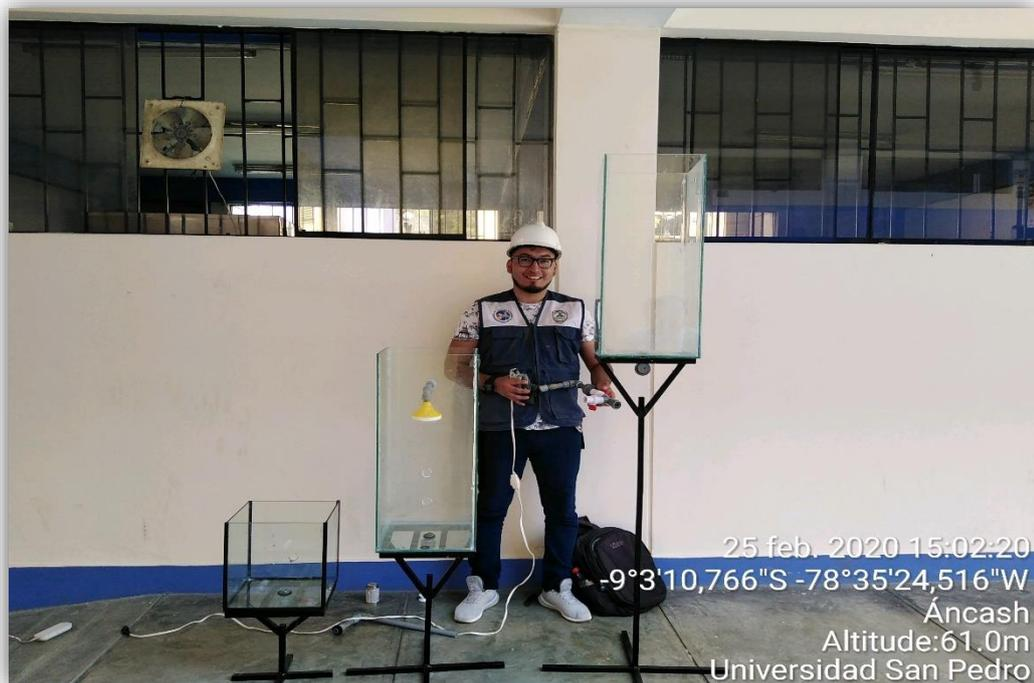
**Figura N°23:** Recipiente de vidrio de 30 y 50 litros para captar y rotar agua, tanque elevado de vidrio de 50 litros.
