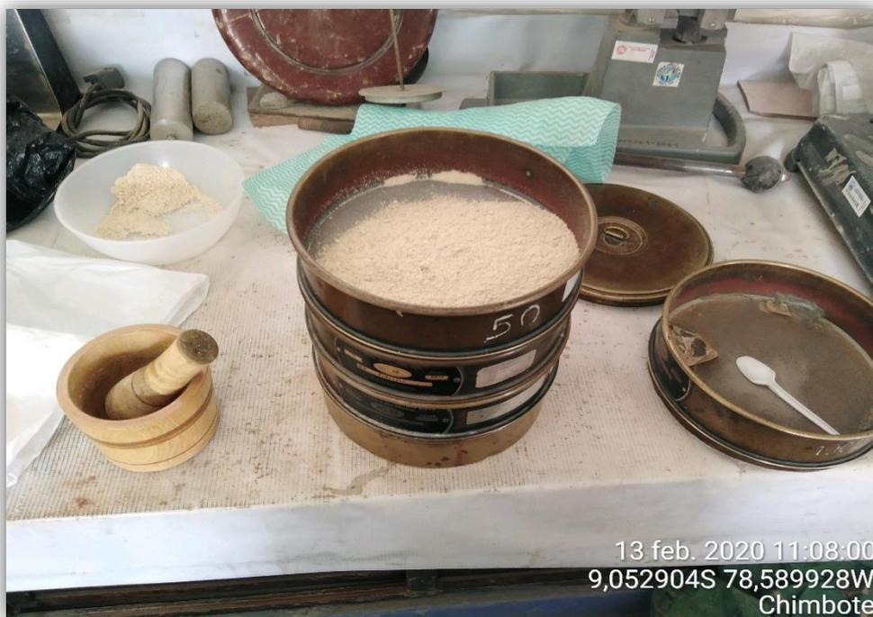
**Figura N°14:** Procedo a tamizarlo primero por la Malla N° 50, Malla N°100 y finalmente Malla N°200
