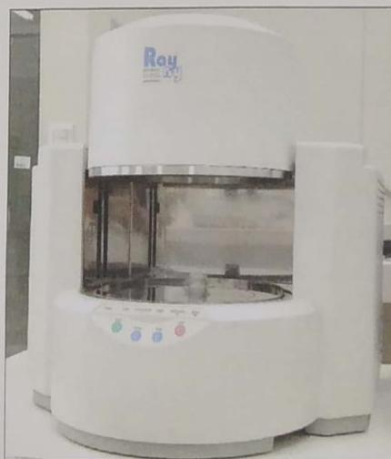
Figura 2. Equipo de Espectrofotometría de Fluorescencia de Rayos X.
