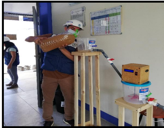
Fotografía 19. Se separó 1 L de agua del río para el patrón.
