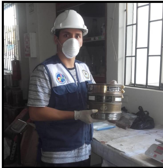
Fotografía 9 - 10. Se pasaron por las mallas #40, #50 y #60 el cual tiene granos <0.3\text{mm} el cual es el tamaño que favorece en la bioadsorción.
