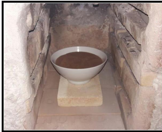
Fotografía 12. Muestra antes de calcinar en mufla por 2 h a 100°C y por 8 h a 500°C.
