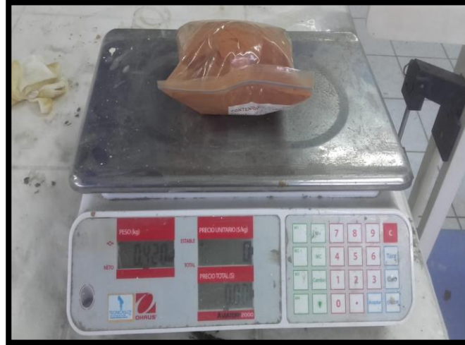
Fotografía 11. De los 60 kilos se obtuvo 494 g que pasaron por la malla #60 para proceder a a la prueba de ATD.
