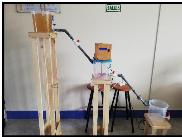
Fotografía 20. Se llenó con agua el primer balde de CAPTACIÓN.
