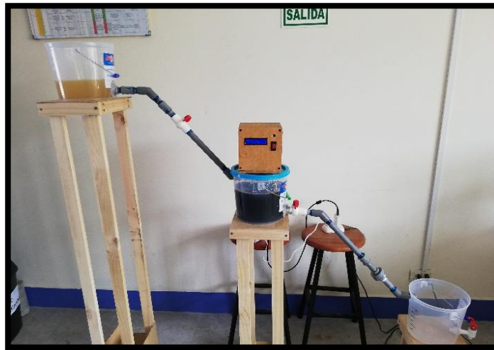
Fotografía 21. Se abrió la llave, llenándose el segundo balde y agregando 10 gr de ceniza de cáscara de tomate.
