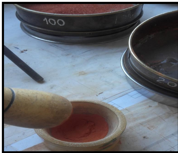
Fotografía 7 - 8. Se trituro en una licuadora y luego en un mortero.
