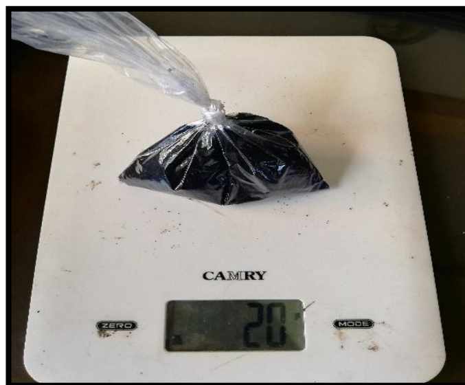
Fotografía 16. Se pesaron los 20 gr para realizar el ph de la ceniza de cáscara de tomate.
