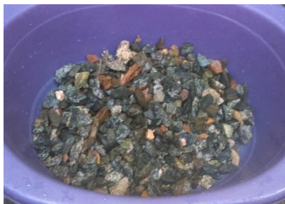
Lavado de grava de 12.7 a 19 mm de diámetro
