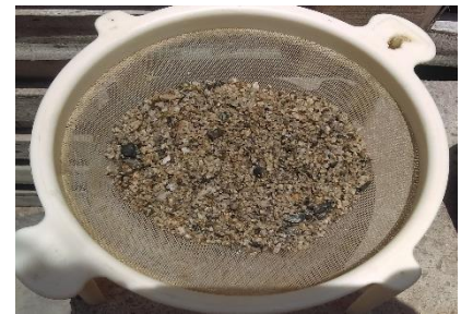
Lavado de arena de 2.36 mm de diámetro
