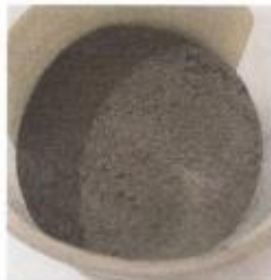
FIGURA N°1. Muestra de Astragalus garbancillo, temperatura de activación de 390°C por 2 horas
