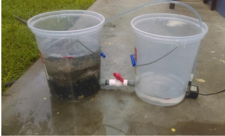
Figura 13. Filtro de arena, grava y algodón de circuito cerrado con flujo constante
