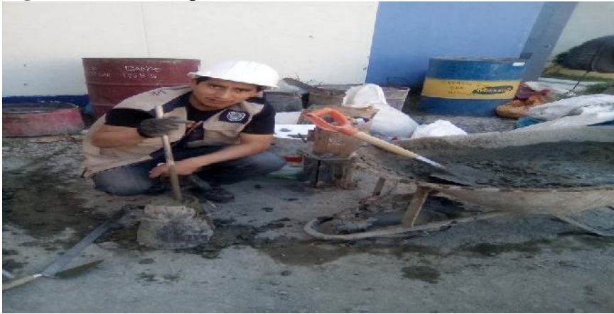
Figura N° 4: Compactación de la mezcla en el cono de Abrams.
