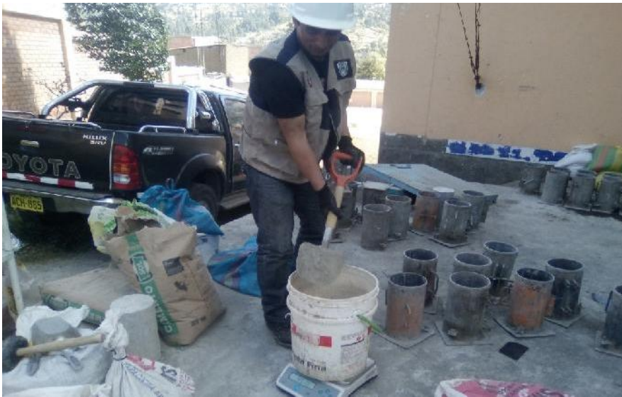
Figura N° 2: Realizando el pesado de los materiales para el posterior mezclado.
