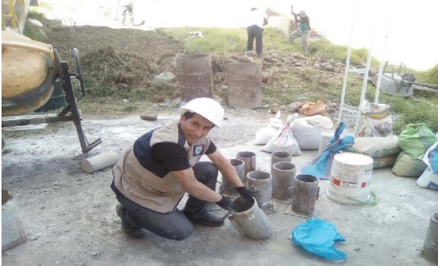
Figura N° 01: La superficie interior del molde está cubierta de aceite.
