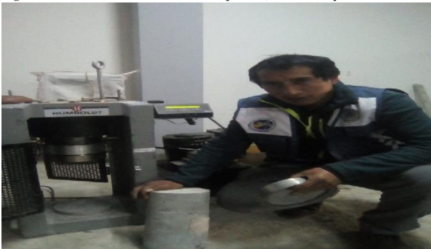
Figura N° 8: Colocación del cilindro (probeta) en la Maquina Universal.
