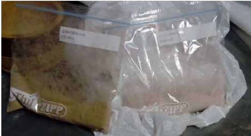
Figura 23: Muestra de Concha de Abanico pasada por la malla 200 para el ensayo de ATD
