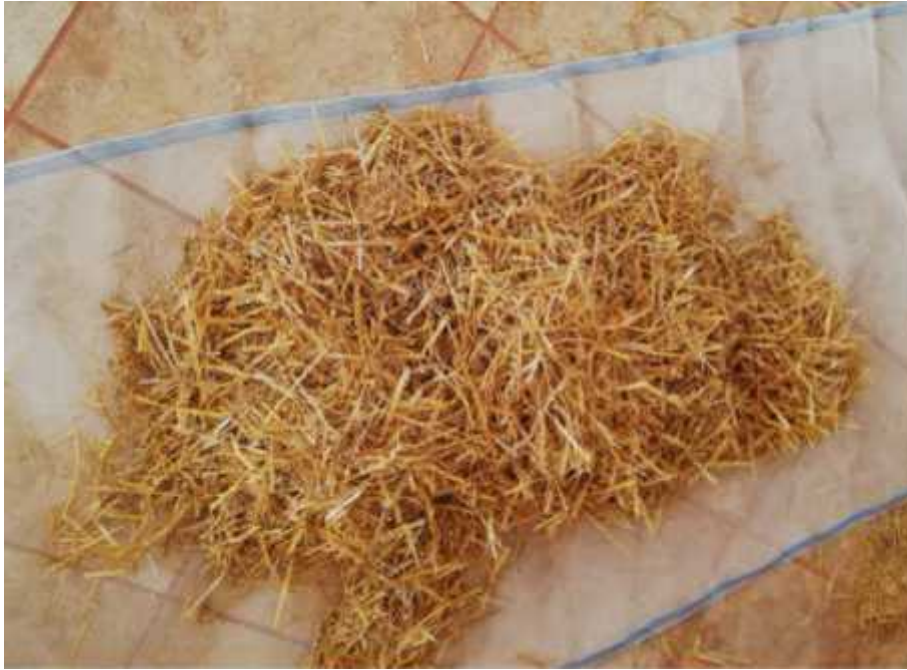
Figura 19: Tamizado a la Pajilla de trigo para extraer la arena y arcilla del material
