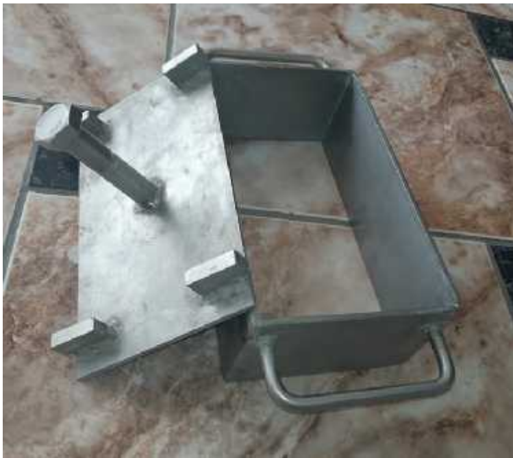
Figura 26: Molde de Ladrillo de Concreto fabricado de aluminio con medidas 23 x 13 x 9
