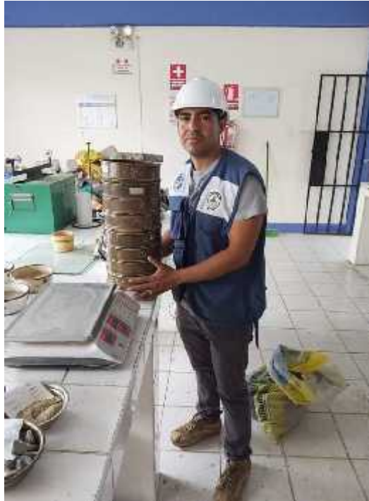
Figura 27: Ensayos de Granulometría tamizando los agregados con las mallas correspondientes.
