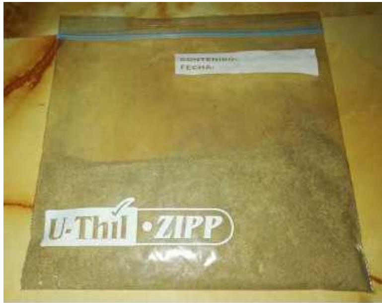
Figura 21: Muestra de Pajilla de Trigo pasada por malla 200 lista para ensayo ATD.
