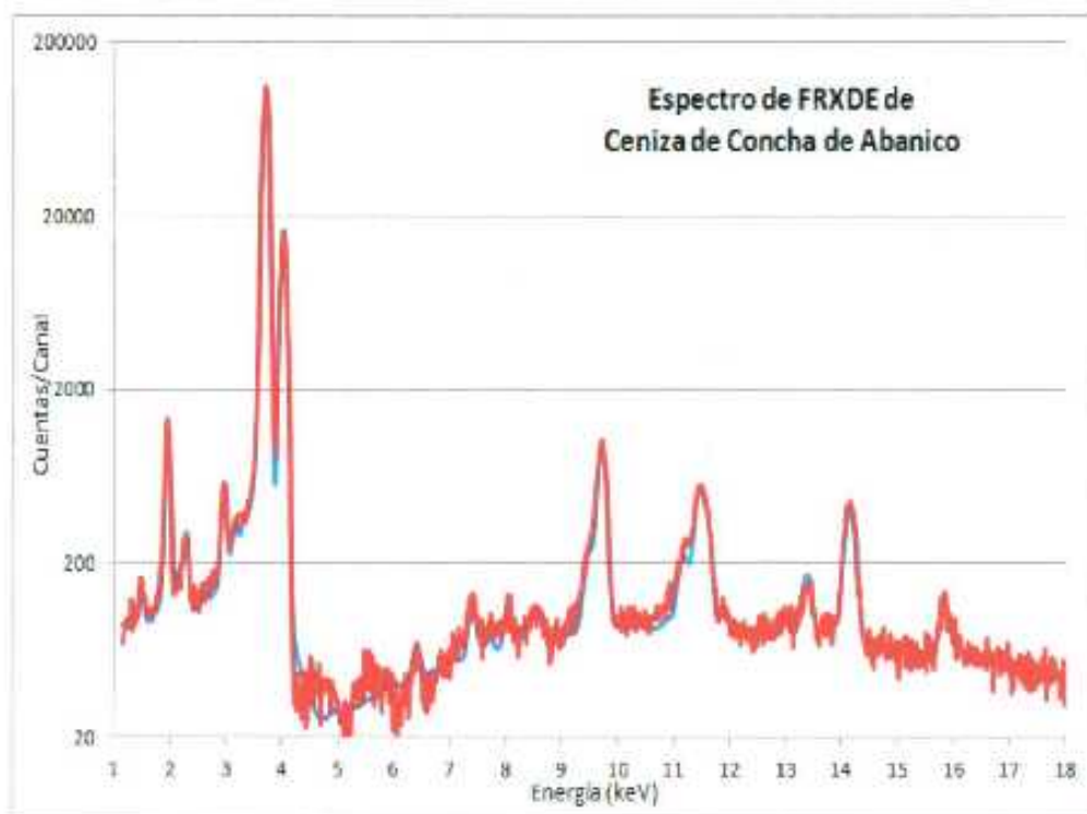
Figura 1. Espectro de FRXDE de ceniza de concha de abanico en escala semi-logarítmica. Incluye el pico de Ar del aire y los picos de rayos-X de Au dispersados por la muestra. La curva en azul muestra el espectro simulado
