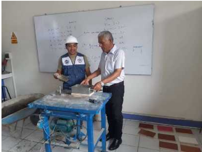
Figura 33: Elaboración del Ladrillo de Concreto con su respectivo molde
