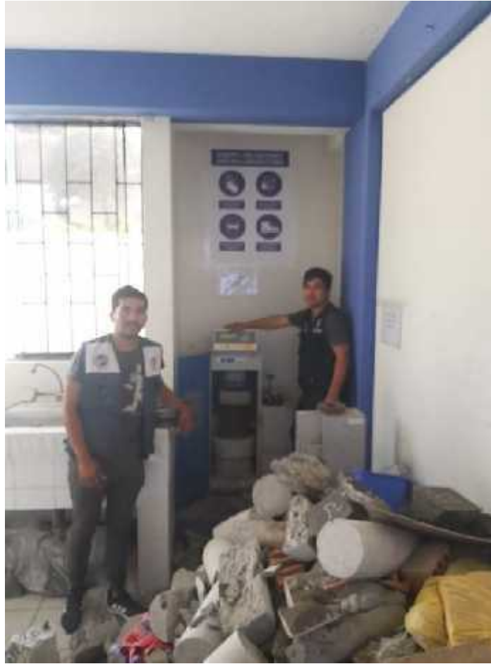
Figura 37: Ensayo de Resistencia a la Compresión del Ladrillo de Concreto.
