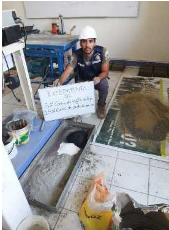
Figura 35: Combinación de cemento, ceniza de pajilla de trigo y ceniza de concha de abanico.
