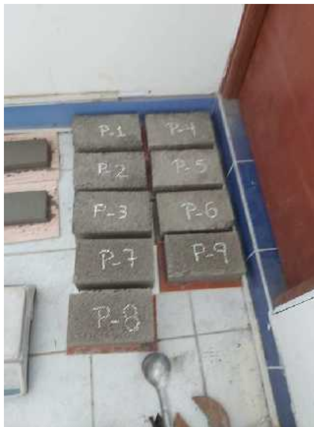
Figura 34: Elaboración de Ladrillo de Concreto según nuestro Patrón.
