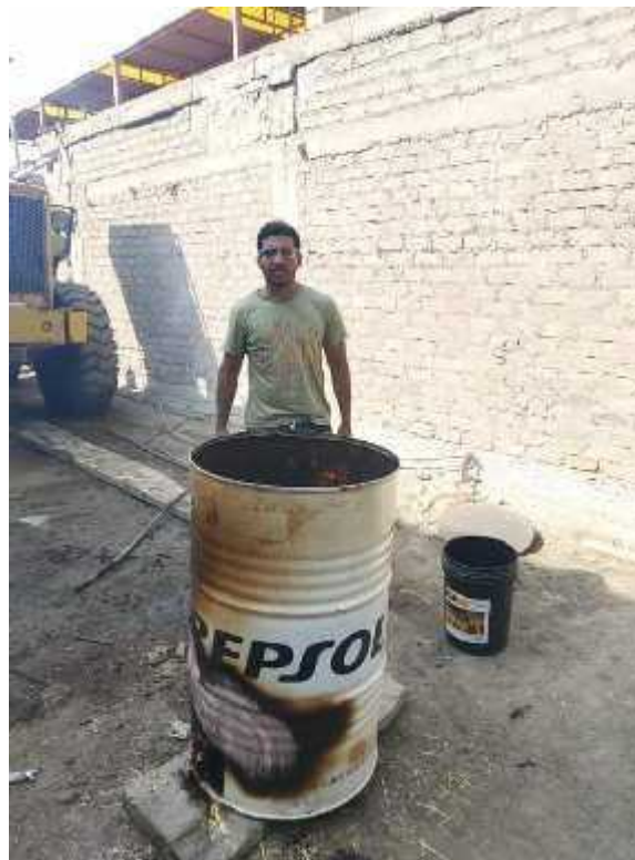
Figura 30: Hacemos el Pre Quemado para obtener la Ceniza de Pajilla de Trigo.
