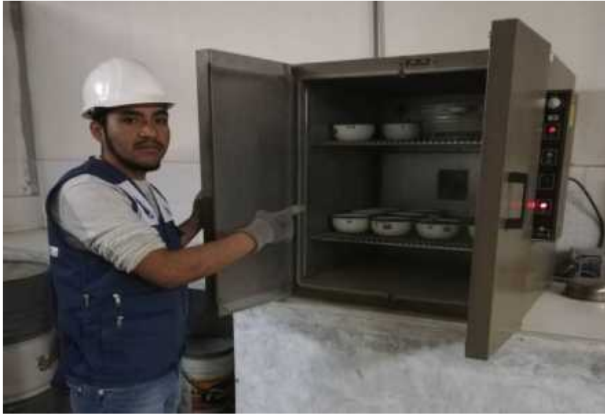
Figura 29: Metiendo material al Horno para secado de material para el ensayo de contenido de Humedad.
