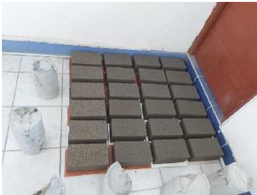
Figura 36: Elaboración de Ladrillo de Concreto según nuestro Experimental 1 y 2.
