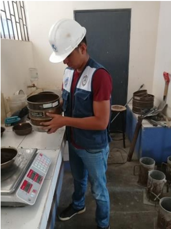
Figura 46. Realizando el tamizaje con las mallas (2020).
