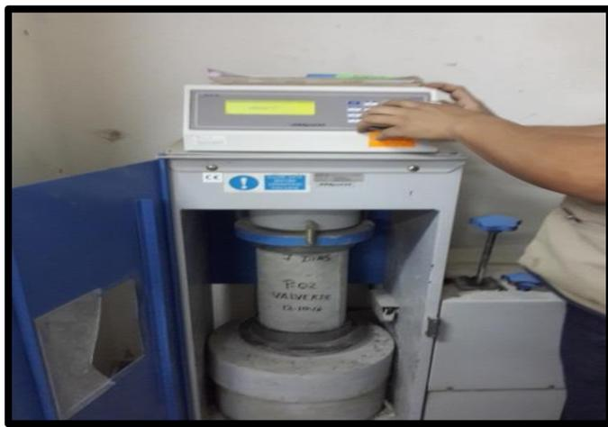
**Figura 05:** Ensayo de Resistencia a la compresión del concreto
