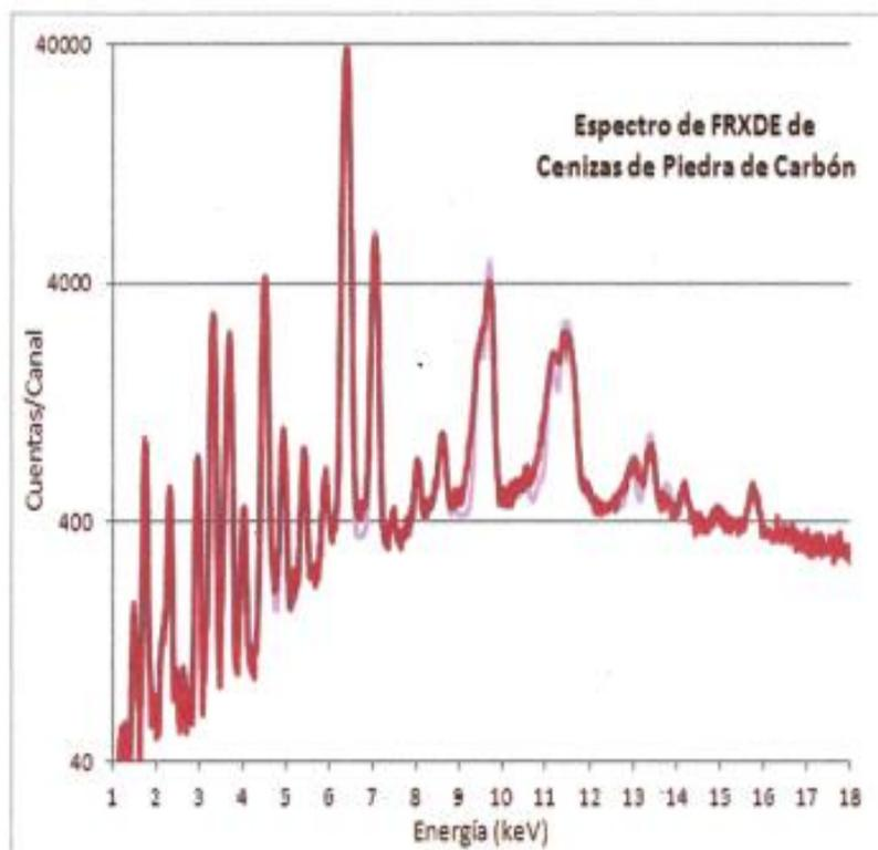
Figura 1. Espectro de FRXDE de cenizas de piedra de carbón en escala semi-logarítmica. Incluye el pico de Ar del aire y los picos de rayos-X de Au dispersados por la muestra. La curva en azul muestra el espectro simulado
