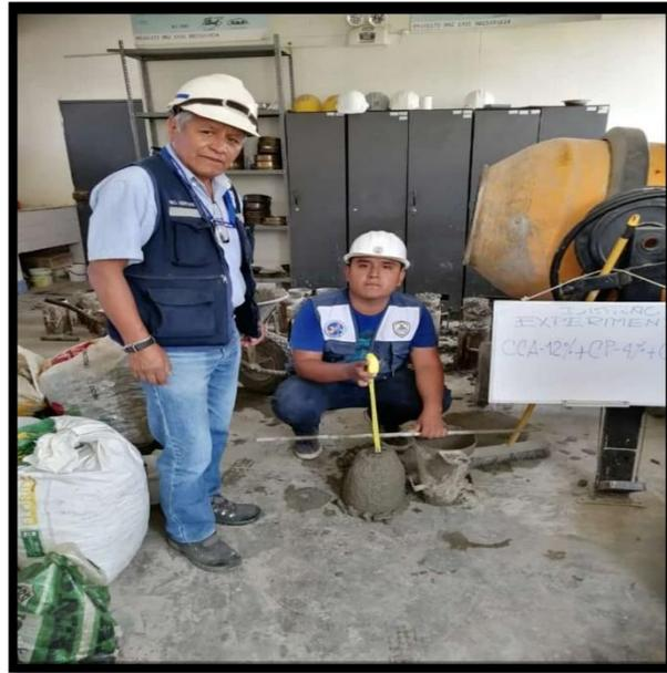
**FIGURA 33: SLUMP 3.5" COMPROBADO POR EL INGENIERO****VACEADO, CHUCEADO Y ENRASADO DEL
