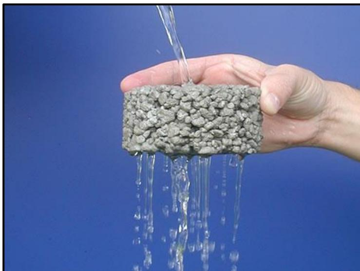
*Figura 1.* La estructura libre del concreto permeable genera el acceso simple de agua de lluvia (NRMCA, citado por Pérez 2009).
