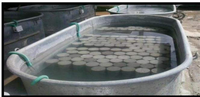
**Figura 03:** Deposito de concreto dentro del agua
