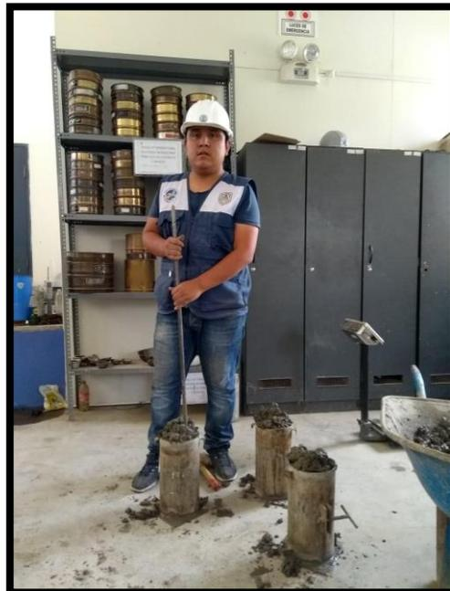
**FIGURA 34: LLENADO DE LAS PROBETAS
