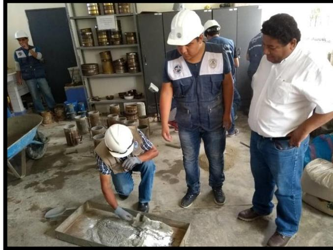
**FIGURA 31: COMBINACIÓN DEL CEMENTO CON EL POLVO DE LA CONCHA DE ABANICO Y LAS CENIZAS DE PIEDRA DE CARBON**
