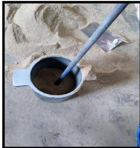
**FIGURA 15: LA ARENA SE DEJA CAER A CIERTA ALTURA COMPACTANDO Y CHUCEANDO EN TRES CAPAS IGUALES, ENRASANDO Y PESANDO LA MUESTRA**
