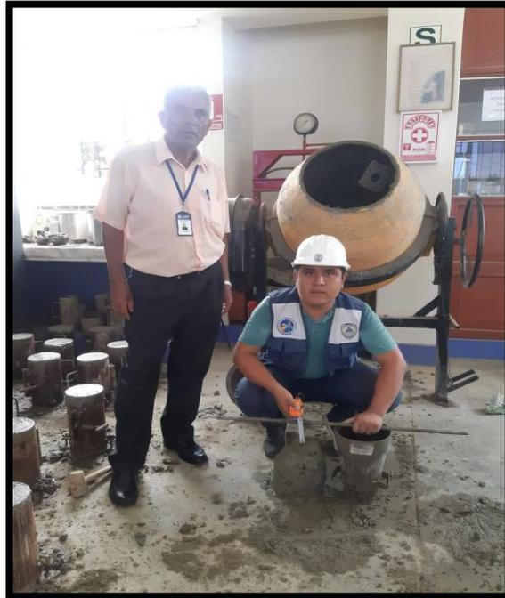
**FIGURA 27: SLUMP 3.5" COMPROBADO POR EL INGENIERO****VACEADO, CHUCEADO Y ENRASADO DEL
