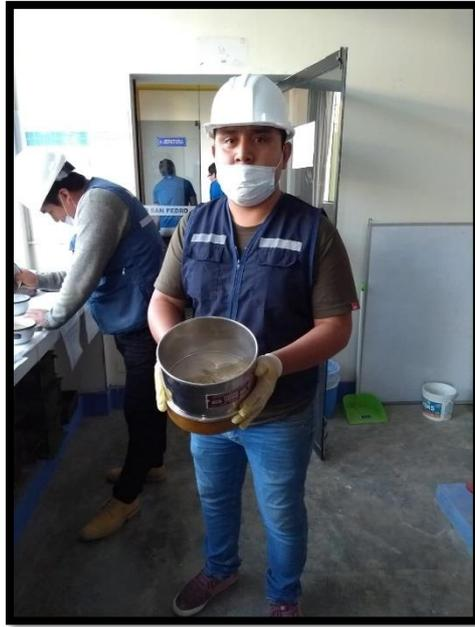
**FIGURA 24: DEL CUARTEO REALIZADO SE TOMA UNA MUESTRA DE PIEDRA Y SE PASA A REALIZAR LA GRANULOMETRÍA, TOMANDO LOS PESOS RETENIDOS EN CADA MALLA**
