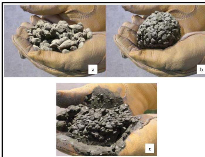
**Figura 2.** Especímenes de concreto permeable con distintas capacidades de H<sub>2</sub>O:
