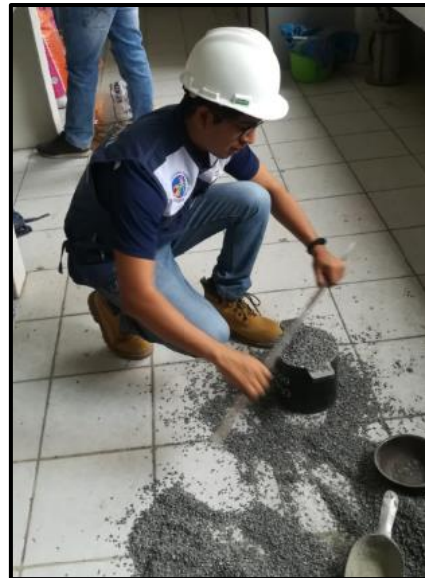
Figura 13. Llenado y enrasado de molde para el cálculo de peso unitario de los agregados
