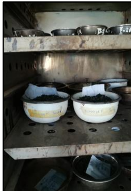
Figura 21. Colocación de muestras en estufa, para posterior cálculo de peso específico.
