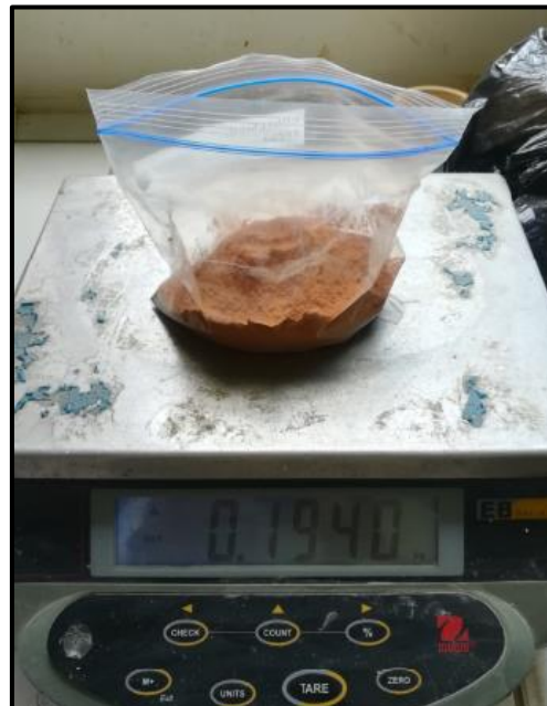
Figura 41. Peso de arcilla de Cajabamba tamizada.
