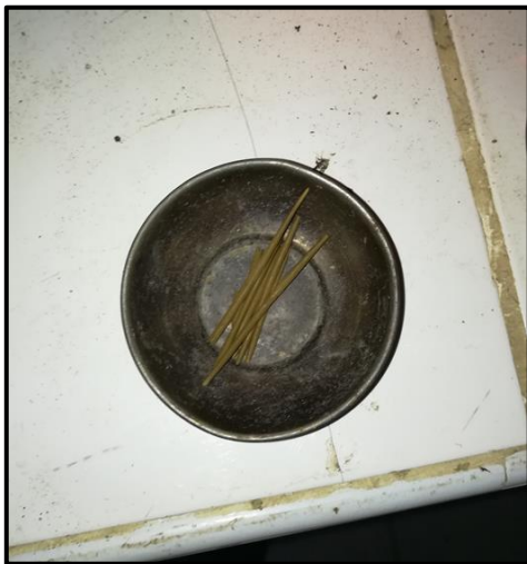
Figura 36. Ensayo para límite plástico de la arcilla.
