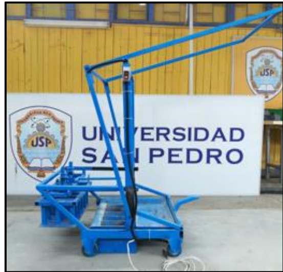
Figura 47. Maquina utilizada para la elaboración de los ladrillos.
