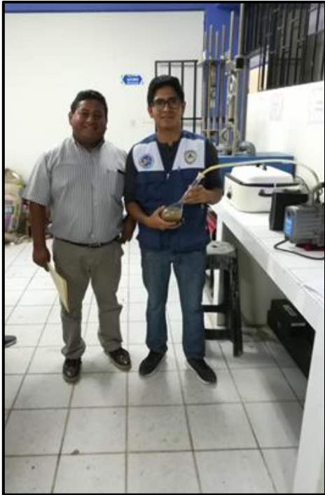
Figura 22. Extracción de vacíos de la fiola con arena y agua, supervisado por el asesor.
