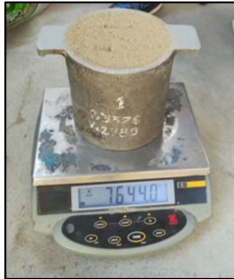
Figura 15. Pesado de molde más agregado fino.
