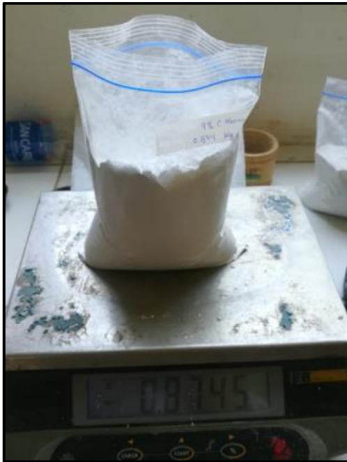
Figura 42. Pesado de la concha de abanico tamizada.
