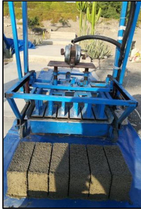
Figura 51. Desencofrado de ladrillos
