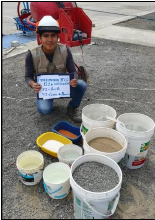
Figura 46. Pesado de materiales para elaborar los ladrillos experimental n°02, 12% de sustitución.
