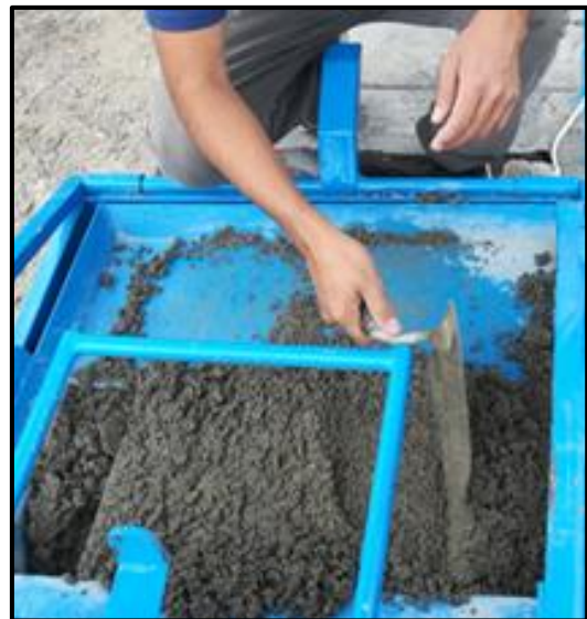
Figura 49. Relleno de los moldes con la mezcla preparada
