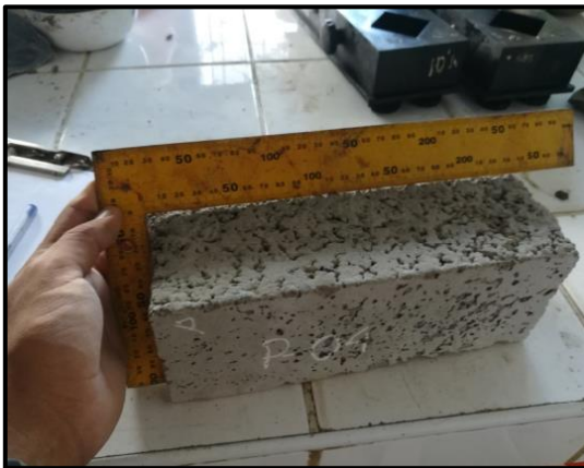
Figura 56. Medición de las dimensiones de los ladrillos.
