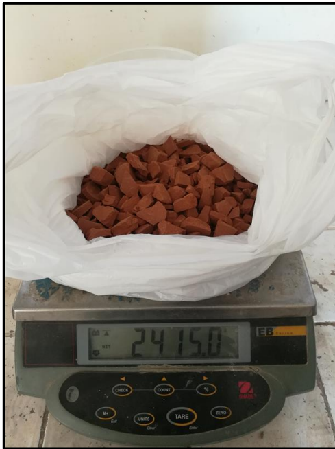
Figura 38. Arcilla de Cajabamba calcinada
