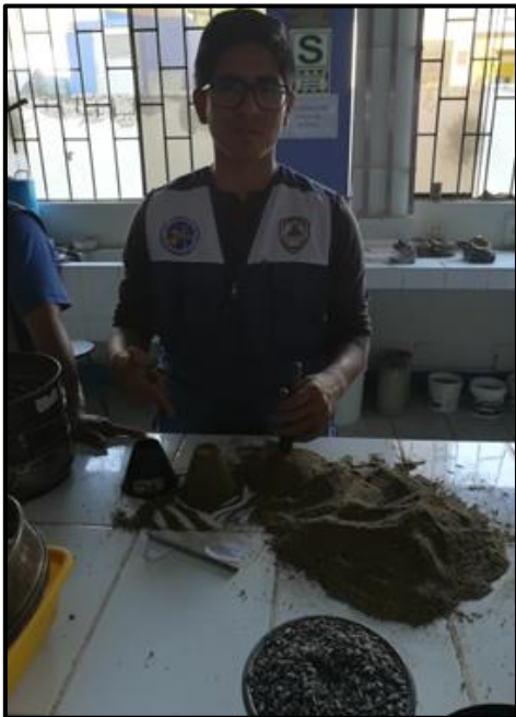
Figura 20. Prueba del cono para verificar que la arena esta superficialmente seca.
