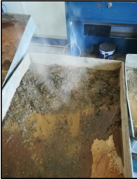
Figura 18. Secado superficial de la arena en cocina.
