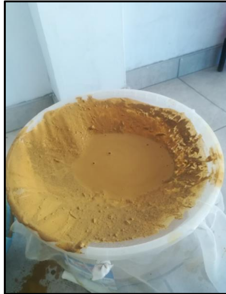
Figura 27. Lavado de la arcilla y pasada por malla organza.
