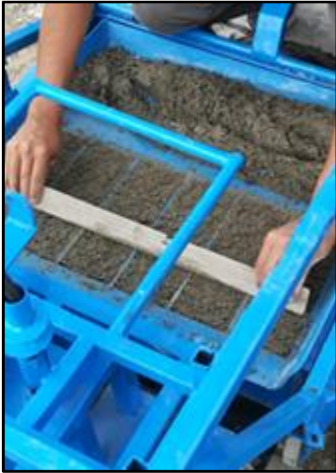
Figura 50. Enrasado de los moldes
