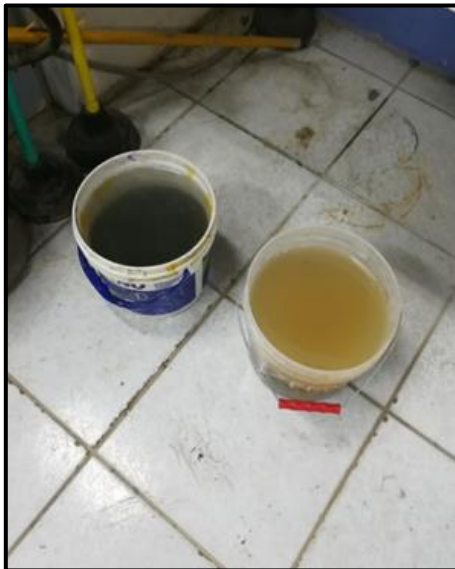
Figura 16. Agregados sumergidos en baldes con agua de un día para otro.
