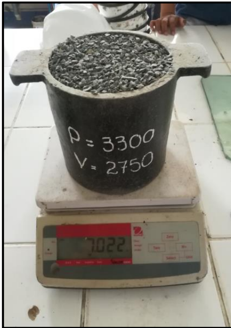
Figura 14. Pesado de molde más agregado grueso.
