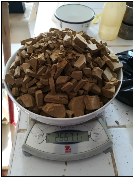
Figura 34. Arcilla triturada antes de calcinación.
