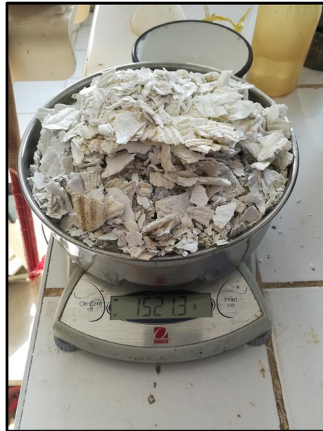
Figura 37. Concha de abanico calcinada
