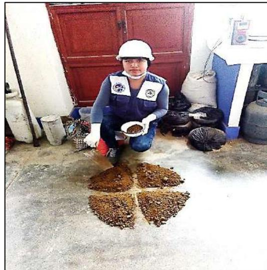
**Figura 56.** Cuarteo de las muestras alteradas para el ensayo de granulometría y contenido de humedad.
