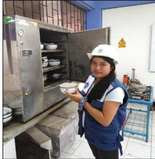
**Figura 59.** Secado de la muestra lavada en el horno durante 24 horas.
