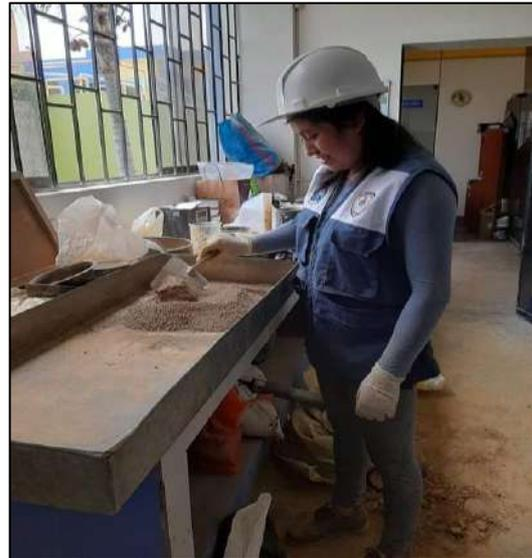
**Figura 79.** mezclado del suelo con las cenizas en estado seco.
