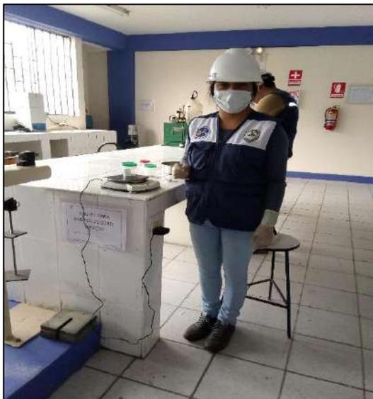
**Figura 70.** Pesado del material tamizado para el ensayo del ATD.
