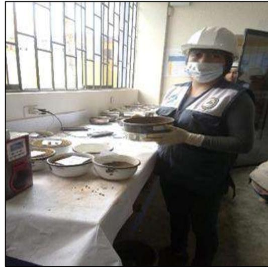
**Figura 63.** tamizado de la muestra por la malla #4 para el ensayo de límites de atterberg.
