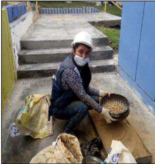
**Figura 73.** tamizado del material por la malla #4 para el ensayo de proctor modificado y CBR.
