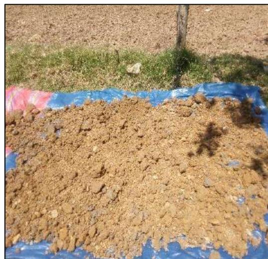
**Figura 48.** Secado de las muestras alteradas.
