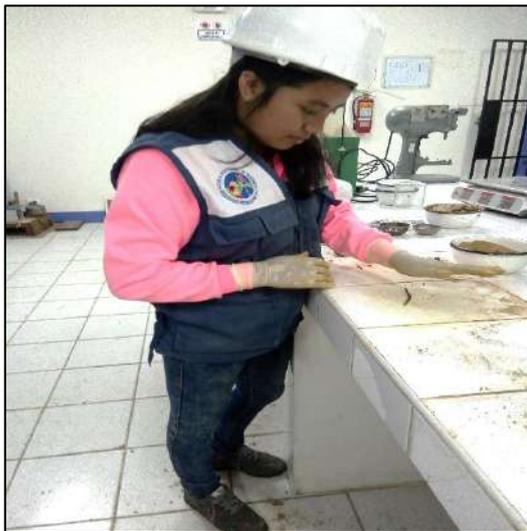
**Figura 66.** formación de la barra para el ensayo limite plástico
