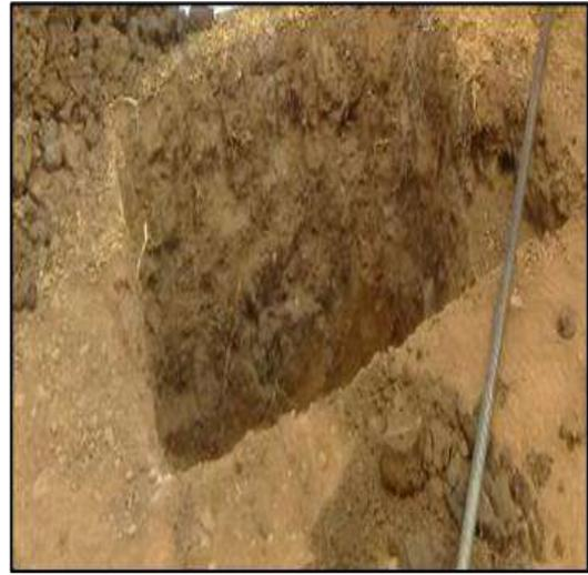
**Figura 43.** Visualización de las capas de la calicata 01.
