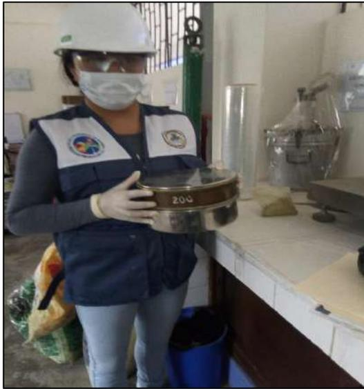
**Figura 69.** tamizado del material triturado por la malla #200 para el ensayo de ATD.
