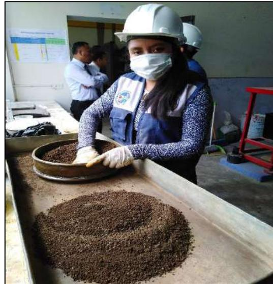
**Figura 75.** tamizado de la mezcla por la malla #4 para homogenizar el material.
