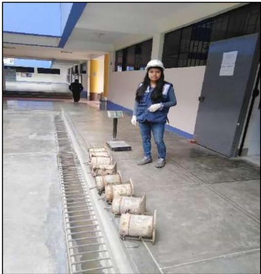
**Figura 82.** escurrimiento de las probetas durante 15 min. antes del ensayo de penetración.
