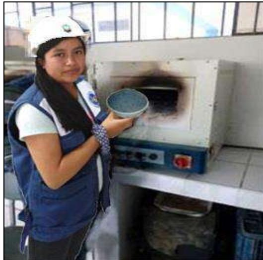
**Figura 52.** Calcinación de las hojas de pino precalcinadas en el horno a una temperatura de 410°C.
