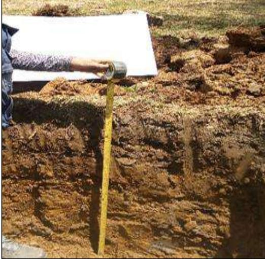
**Figura 45.** Visualización de las capas de la calicata 02.
