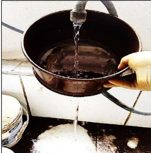
**Figura 58.** lavado de la muestra por la malla #200 para el ensayo de granulometría.
