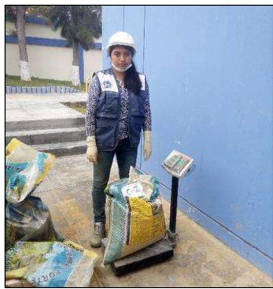
**Figura 72.** Pesado de la muestra total para el ensayo del proctor modificado y CBR.
