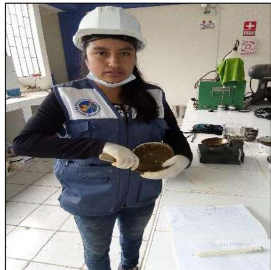
**Figura 64.** mezclado de la muestra con agua para el ensayo de limite líquido y limite plástico.
