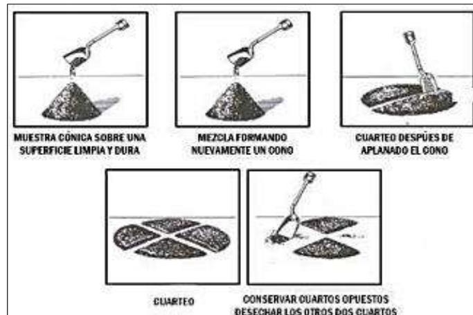
*Figura 5.* Proceso de cuarteo de las muestras alteradas. (Crespo, 2004)
