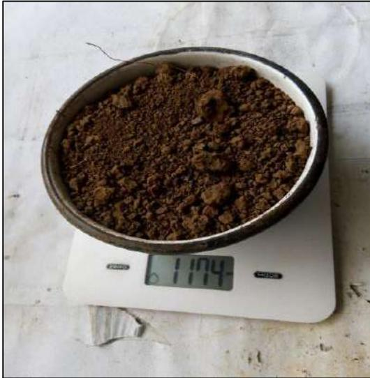
**Figura 57.** Pesado de las muestras para el ensayo de granulometría.
