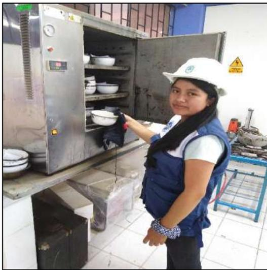
**Figura 62.** Sacado de la muestra después de 24 horas de secado para luego ser pesado en estado seco.
