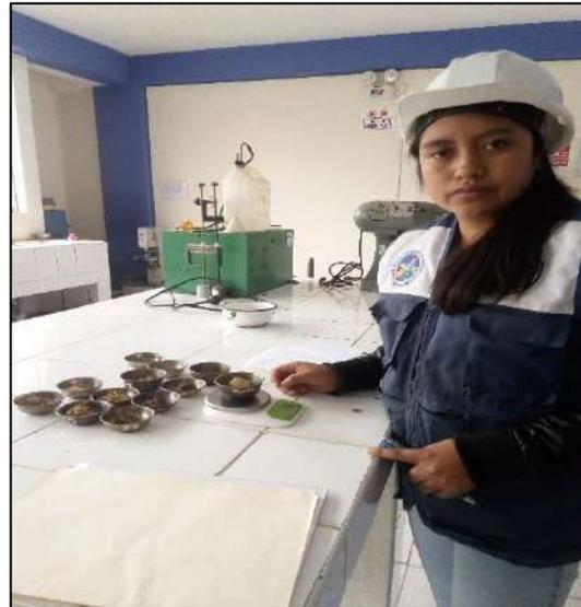
**Figura 67.** pesado de las muestras del límite líquido y plástico, antes y después del secado en el horno.
