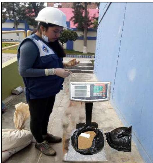
**Figura 74.** Pesado de la muestra para el ensayo de proctor modificado.
