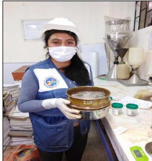
**Figura 71.** Tamizado de las cenizas por la malla #200 para el ensayo de Fluorescencia.
