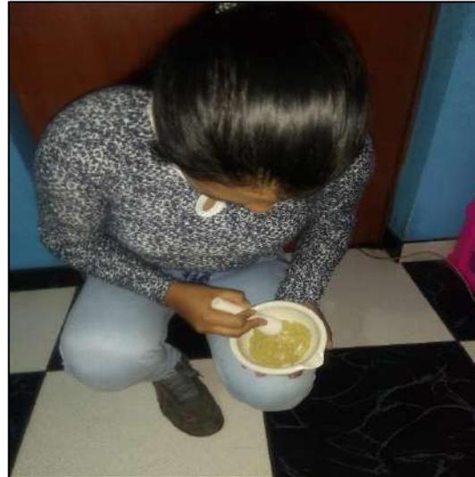
**Figura 68.** Trituración de los materiales para el ensayo del ATD.
