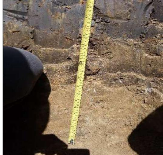
**Figura 47.** Visualización de las capas de la calicata 03.
