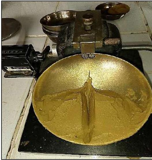
**Figura 65.** ensayo de limite liquido en la copa Casagrande.
