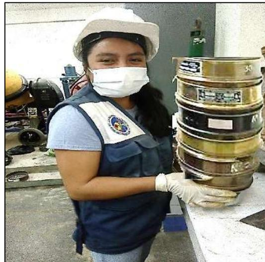
**Figura 60.** tamizado de la muestra en estado seco para el ensayo de granulometría.
