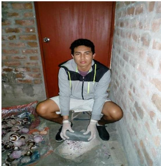
Figura 06: Pulverizamos las conchas de abanico con el batan
