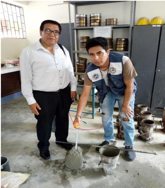
Figura 10: Slump patrón con el Ing. Cerna
