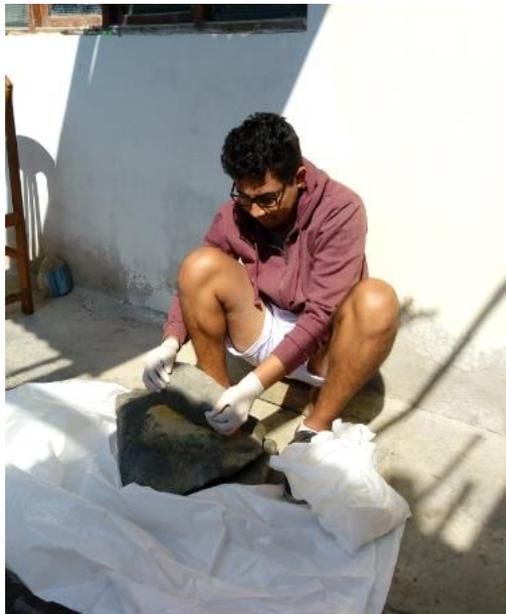
Figura 03: Pulverizar la paja de trigo con el batan
