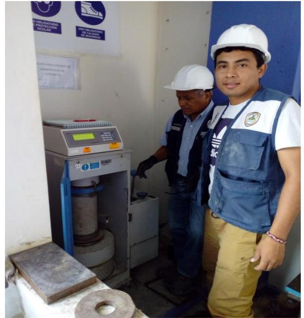
Figura 17: Ensayo de compresión a los 7, 14y 28 (Patrón)
