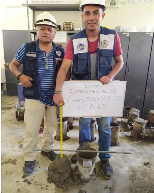
Figura 13: Slump Exp – 01 con el Ing. Montañez
