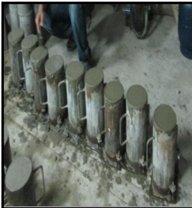
FIGURA N°37: PROBETAS D CONCRETO
