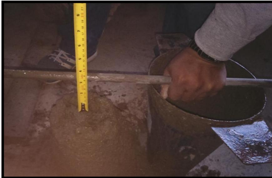
FIGURA N°36: ASENTAMIENTO DE 3.5 PULGADAS
