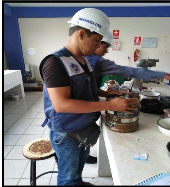
FIGURA N°26: ENSAYO DE GRANULOMETRIA
