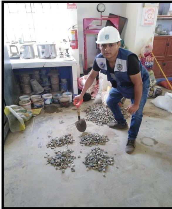
FIGURA N°24: SELECCION DE AGREGADO GRUESO PARA ENSAYO GRANULOMETRIA
