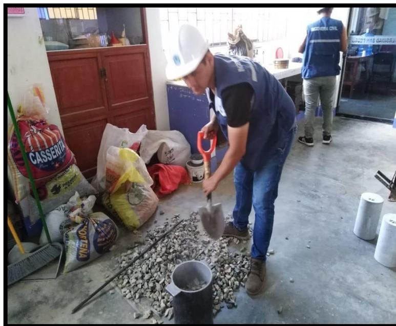
FIGURA N°23: ENSAYO DE PESO UNITARIO COMPACTADO
