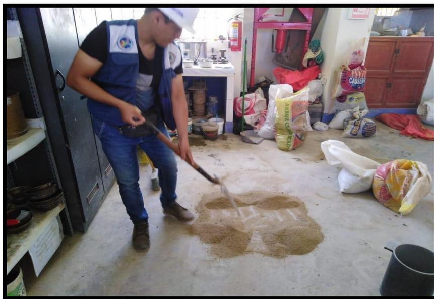
FIGURA N°25: SELECCION DE AGREGADO FINO PARA ENSAYO DE GRANULOMETRIA
