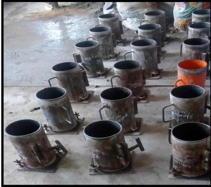
FIGURA N°32: LIMPIEZA DE MOLDES PARA ENSAYO DE PROBETAS
