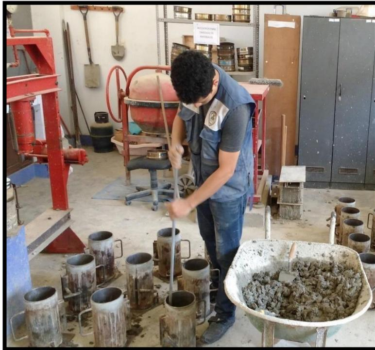
FIGURA N°34: ELABORACION DE PROBETAS
