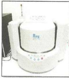
Figura 1. Espectrómetro de Fluorescencia de Rayos X
