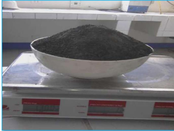
*Figura 52.* Pesando la Ceniza de Hoja de Pino pre quemada para luego ser calcinada.
