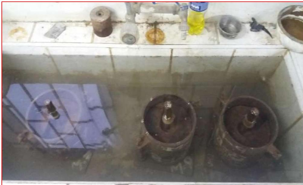
**Figura 61.** Realizando el curado de las probetas de cada punto para luego ser analizados.
