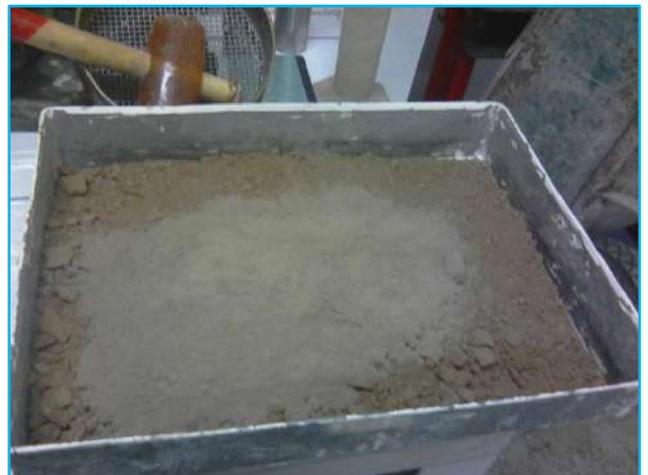
**Figura 50-51.** Vaciando la ceniza de hoja de pino calcinada pasada por la malla 200 para el ensayo de Proctor Modificado.
