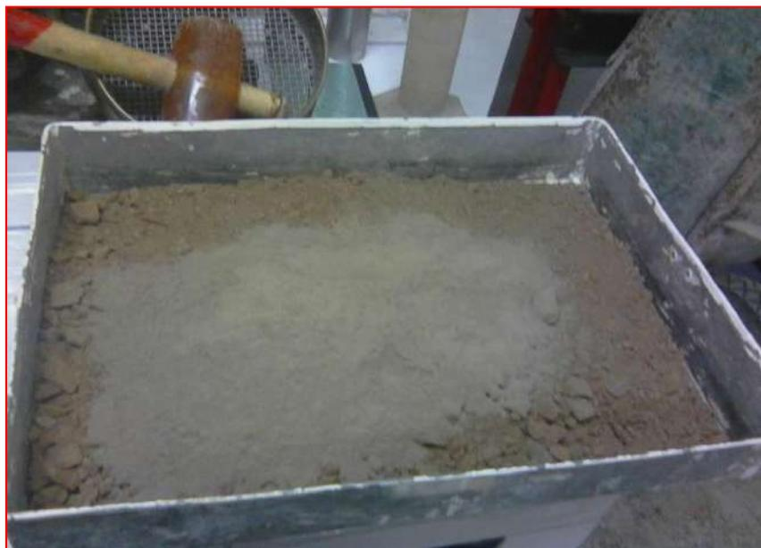
**Figura 55.** Afirmado natural adicionado 10% de Ceniza de Hoja de Pino para dicho Ensayo de CBR.
