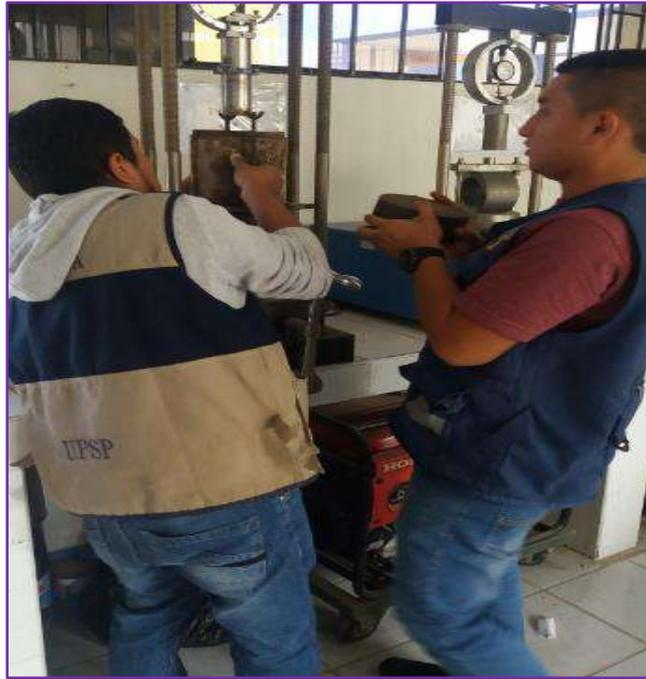
**Figura 46.** Realizando el ensayo de CBR-Patrón para cada punto y cada penetración a lado del técnico de laboratorio de suelos Johan Villena.
