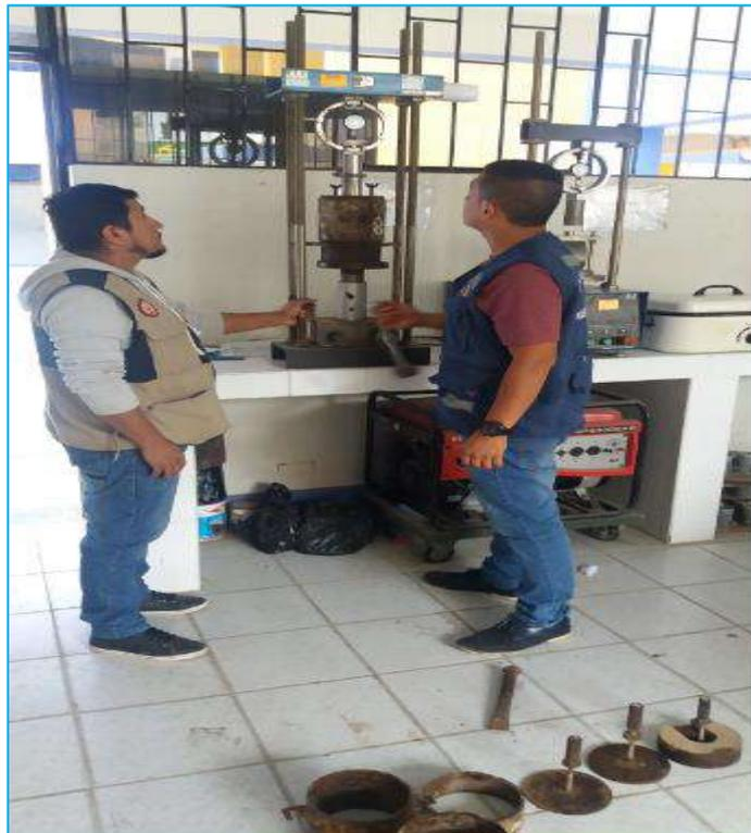
**Figura 47.** Realizando el ensayo de CBR-Patrón para cada punto y cada penetración a lado del Técnico Johan Villena.
