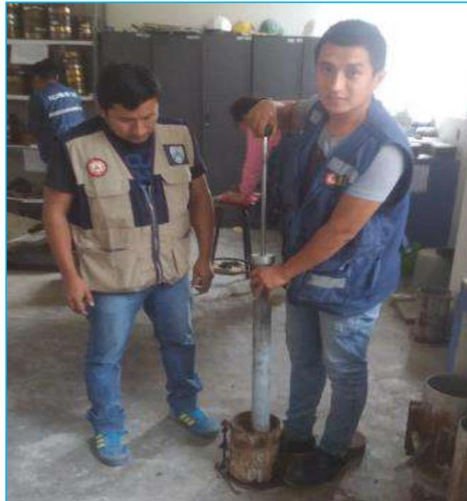
**Figura 49.** Compactando el segundo punto de 26 golpes con el Pistón a lado del supervisor Tec.Johan Villena
