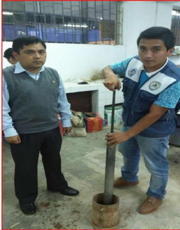
**Figura 48.** Compactando el primer punto de 12 golpes con el Pistón a lado del supervisor Ing.solar jara miguel.
