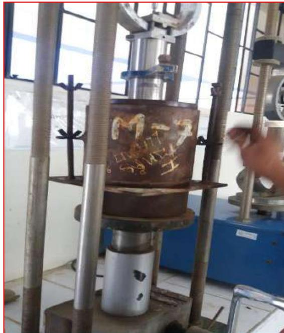
*Figura 43.* Ensayo de CBR Patrón con su respectivo molde espaciador.
