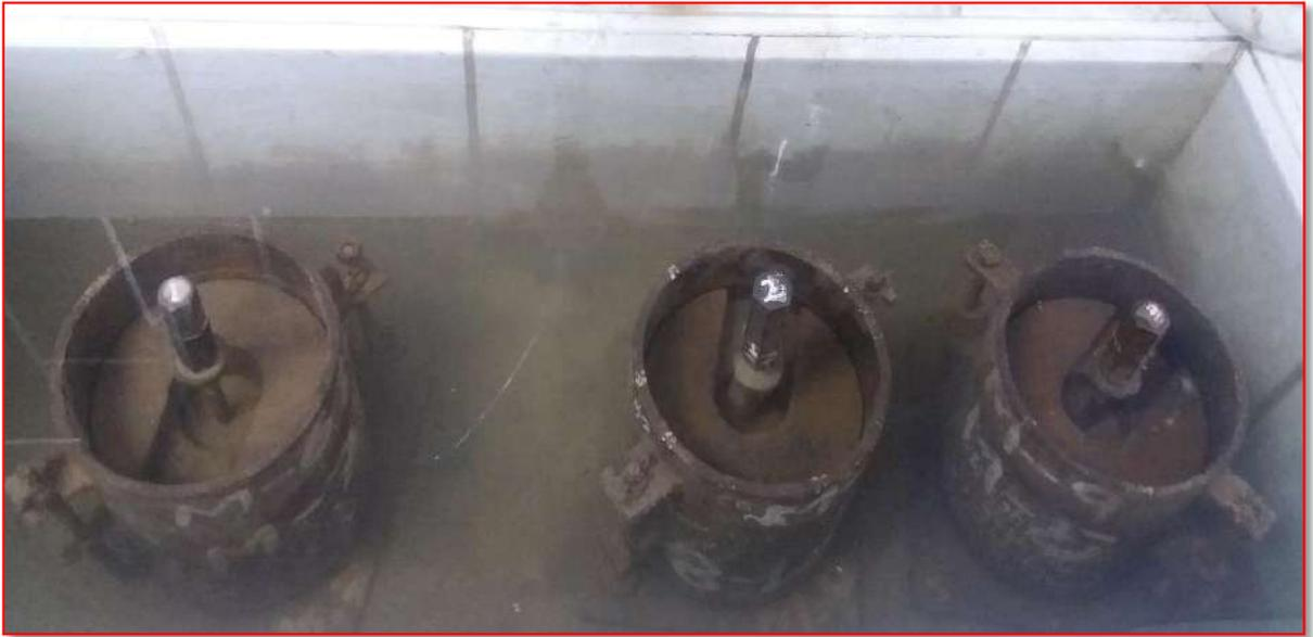
*Figura 40.* Curando las probetas patron sumergidos en agua por 96 horas para dicho ensayo a la penetración,
