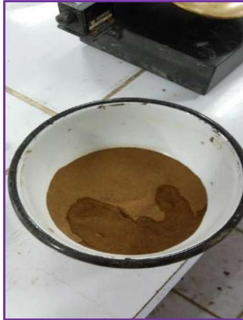
*Figura 41.* Realizando el Ensayo de Limite Plástico con el contenido de agua.
