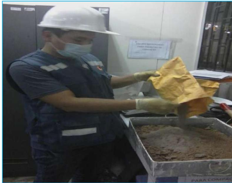
**Figura 54.** Adición de la ceniza de hoja de pino calcinada para dicho Ensayo de CBR – Experimental 10%.
