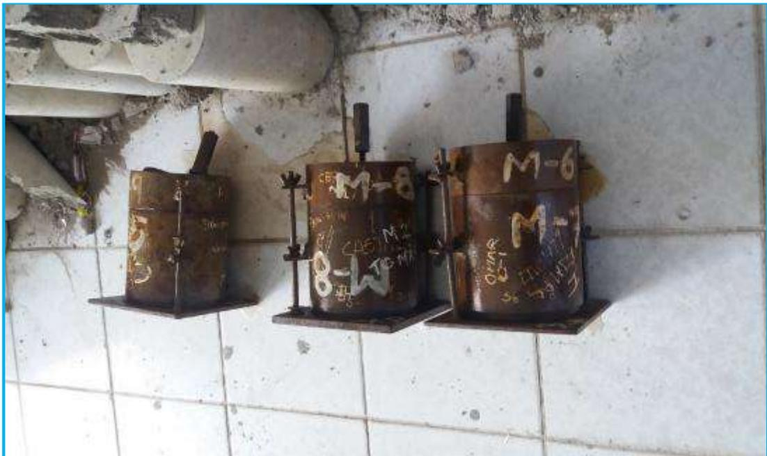
*Figura 41.* Secado de las probetas al aire libre para luego ensayarlos en el equipo de CBR.
