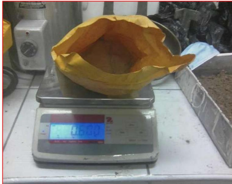
*Figura 53.* Pesando la Ceniza de Hoja de Pino calcinada para luego ser adicionada con el afirmado para dicho Ensayo Experimental 10%.
