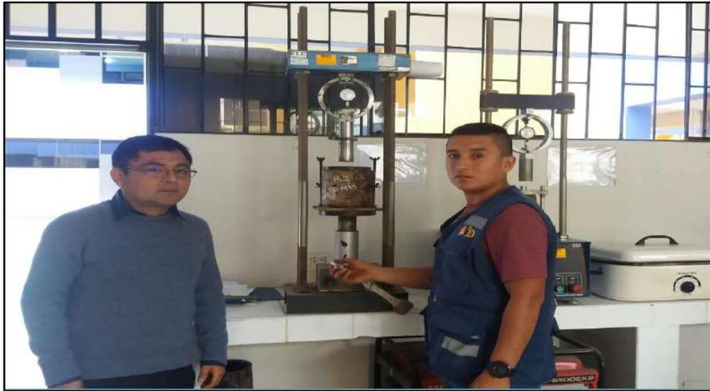
*Figura 44.* Realizando el ensayo de CBR-Patrón para cada punto y cada penetración a lado del Ing. Miguel Solar Jara.
