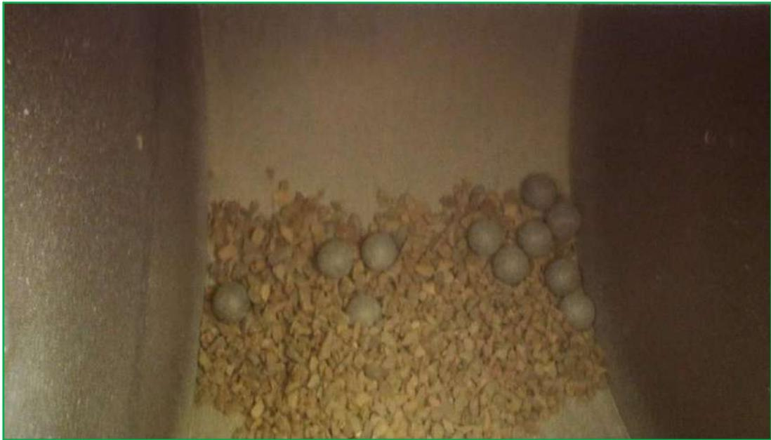
*Figura 40.* Realizando el Ensayo de Abrasión: 12 esferas para dicho ensayo
