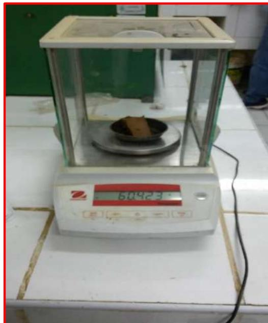
*Figura 42.* Obteniendo el peso Húmedo de la muestra.
