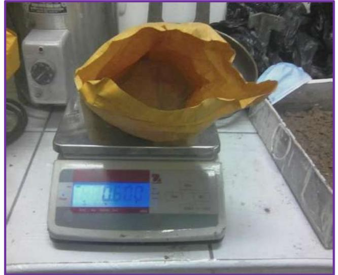
**Figura 48-49.** Afirmado de cada punto y pesado de 600gr la ceniza de hoja de pino para dicho ensayo de Proctor Modificado.
