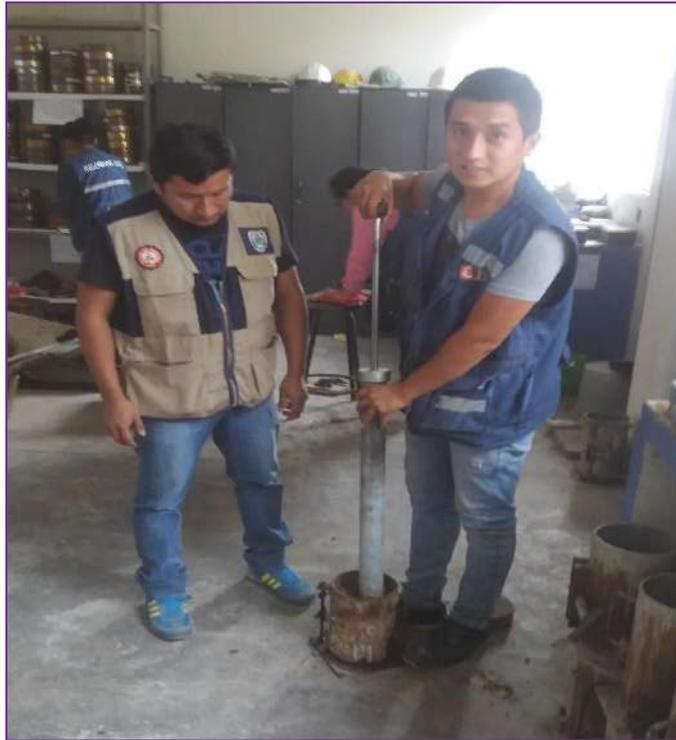
**Figura 56.** Ensayo de CBR – Experimental 10 %, con el Pistón realizamos la primera capa que es de 12 golpes según reglamento.
