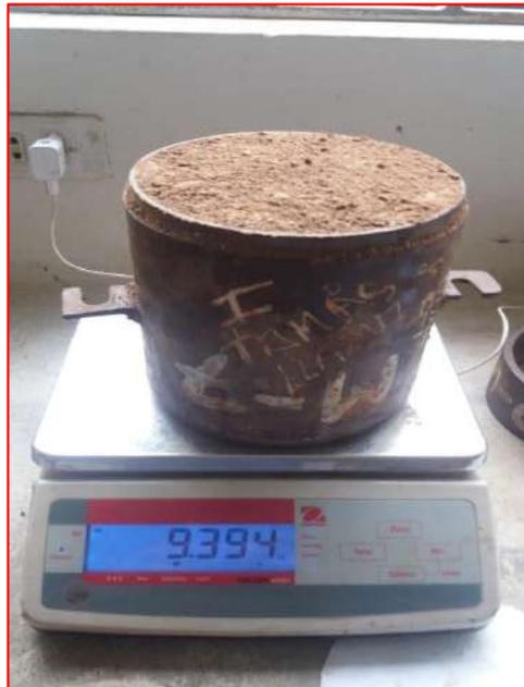
**Figura 57.** Pesado del molde para el cálculo de CBR – Experimental 10%.
