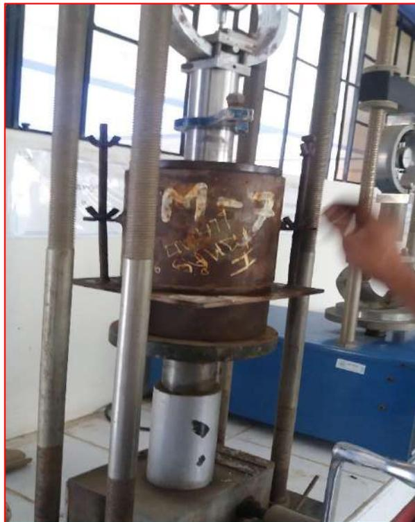
*Figura 59.* Realizando el Ensayo de Penetración para cada punto.
