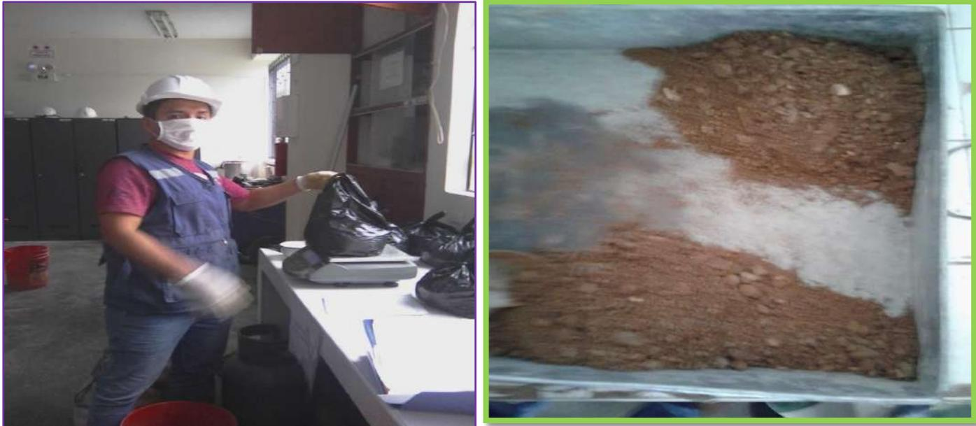
*Figura 43- 44.* Cuarteo y separación del afirmado en 5 capas para cada Compactación con el pison con 27 golpes
