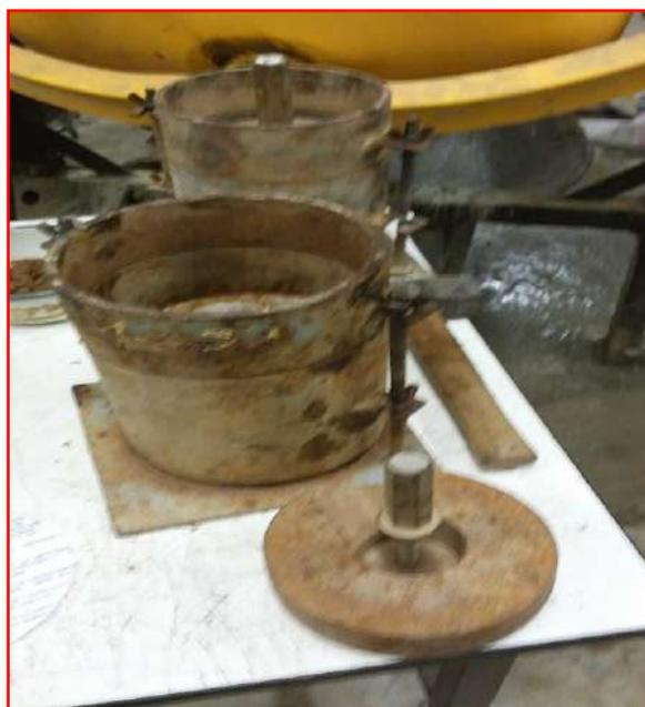
*Figura 46.* Equipos para realizar el ensayo de CBR.
