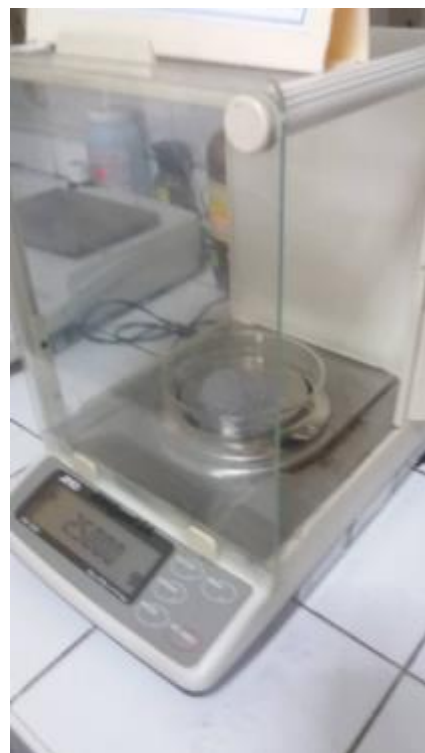
Figura 41: Pesando 2,0 gr de ceniza de cascarilla de arroz para la prueba de jarras
