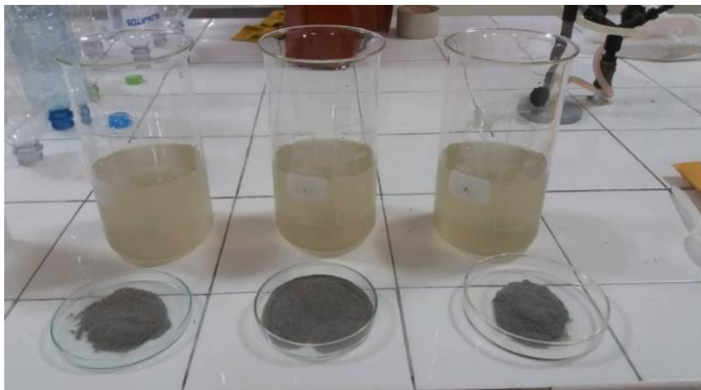
Figura 45 : Presentamos las dosis en gramos de las cenizas de cascarilla de arroz
