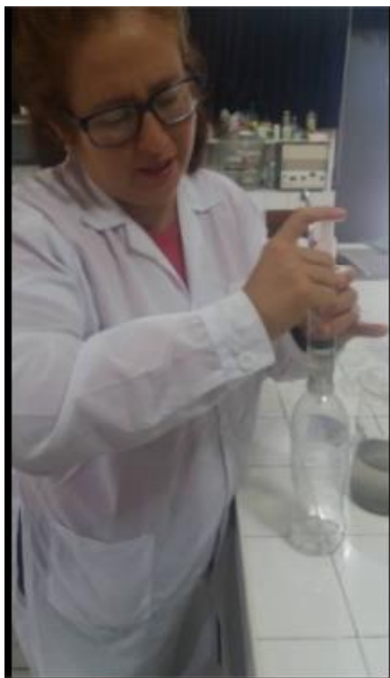
Figura 49: Extrayendo el agua después del ensayo de jarras para llevar al laboratorio certificado
