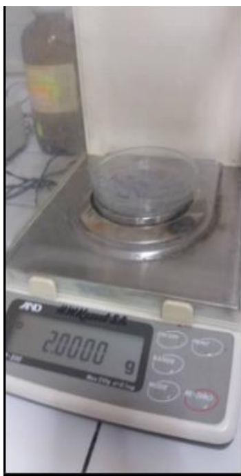
Figura 39: Pesando 2,5 gr de ceniza de cascarilla de arroz para la prueba de jarras
