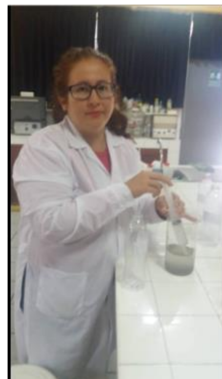
Figura 50: Extrayendo el agua después del ensayo de jarras para llevar al laboratorio certificado
