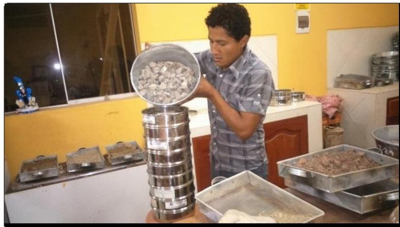
**Figura 7.-** Agregado grueso en proceso de tamiz
